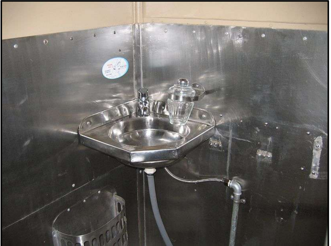
Interior do sanitário do carro Budd CA-560 em restauração nas Oficinas de Carlos Gomes.
