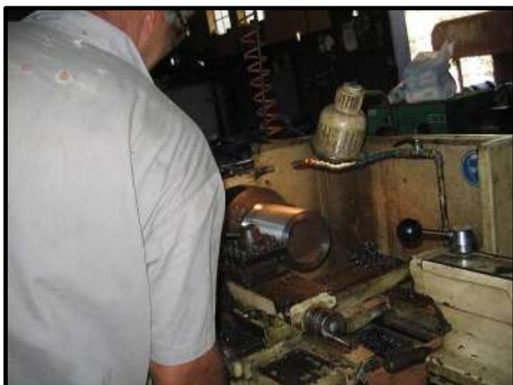
*À esquerda: usinagem de peça do condutor de vapor da locomotiva 338*
