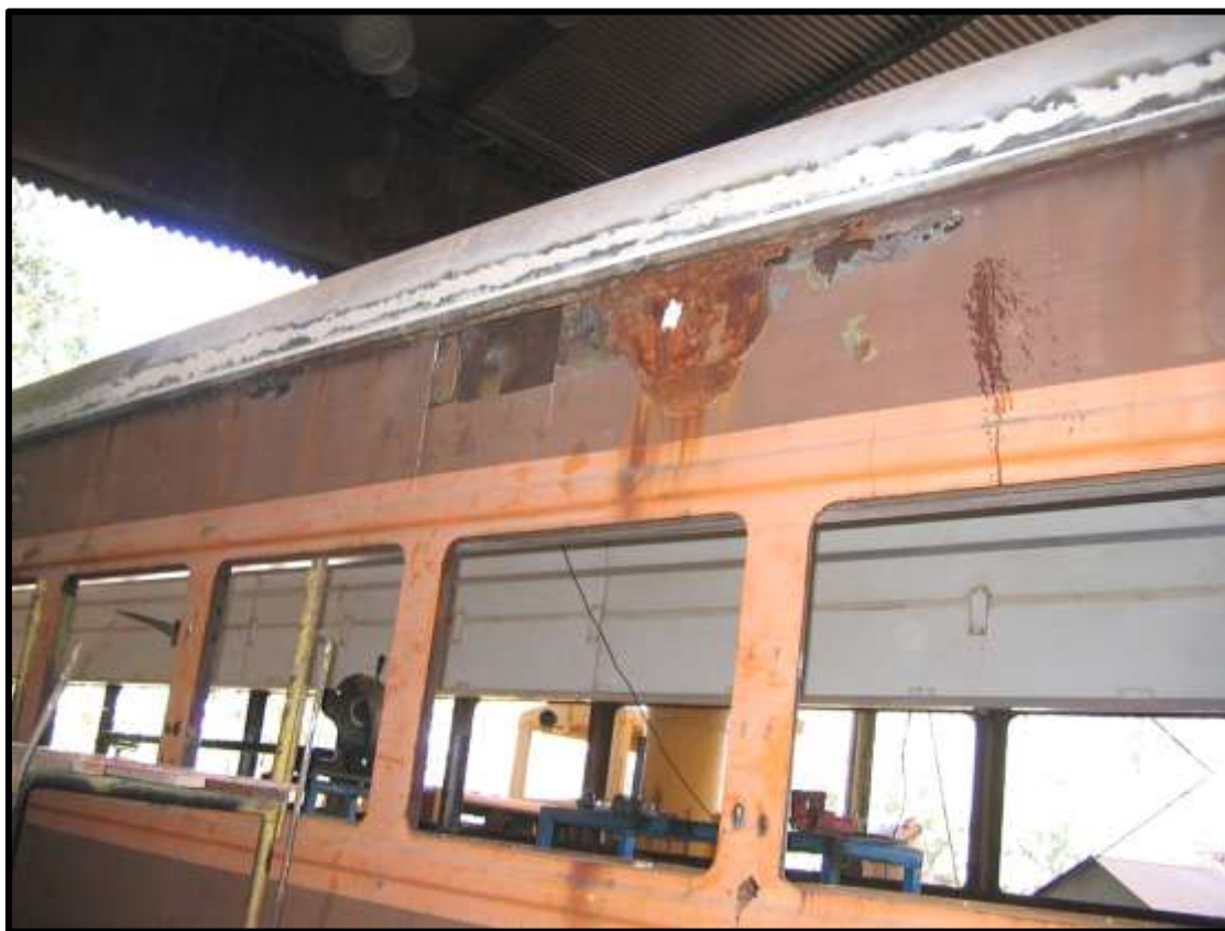
Reforma no teto do carro doado pela VALE-EFVM . Fotos: Hélio Gazetta Filho.
