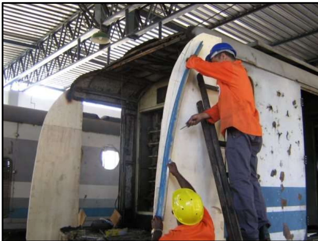
Construção da nova frente do carro motor.
