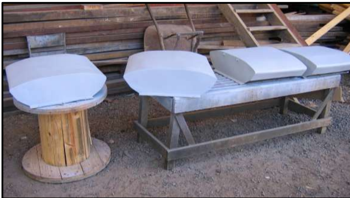
Coberturas das entradas de ar do teto do carro EFVM em recuperação nas Oficinas de Carlos Gomes. Foto: Hélio Gazetta Filho.
