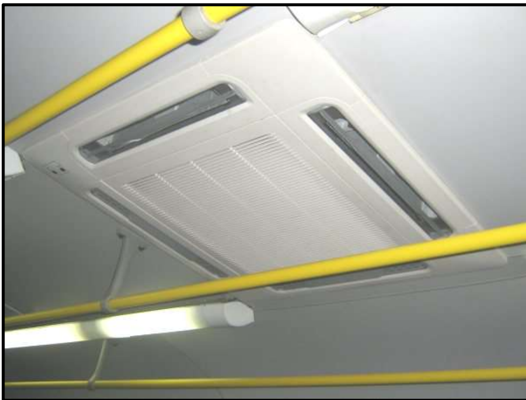
Acima: saída de ar do sistema de refrigeração do carro. Abaixo: painel do maquinista.
