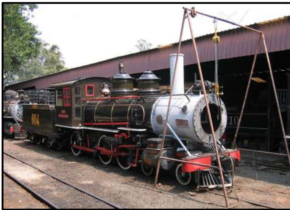
Acima: Locomotiva CPEF 604 recebendo o novo condutor de vapor. Abaixo: Carro Mogiana com sua varanda restaurada fielmente ao formato original. Fotos: Hélio Gazetta Filho em setembro de 2010.
