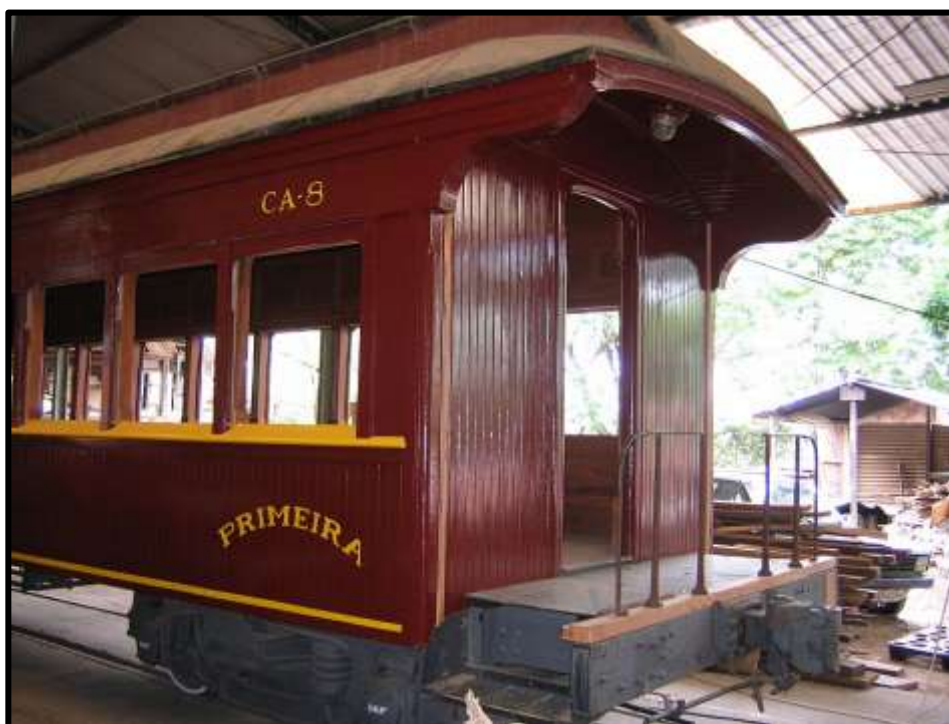
Acima: Locomotiva CPEF 604 recebendo o novo condutor de vapor. Abaixo: Carro Mogiana com sua varanda restaurada fielmente ao formato original. Fotos: Hélio Gazetta Filho em setembro de 2010.
