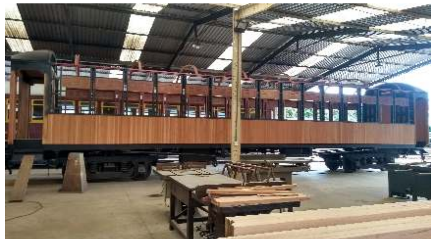
◆ Na marcenaria de São Lourenço são confeccionadas todas as novas peças de madeira e o carro vai sendo reconstruído.
