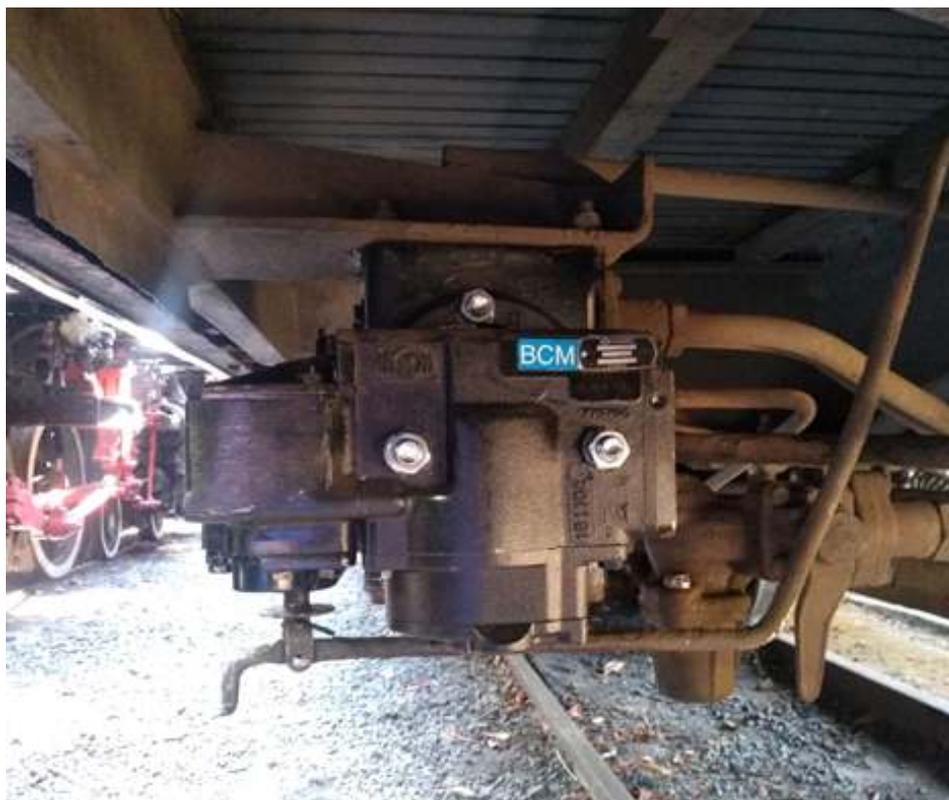
♦ Carro CA-45 com o novo conjunto de válvulas Knorr Bremse.
