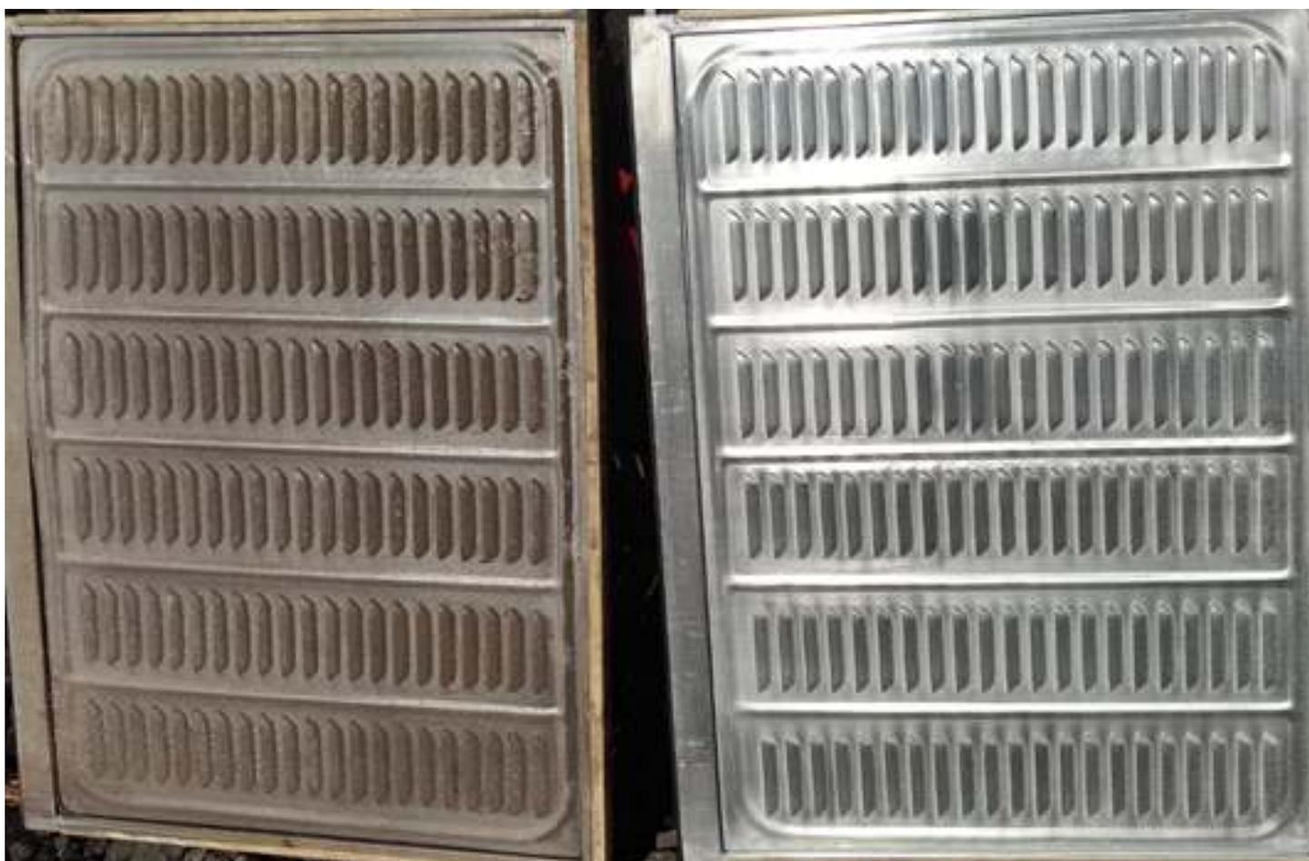
♦ Detalhe do antes e depois da decapagem com ácido específico.
