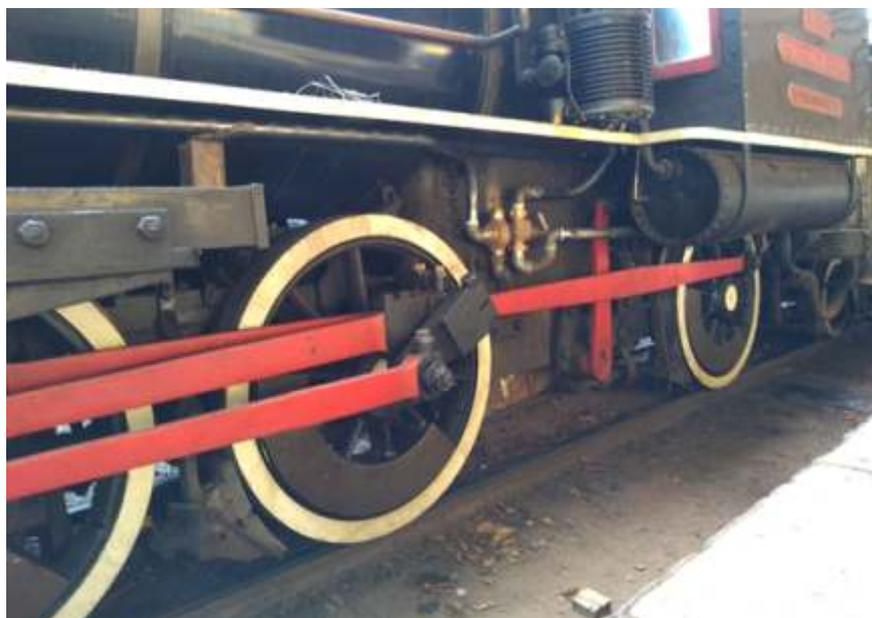
◆ Detalhe instalação de injetor novo locomotiva 604
