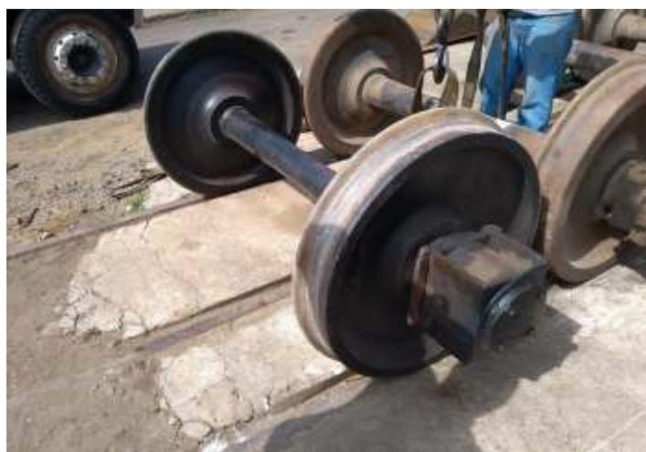
♦ Carro PC-926390-0F: novo equipamento de freio; truques removidos e rodeiros estão sendo retirados para ajuste de bitola e perfil conforme padrões vigentes.
