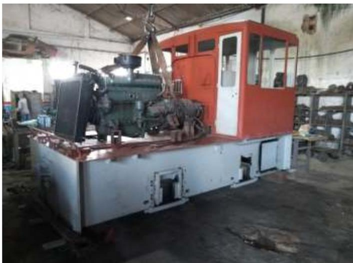
♦ A GE15ton recebendo o novo motor diesel.
