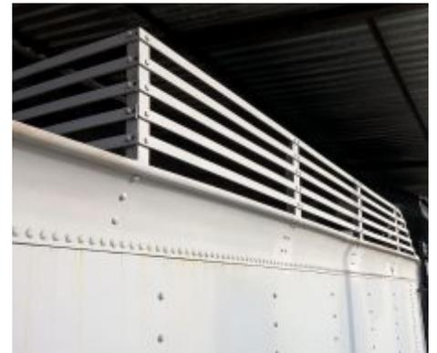
+ O gradio do tender já reparado e com pintura de fundo, pronto para pintura final
