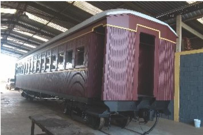
+ Aspecto externo do carro SD-02 em outubro de 2018: revestimento inteiramente novo, já com a pintura aplicada, janelas, vidros e pegas montados
