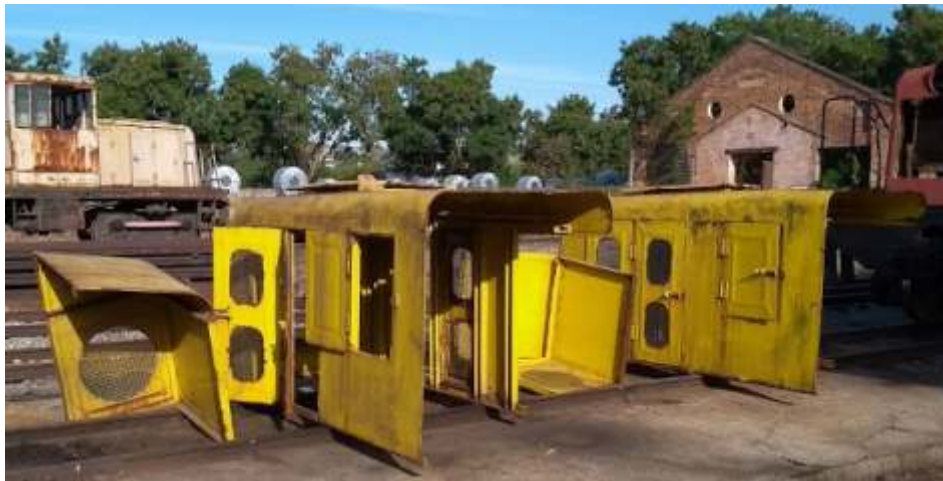
+ Os corpos da locomotiva foram removidos para facilitar os serviços.
