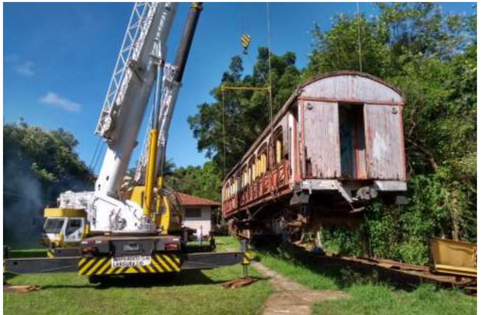
+ Operação de carregamento dos carros em Barra Bonita/SP: içamento com guindastes para colocação sobre carretas prancha para transporte via rodovia para São Lourenço/MG.
