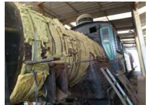
+ Novo revestimento térmico sendo instalado na caldeira da locomotiva.
