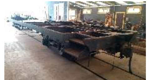
+ O estrado do carro SD-01 após a desmontagem completa da caixa de madeira
