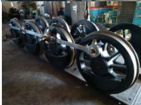
+ Novos aros para as rodas motrizes, buchas novas para as braçagens, reparos na caldeira, com substituição de trechos da chaparia do corpo cilíndrico.
