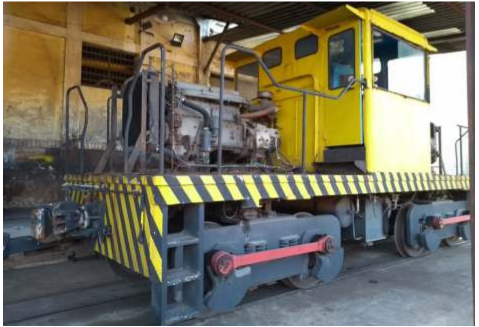
+ Locomotiva GE44Ton em reforma nas oficinas de Cruzeiro
