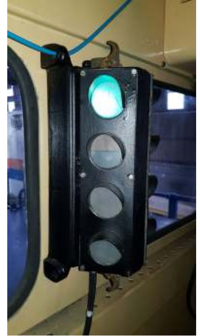
+ O velocímetro Hasler Bern RT9 e o Cab Signal recuperados e instalados na 7202
