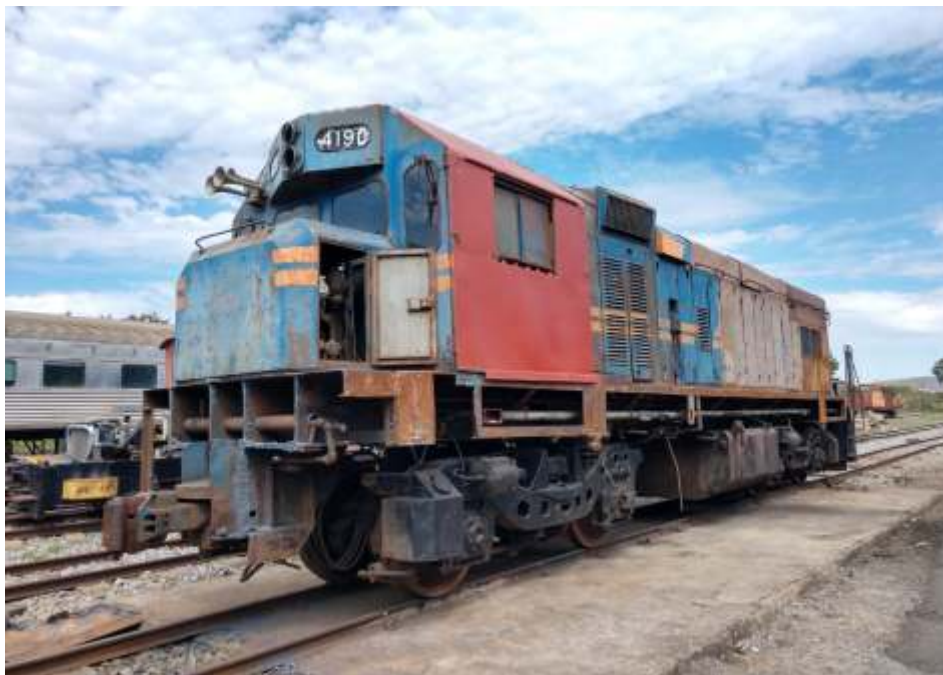
+ A 4190 sendo desmontada; muitas partes apodrecidas, amassadas, remendadas. Muita sujeira e problemas elétricos foram encontrados no processo de desmontagem.
