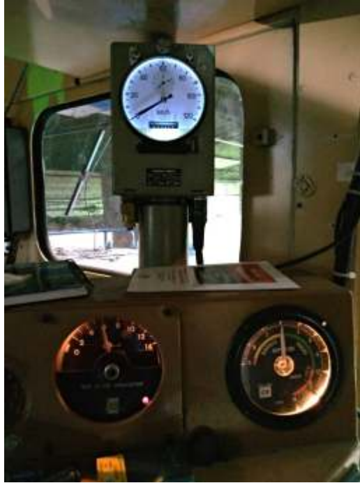
+ O velocímetro Hasler Bern RT9 e o Cab Signal recuperados e instalados na 7202
