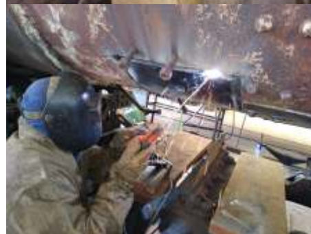
+ Novo revestimento térmico sendo instalado na caldeira da locomotiva.
