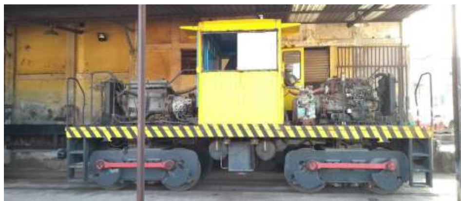
+ Os motores diesel também foram revisados, bem como o sistema de refrigeração e compressores de ar.
