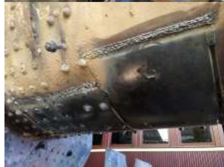
+ Novos aros para as rodas motrizes, buchas novas para as braçagens, reparos na caldeira, com substituição de trechos da chaparia do corpo cilíndrico.
