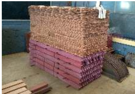
+ Algumas peças novas da estrutura do carro SD-01 confeccionadas com base nas antigas pela equipe da marcenaria de São Lourenço, prontas para serem instaladas
