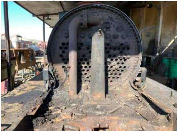
♦ Caixa de fumaça removida: notar a corrosão nos suportes e a grande quantidade de detritos
