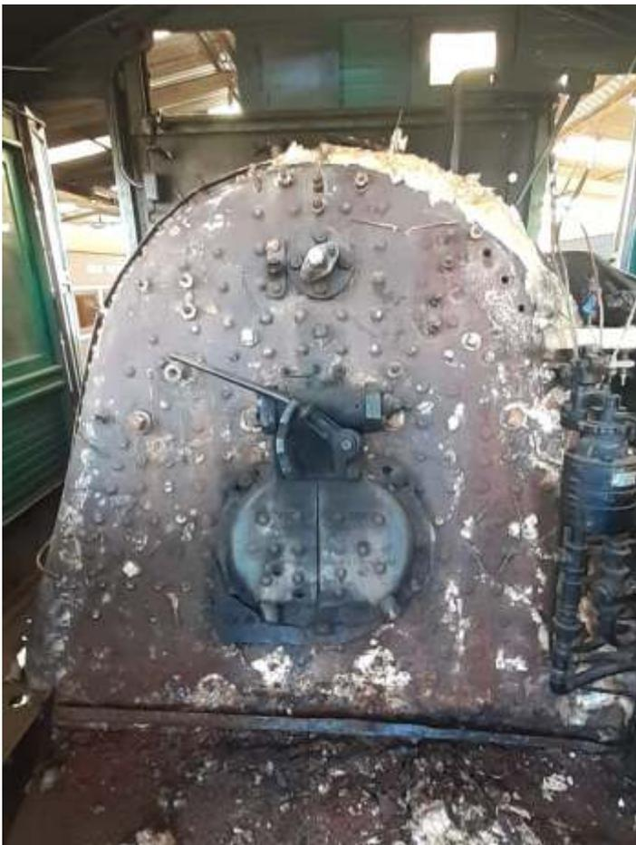
◆ Após a remoção de todo o instrumental, chaparia e revestimento térmico, a traseira da caldeira exposta
