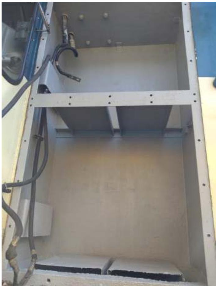
♦ Compartimento de baterias da locomotiva ALCO 905, já com nova pintura
