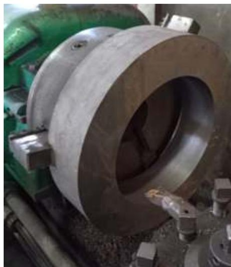
♦ Confeção dos anéis de cilindros para locomotiva 215
