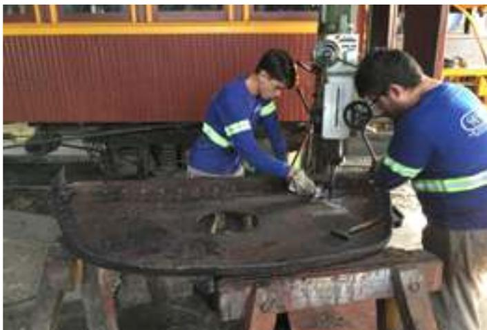
♦ *A Trabalhos de usinagem na formação dos furos dos estais da primeira peça interna da fornalha da 156*
