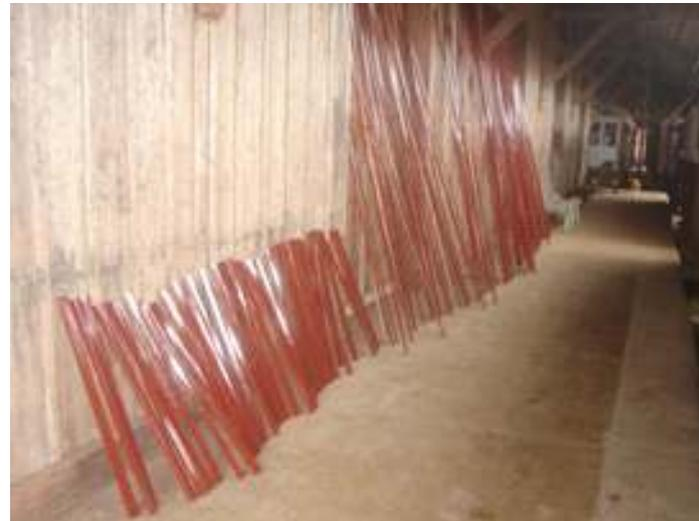
♦ Confeção das janelas já com a tinta fundo e o ripamento do carro passageiro já pintado e pronto para ser instalado
