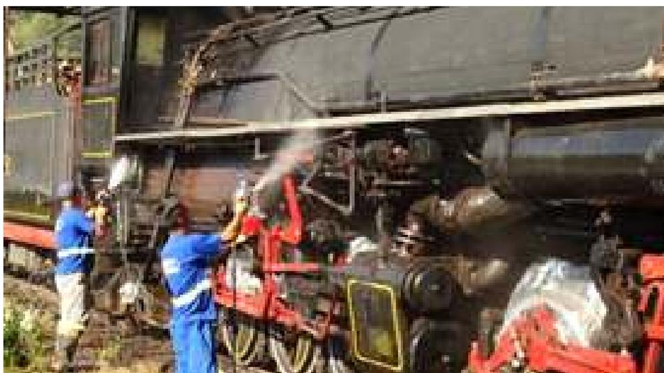
◆ Preparação da locomotiva Mallet com limpeza geral para receber nova pintura
