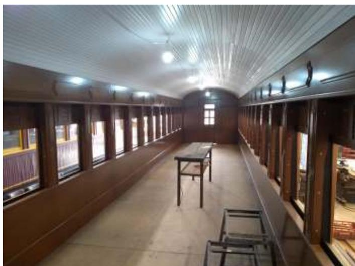
♦ *Instalação do novo revestimento interno em fase final; em seguida inicia-se a instalação do piso*
