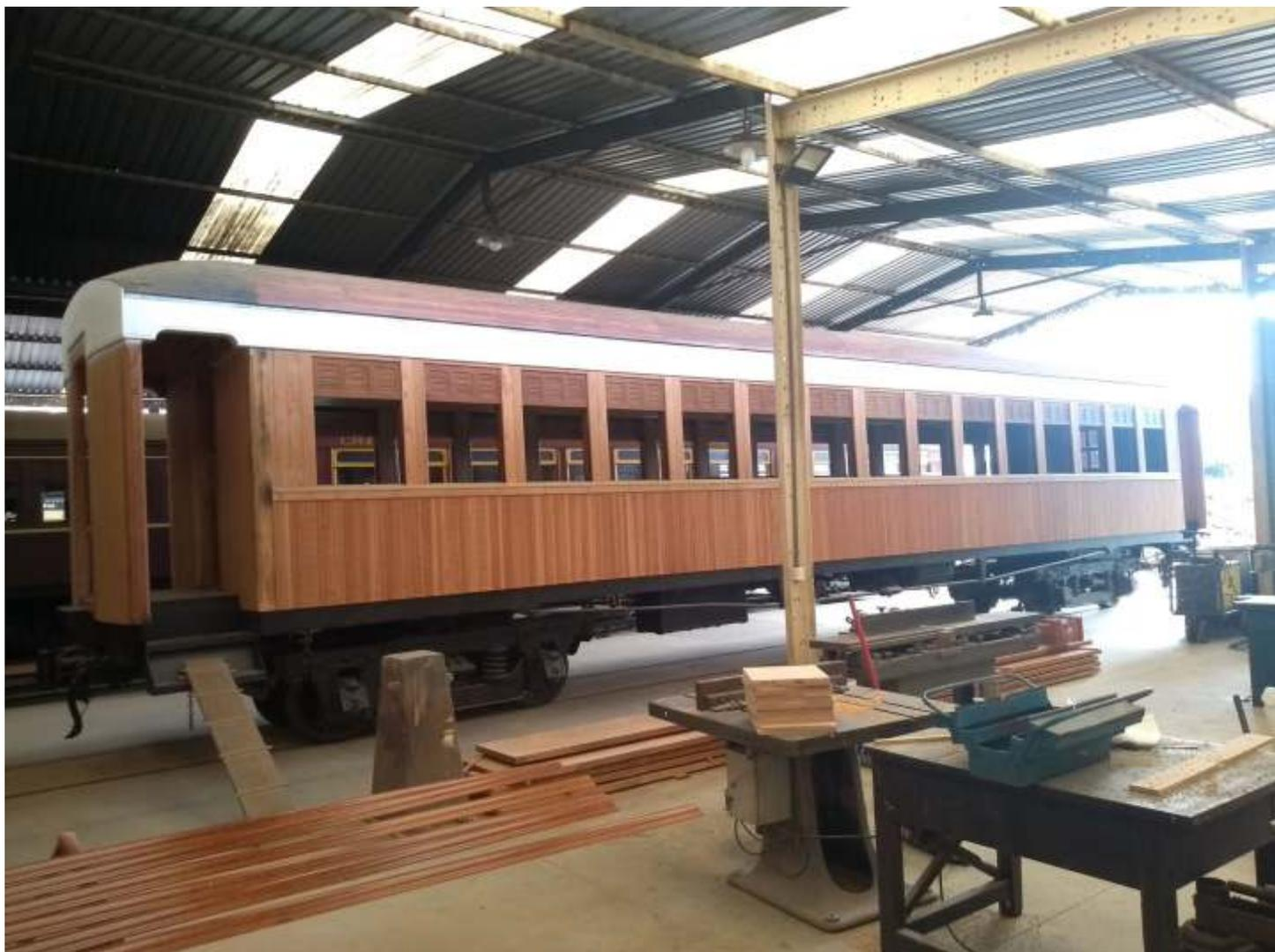
♦ *Aspecto do carro SD-01 na marcenaria: todo o novo revestimento externo foi instalado*
