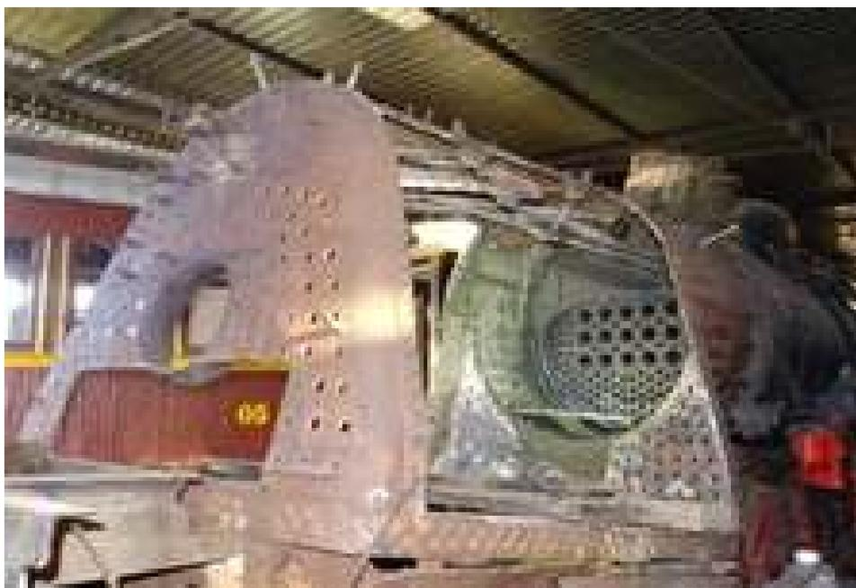
◆ Locomotiva Mikado nº 156 com todas as partes da fornalha que serão substituídas já removidas
