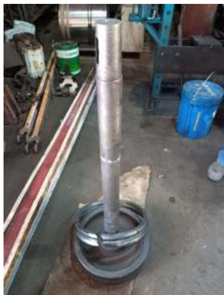
♦ Anéis já prontos para serem colocados no pistão e ser instalado
