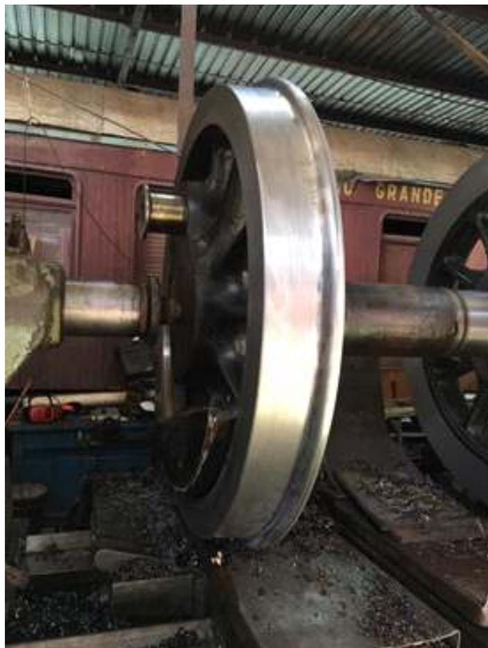
♦ Usinagem para formação do flange e o ângulo chanfrado na banda de rodagem conforme as especificações exigidas para a circulação nas linhas férreas
