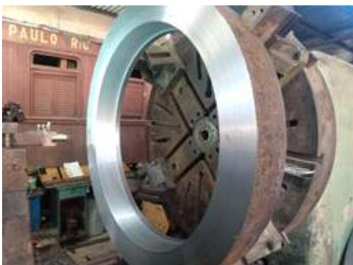
♦ *Início da usinagem para formação do resalto na parte interna*
