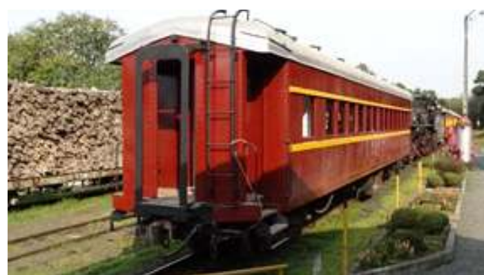
♦ Pintura das poltronas ainda em tinta fundo e pintura em amarelo das faixas externas no carro PC - 59
