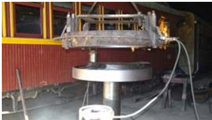
◆ Aquecimento a uma temperatura controlada para expandi-la e assim pressioná-la no aro
