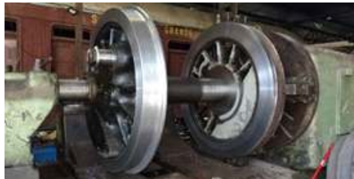
◆ Rodeiro já com as novas bandas de rodagem na última etapa onde ocorre a usinagem para formação do perfil da roda, formando o flange e o ângulo chanfrado
