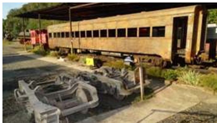
◆ Montagem do truque provisório e a retirada dos truques originais que serão recuperados do carro P-218
