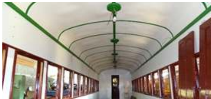
♦ Instalação do ripamento na junção das chapas na face de acabamento da restauração do carro PC -59
