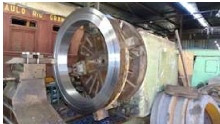
◆ Nova banda de rodagem sendo usinada para formar o ressalto na parte interna
