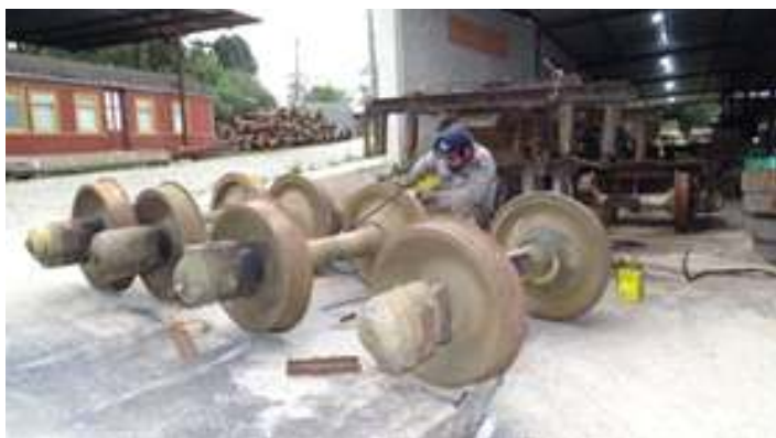
◆ Montagem do truque provisório e a retirada dos truques originais que serão recuperados do carro P-218
