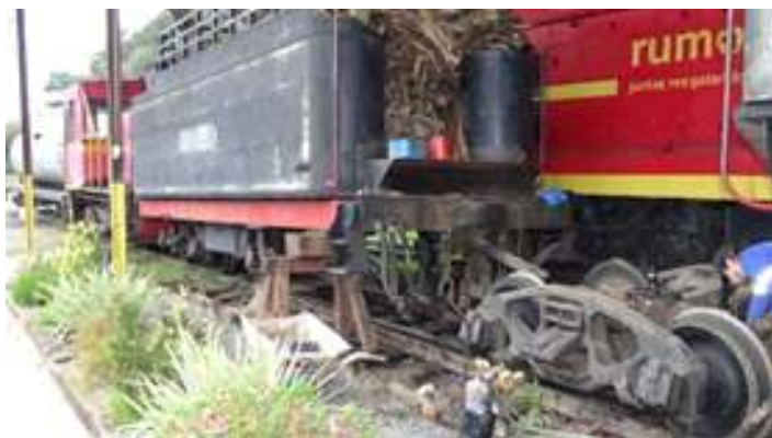
◆ Revisão geral nos truques do tender e a preparação para receber a nova pintura da locomotiva Mallet nº 204
