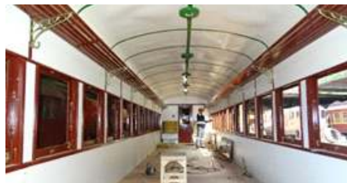
♦ Limpeza dos suportes e instalação dos maleiros no carro PC – 59
