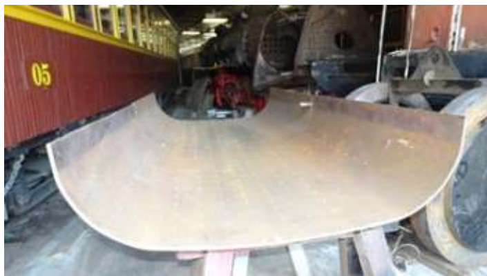
◆ Peça do teto da fornalha da 156 já calandrada
