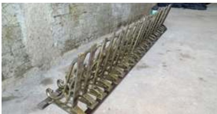
♦ Limpeza dos suportes e instalação dos maleiros no carro PC – 59
