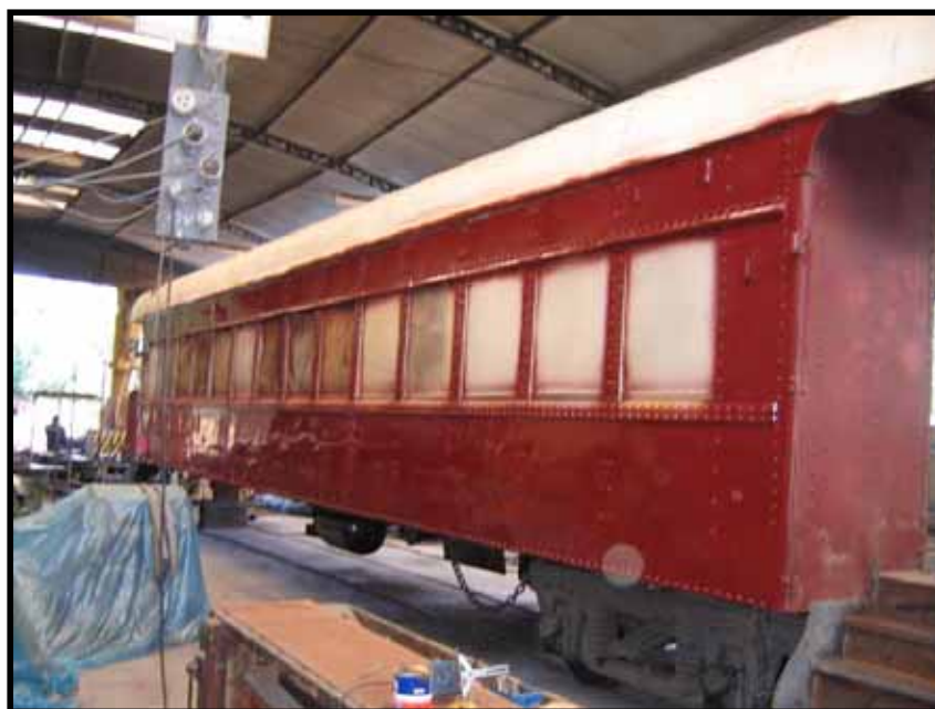
Carro em aço-carbono da SPP, fabricado pela Gregg, recebendo nova pintura nas Oficinas de Carlos Gomes. Foto: Helio Gazetta Filho em fevereiro de 2008.
