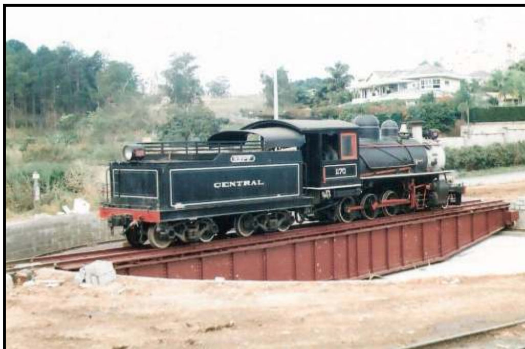
Locomotiva 1170 testando pela primeira vez o girador de locomotivas instalado na estação de Anhumas. Foto: Vanderlei Zago em agosto de 2008.
