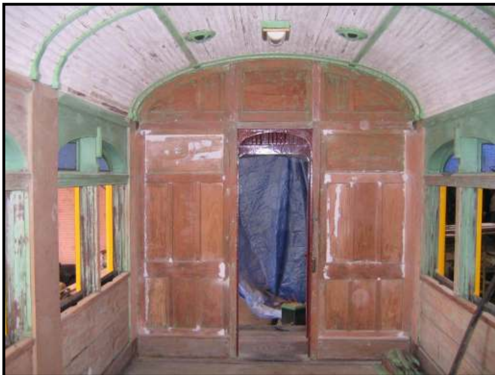
Interior do carro CA-36 sendo raspado para aplicação de nova pintura. Fotos: Helio Gazetta Filho em setembro de 2008.
