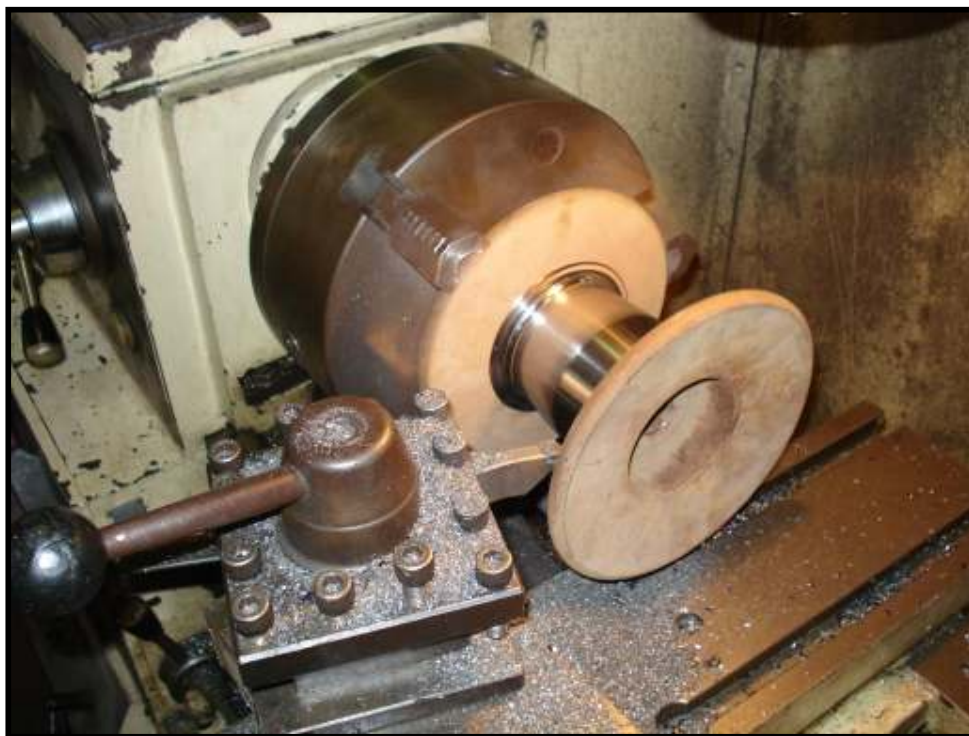
Acima: Polia do gerador de carro de passageiro sendo usinada nas Oficinas de Carlos Gomes. Abaixo: Sapatas de Freio adquiridas pela ABPF-Campinas. Fotos: Helio Gazetta Filho em setembro de 2008.
