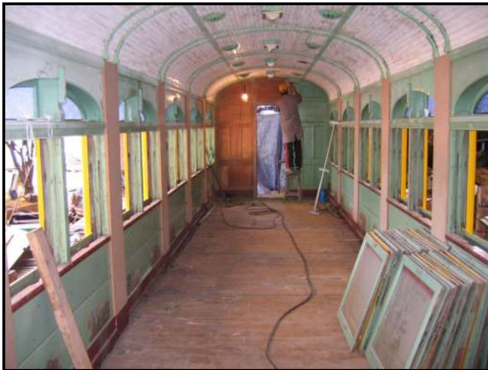
Interior do carro CA-36 sendo raspado para aplicação de nova pintura. Fotos: Helio Gazetta Filho em setembro de 2008.
