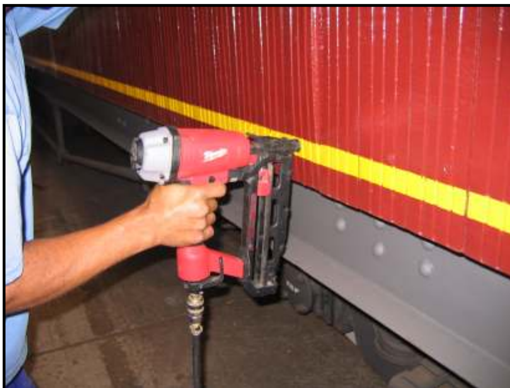
Pregadeira pneumática em ação nas Oficinas de Carlos Gomes. Foto: Hélio Gazetta Filho.
