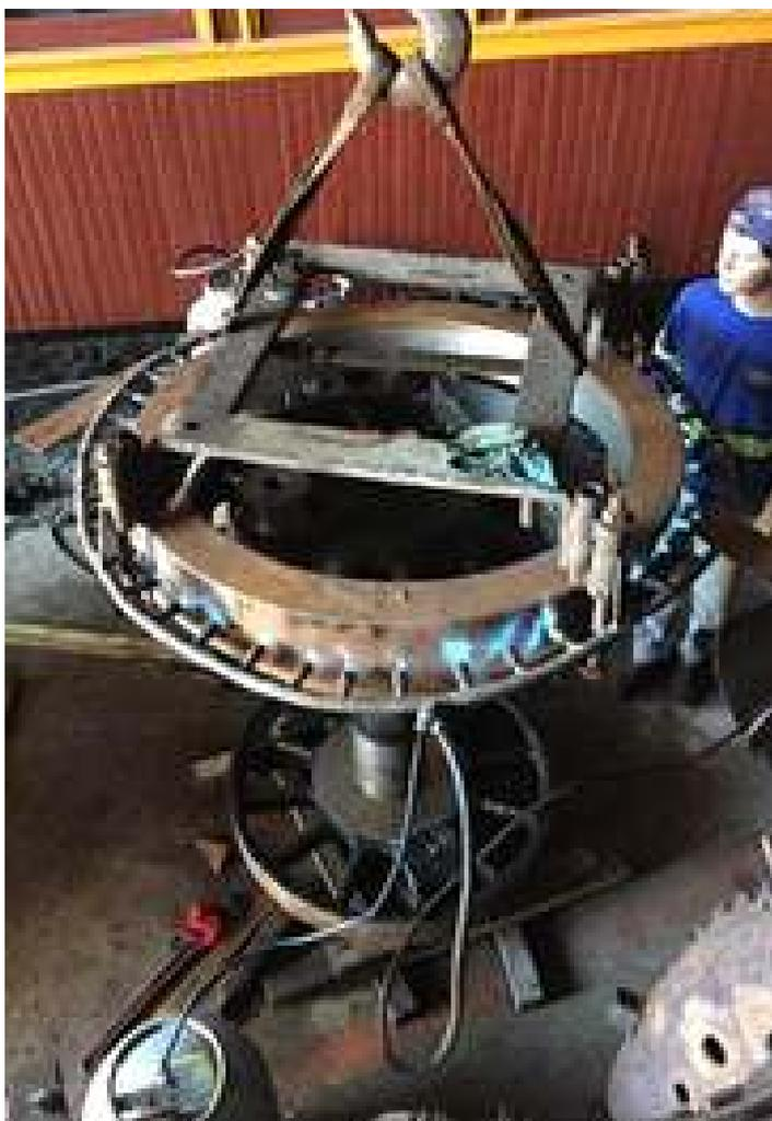
♦ Expansão da banda de rodagem na montagem com o aro
