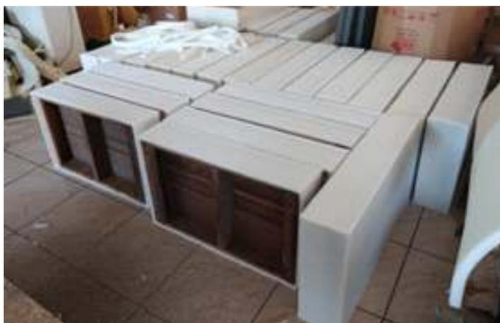
◆ Montagem do estofamento com a colocação da espuma do carro passageiro PC - 59
