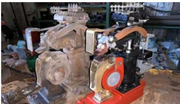
♦ Comparativo: uma contadora no estado que saiu da locomotiva e uma já revisada e pronta para ser instalada
