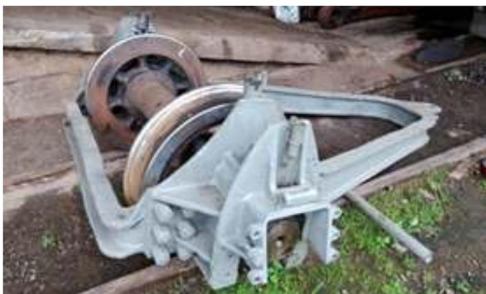
♦ Sistema da guia traseira sendo revisado e agora com novo sistema de lubrificação
