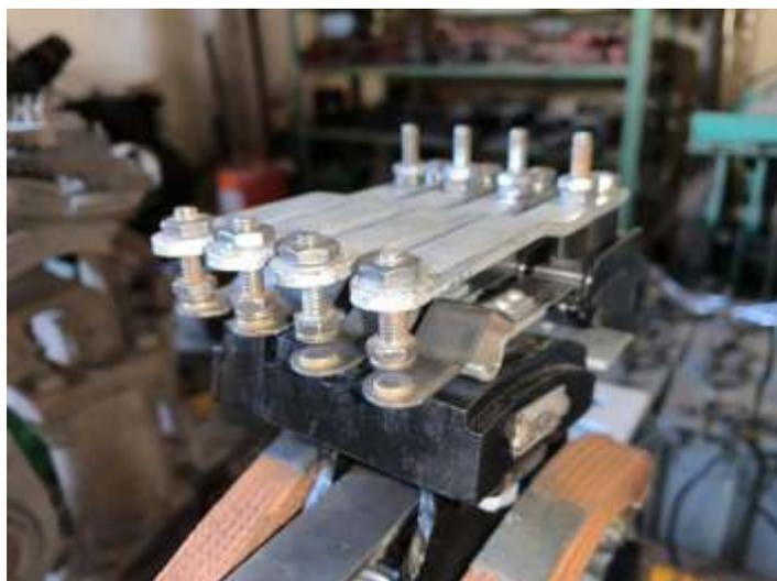
♦ Detalhe dos contatos de acionamento no topo da contadora: antes e depois da revisão
