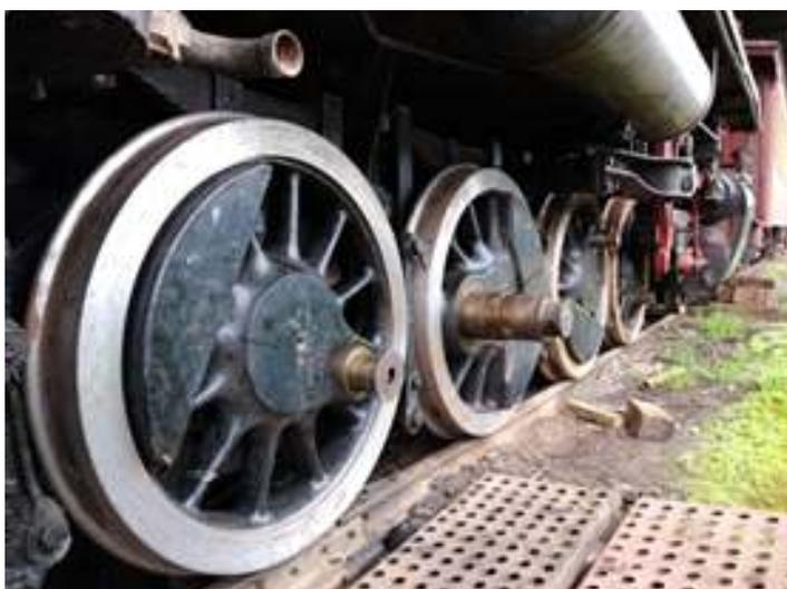
♦ Locomotiva Mikado n° 760 já com todas as rodas motrizes montadas e com as novas bandas de rodagem
