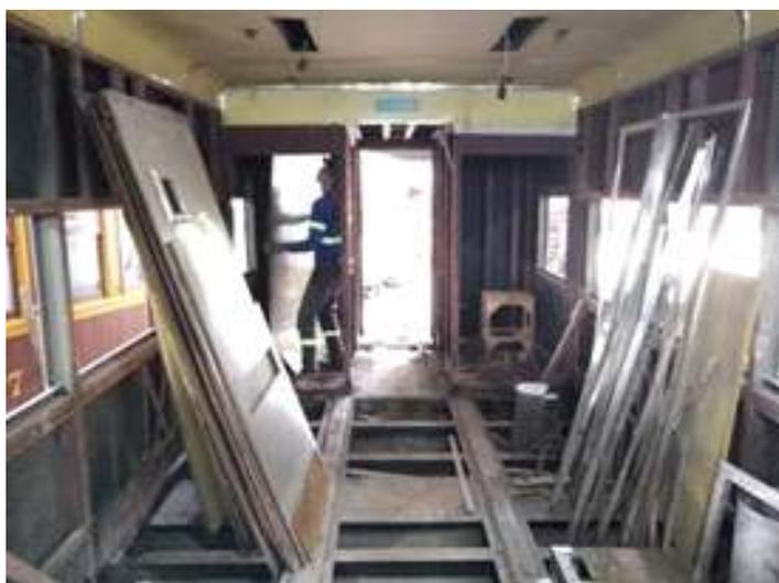
◆ Aspecto do interior do carro passageiro P-218 com a retirada da parede dos banheiros e da limpeza
