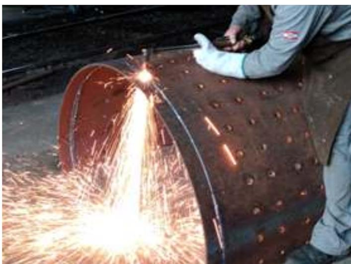
◆ Trabalhos na preparação da chapa que formará a conduta interna da fornalha
