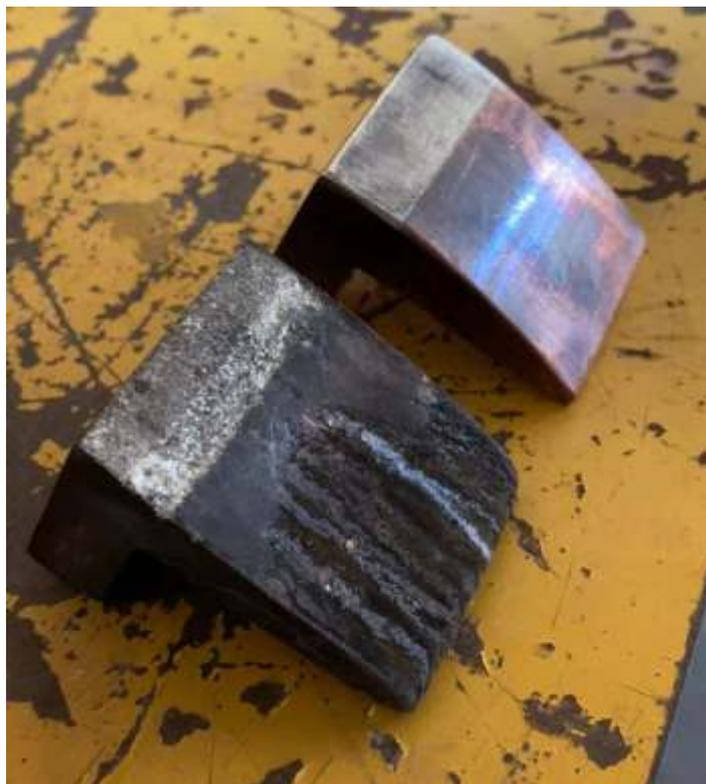
♦ Uma amostra de um contato de "prata" desgastado pelo uso na locomotiva e logo atrás um novinho para substituição
