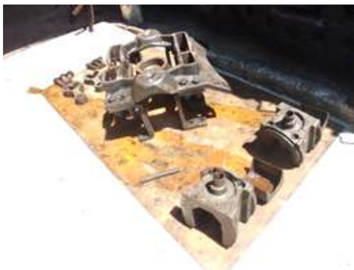
♦ Instalação do conjunto da roda guia traseira e conjunto da roda guia dianteira da locomotiva nº 760
