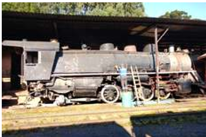
♦ Raspagem e retirada das camadas de tinta nos trabalhos de funilaria na locomotiva Mikado nº 760
