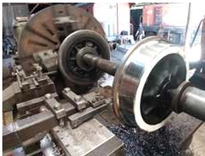
♦ Pinos, buchas e rodeiro da guia dianteira da locomotiva Mikado nº 760 sendo usinados
