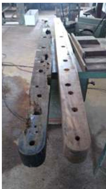
♦ Novas peças em madeira estão sendo confeccionadas para as plataformas dos carros passageiros
