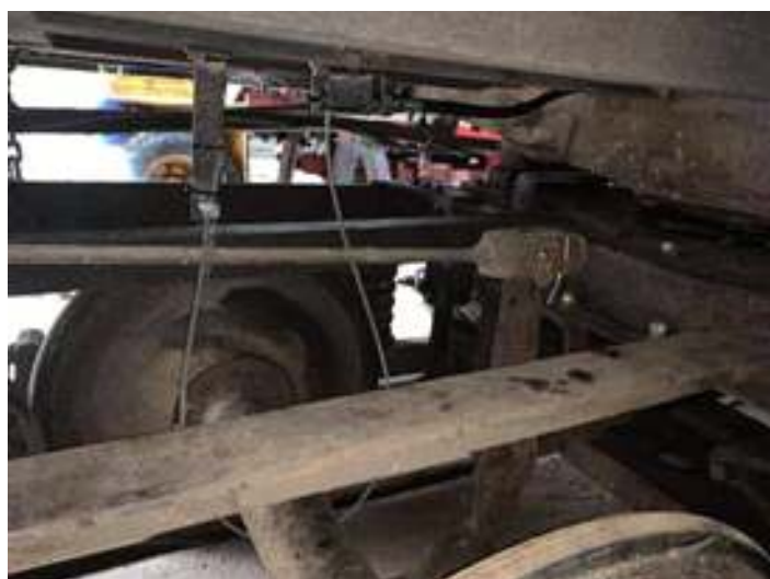
♦ Instalação do DDV (detector de descarrilamento de vagões)
