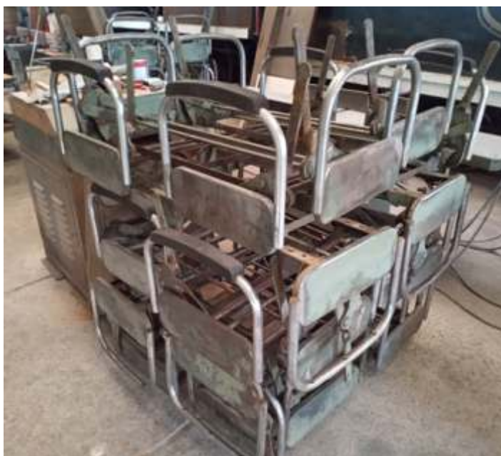
♦ Estruturas dos bancos já preparadas para pintura
