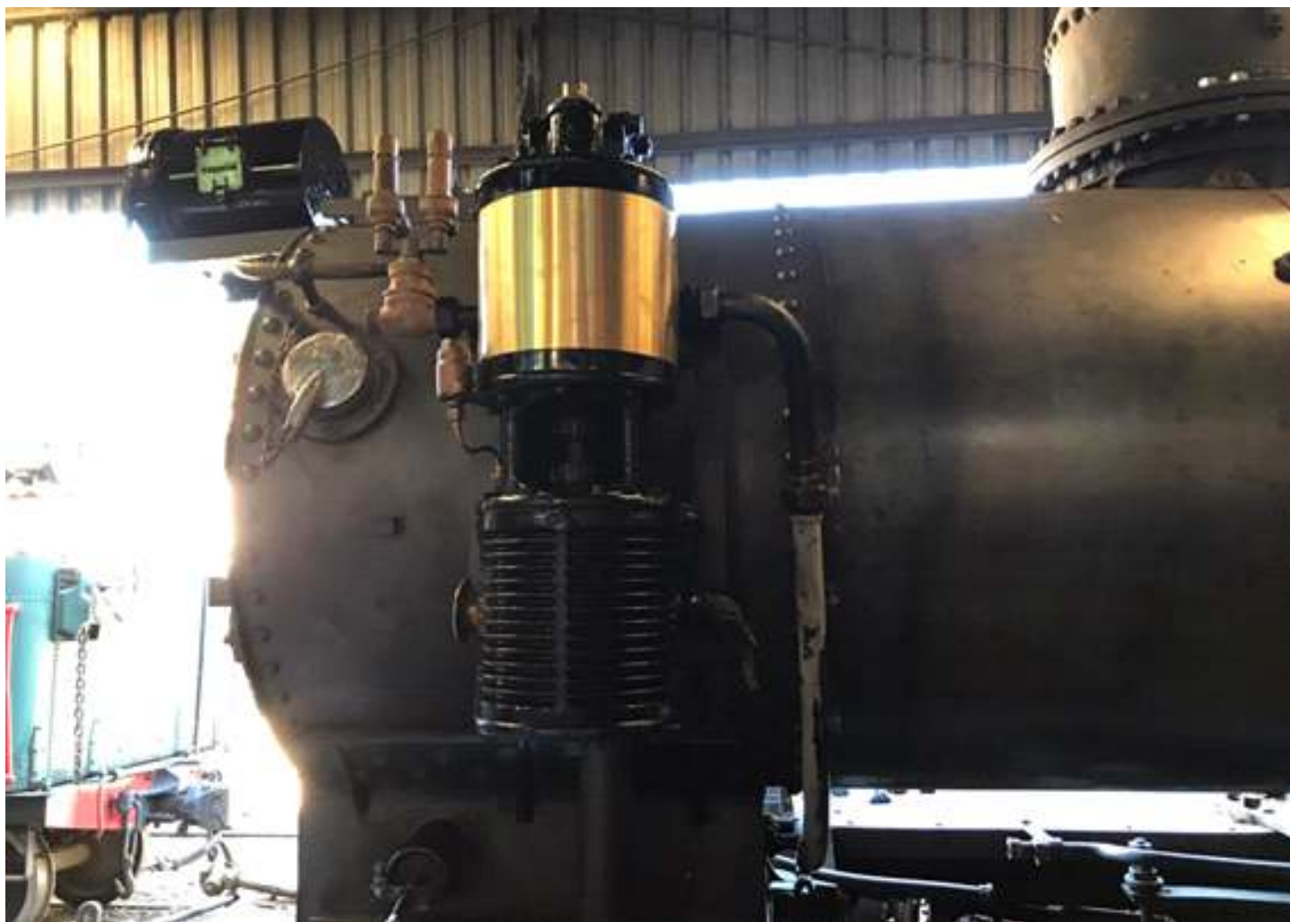
♦ Detalhe da caixa de fumaça locomotiva 12 de Ribeirão Preto, com o farol e compressor de ar.
