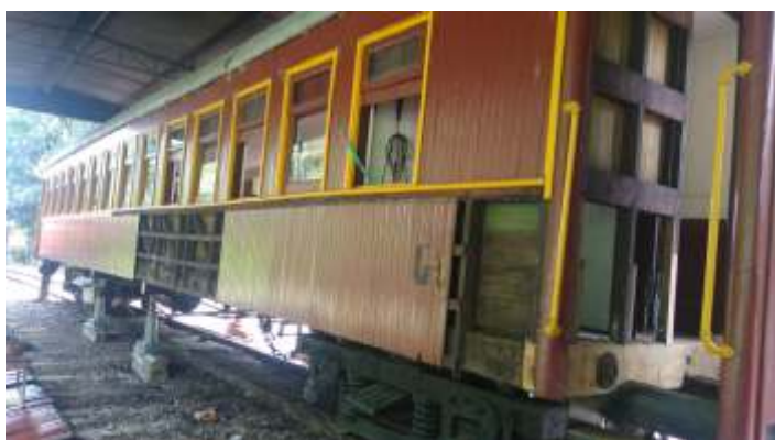
◆ Viga substituta já trabalhada e adaptada para o encaixe; trabalho perfeito do carpinteiro Dierres Ferreira Freitas. Autoria de Otávio Georg Junior
