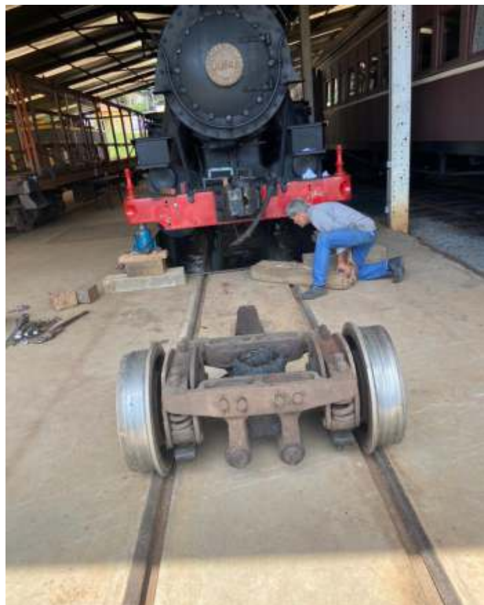
◆ Remoção do jogo-de-guia da 1424 para reparação
