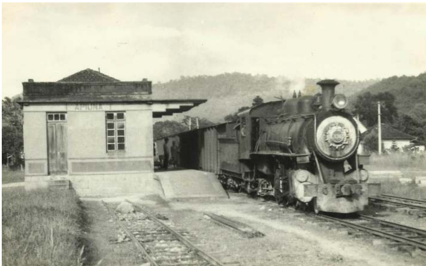
♦ A 336 e composição passando por Apiúna no dia 11 de março de 1971 com o maquinista Domingo Passo da Silveira . Cabine metálica e limpa trilho de chapa, era a nova versão da 336 de 1969 em diante. Ainda com tender original RMV. Autoria de Armando Ferrari
