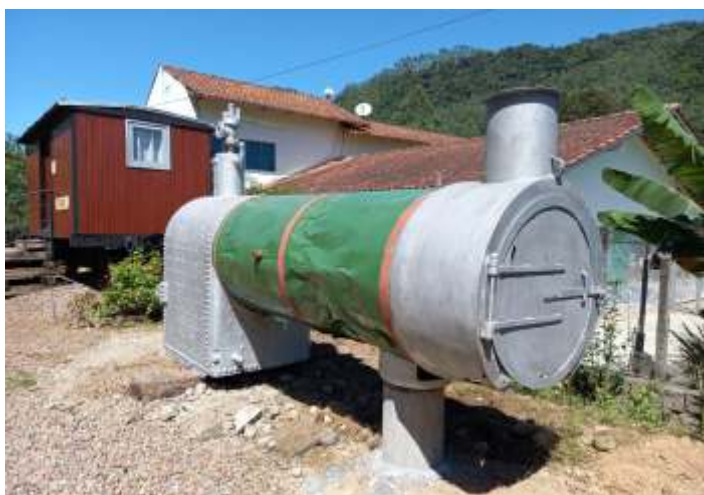
◆ Posicionamento da caldeira do locomóvel. Autoria de Priscila Jesani dos Santos
