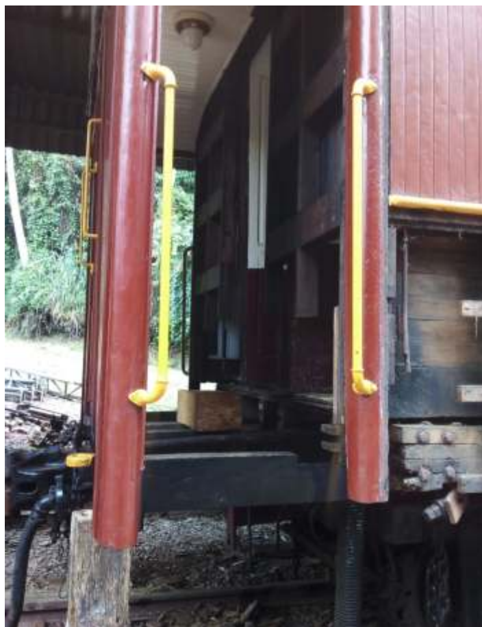
♦ Vista lateral da cabeceira já desmontada e uma das peças de reposição. Autoria de Otávio Georg Junior
