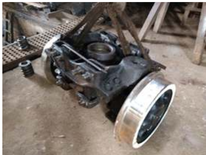
♦ Finalização dos ajustes no conjunto de roda guia da locomotiva Mikado nº 760
