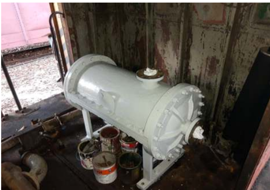
♦ Cooler da 3104, já revisado e instalado na locomotiva.
