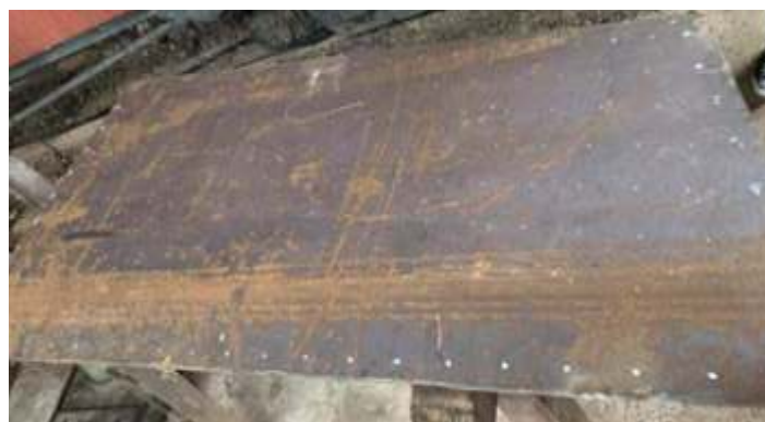
♦ Instalação da parte frontal e a preparação na nova chapa, lateral interna do lado esquerdo da locomotiva nº 156
