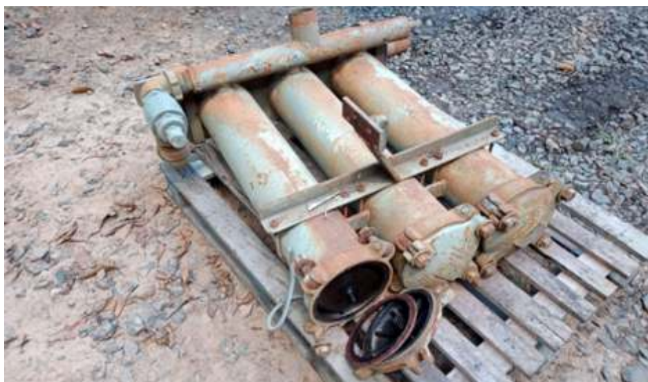
♦ Conjunto de filtros que era da 3128 a ser recuperado e instalado na 3104.
