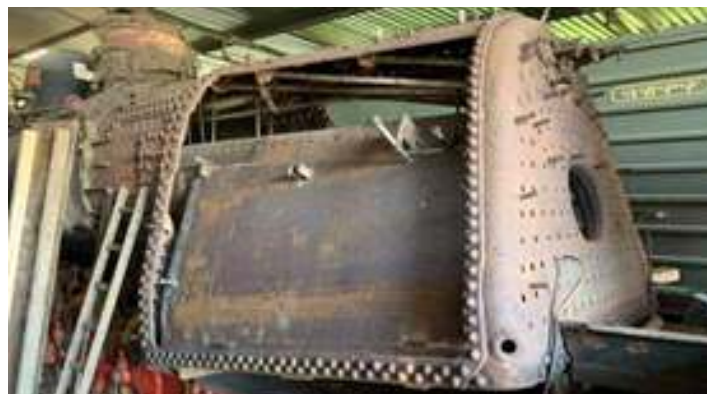
♦ Instalação da parte frontal e a preparação na nova chapa, lateral interna do lado esquerdo da locomotiva nº 156
