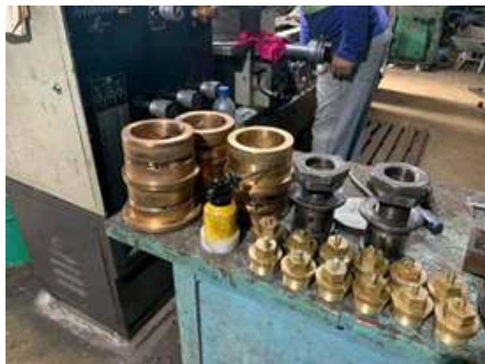
♦ Preenchimento de metal patente no mancal e ajustes novo sistema de lubrificação da locomotiva nº 760
