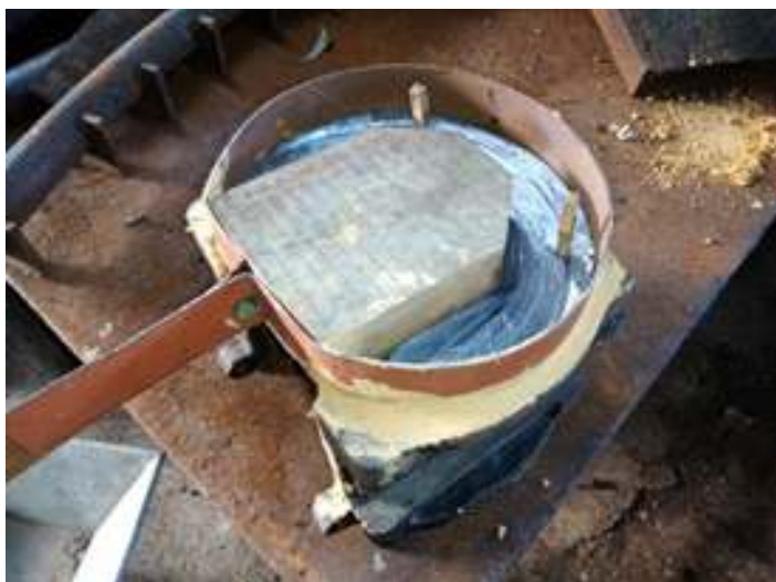
♦ Preenchimento de metal patente no mancal e ajustes novo sistema de lubrificação da locomotiva nº 760
