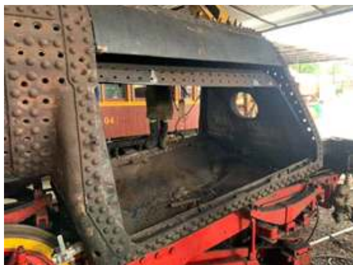
♦ Pré montagem da chapa interna do lado esquerdo e pré montagem da chapa externa direita da locomotiva nº 156
