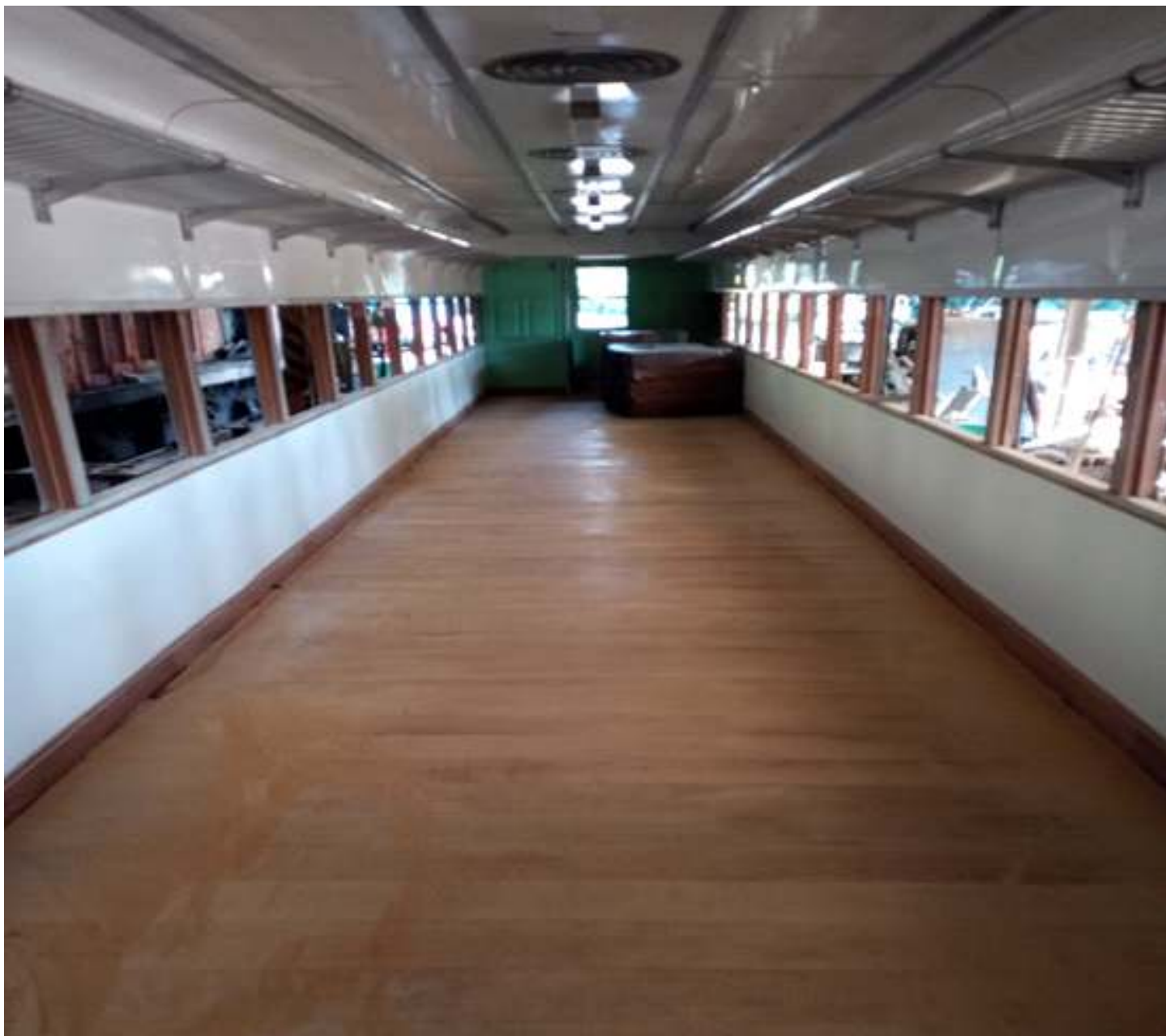
♦ Assoalho do carro CA-61 já lixado. Ao fundo pacotes com as espumas para os assentos.
