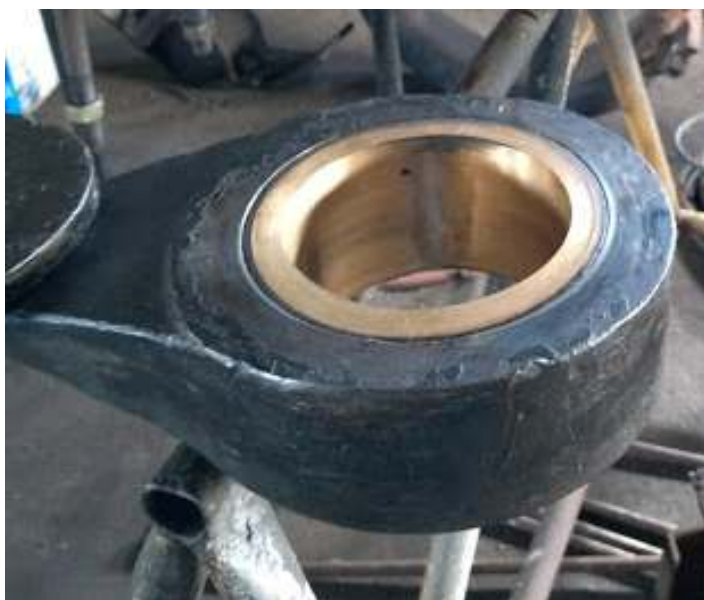
◆ Nova bucha já instalada na braçagem
