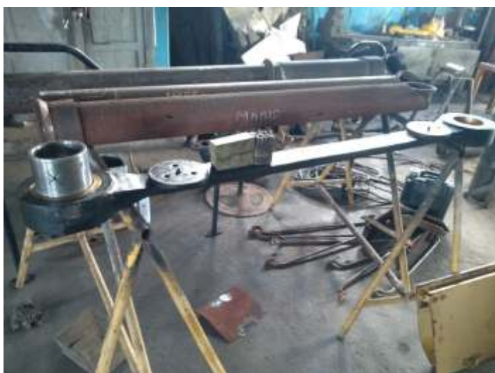
◆ Novas buchas já instaladas na braçagem
