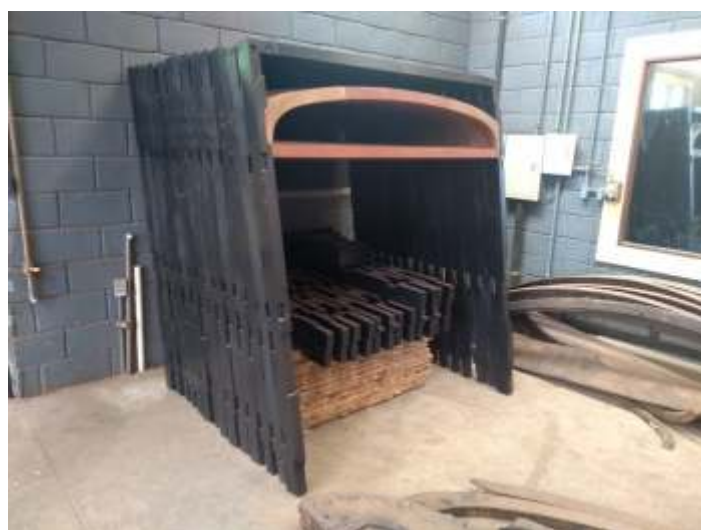
♦ Com base nas peças de madeira antigas, a equipe da marcenaria está produzindo novas, idênticas
