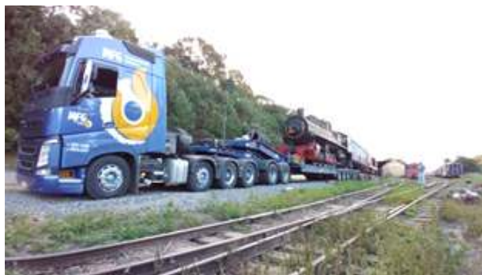
◆ Carregamento da locomotiva Santa Fé nº 201 nas oficinas de Rio Negrinho
