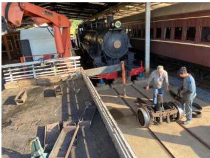
◆ Jogo de guia da locomotiva 1424 sendo preparado para o içamento para ser levado para as oficinas de Cruzeiro
