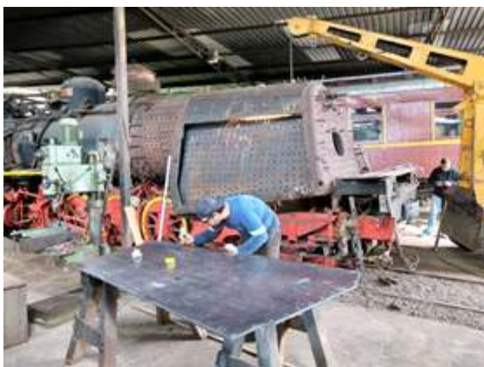
♦ Preparação para o corte definitivo da chapa externa do lado esquerdo e início da marcação para usinagem dos furos dos estais
