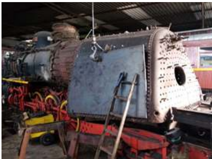
♦ Chapa externa do lado direito já com usinagem completa dos furos dos estais
