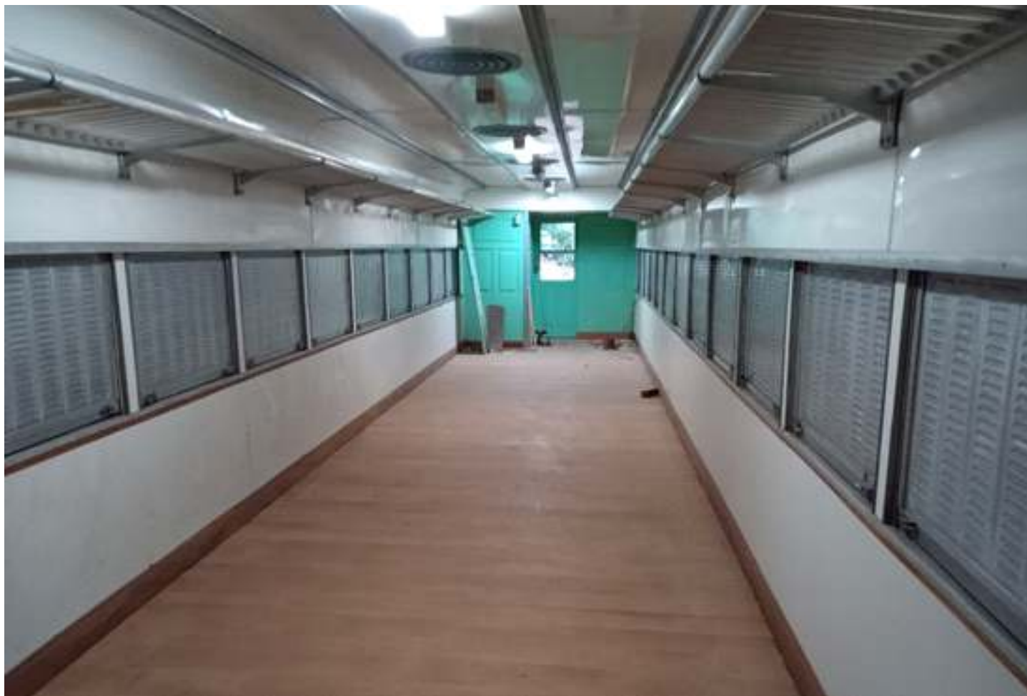
♦ Interior da carro já com as janelas instaladas
