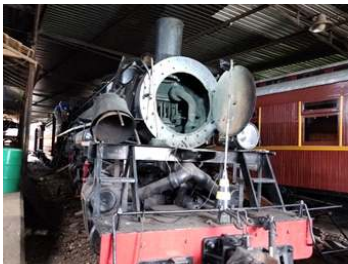
♦ Locomotiva Mallet nº 204 recebendo uma completa revisão na véspera do passeio do Trem da Serra do Mar
