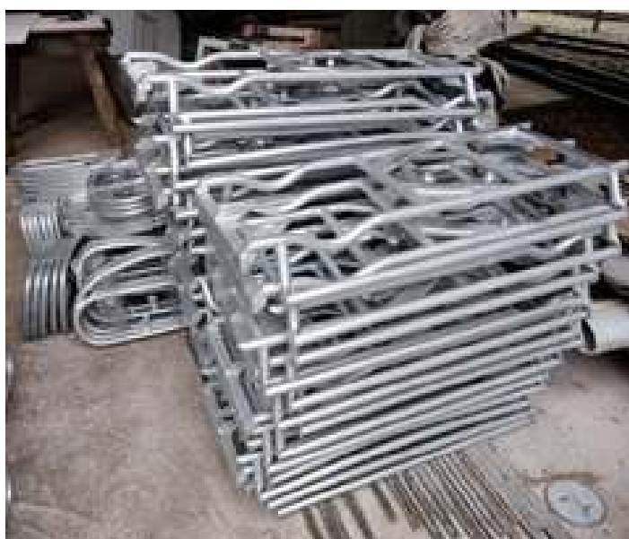
◆ Conjunto de peças que formam as estruturas das poltronas todas recuperadas com pintura em epóxi
