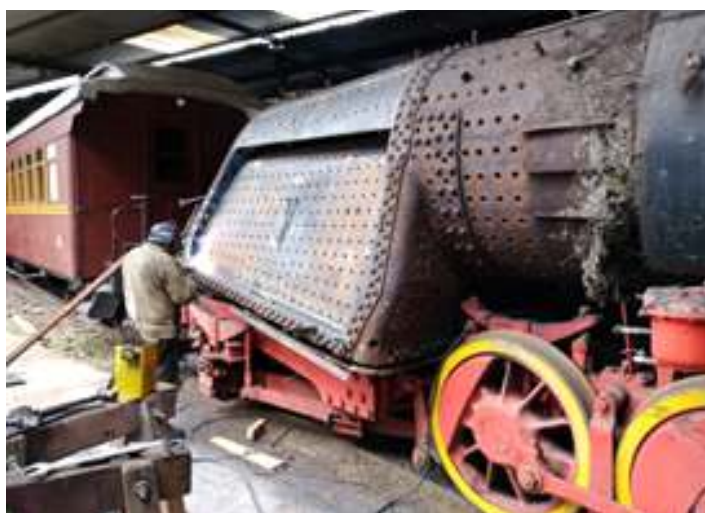
◆ Instalação da chapa interna do lado direito com finalização das soldas
