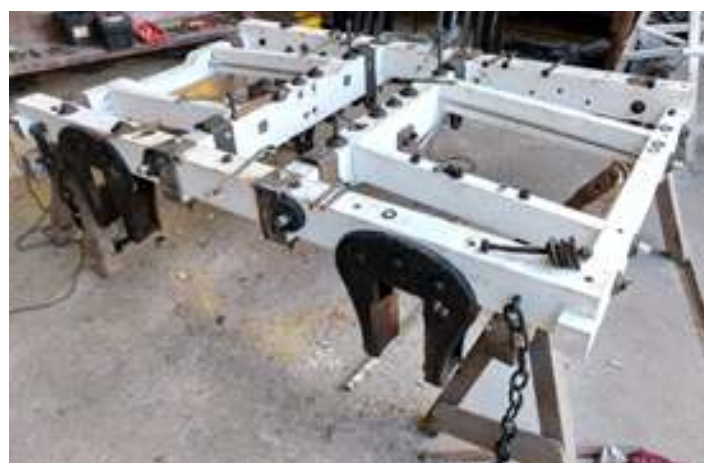
◆ Montagem de todas as partes metálicas no novo truque do carro SD – 39
