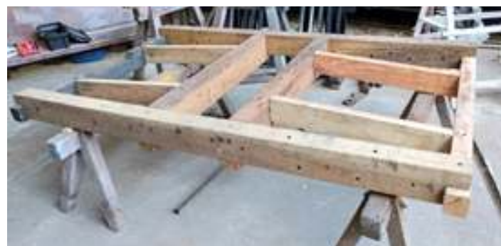
◆ Revisão do carro passageiro SD – 39 que agora estará recebendo um truque totalmente novo em madeira de lei
