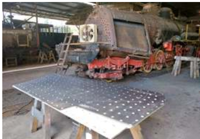
♦ Chapa externa do lado direito já com usinagem completa dos furos dos estais
