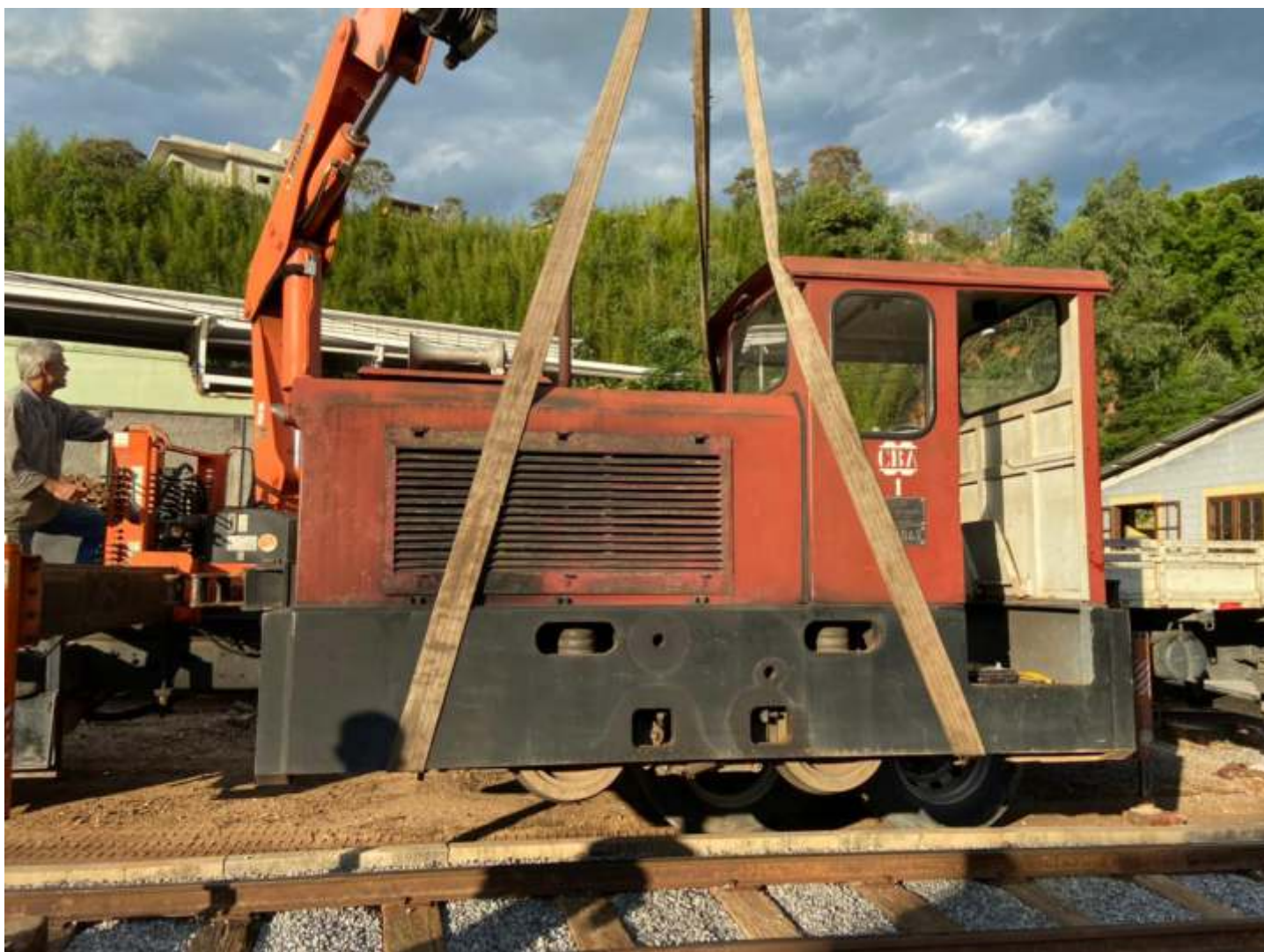
◆ A pequena locomotiva diesel-hidraulica O&K n°1 ex. CBA sendo erguida para ser levada para as oficinas de Cruzeiro
