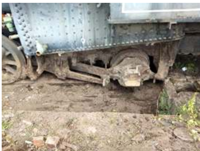
◆ O trabalho árduo de retirada de detritos que interavam as rodas guias na locomotiva Mikado nº 632
