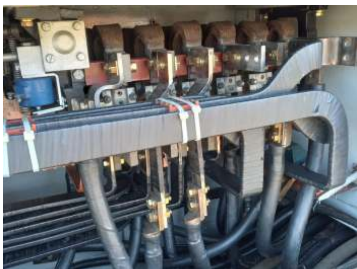
♦ Montagem e organização dos componentes e cabearios da locomotiva 9380
