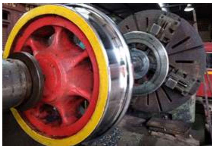
♦ Usinagem de roda motriz da 156 refazendo o ângulo do flange e o chanfrado na banda de rodagem
