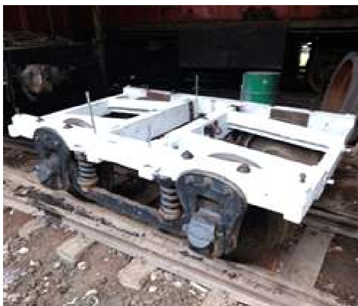
◆ Novo truque de madeira para o carro passageiro SD 39
