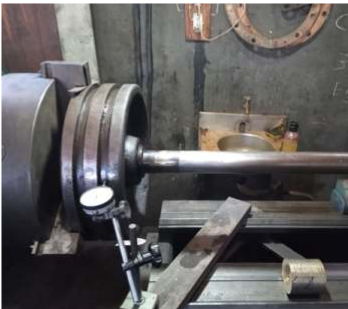
♦ Usinagem do embolo da 338, que será colocado anéis novos! Foto Helio Gazetta
