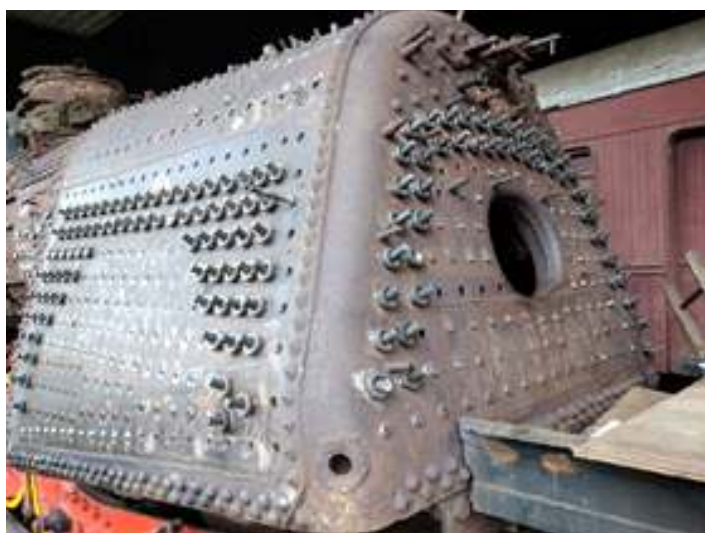
♦ O trabalho de fixação das bases das cabeças de estais de bola, os flexíveis
