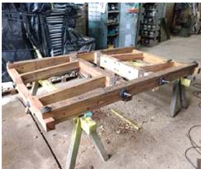
◆ Montagem de um novo truque para o carro SD 39
