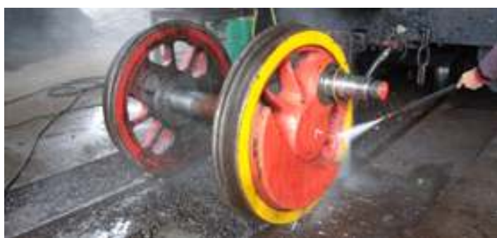
♦ Os trabalhos de remoção e limpeza dos rodeiros motrizes
