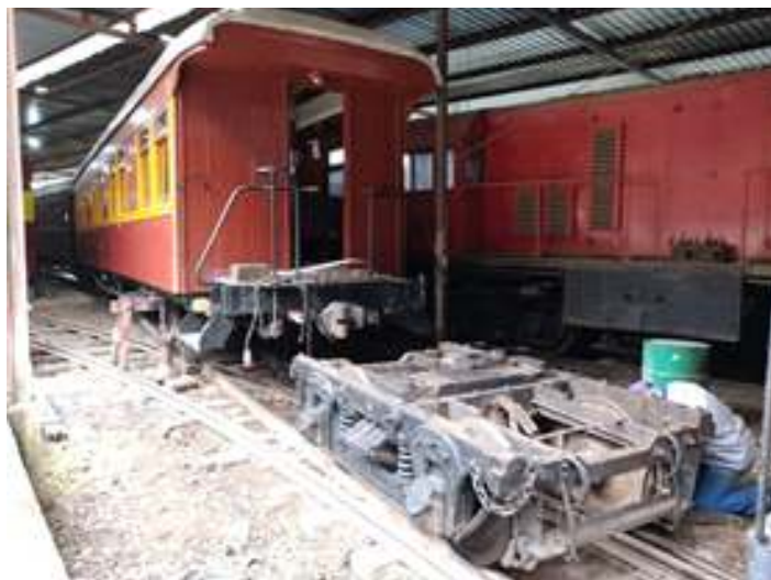
◆ Revisão da parte rodante do carro SD 39
