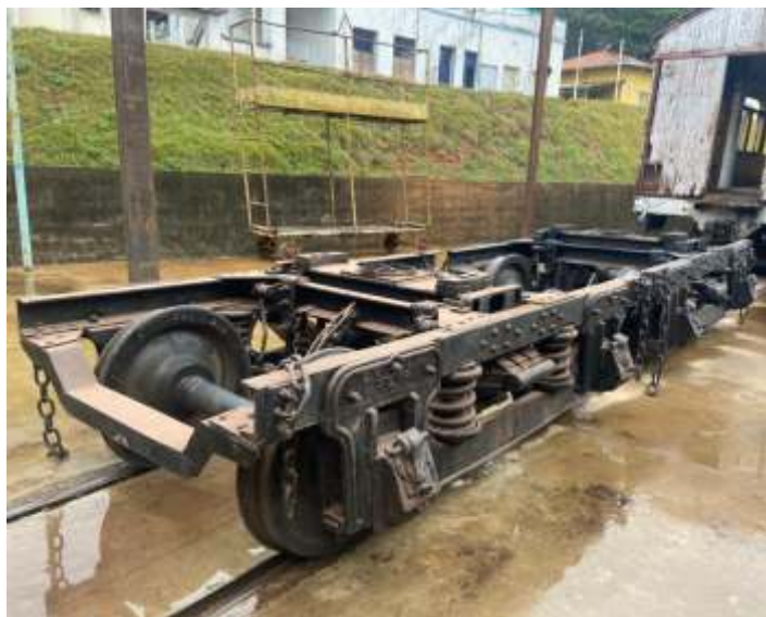
♦ Truques do carro SD-22 aguardando transporte para as oficinas de Cruzeiro, onde serão revisados
