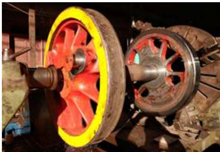
♦ Os trabalhos de remoção e limpeza dos rodeiros motrizes
