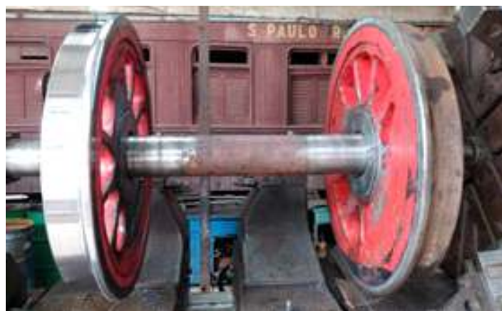
♦ Usinagem de roda motriz da 156 refazendo o ângulo do flange e o chanfrado na banda de rodagem
