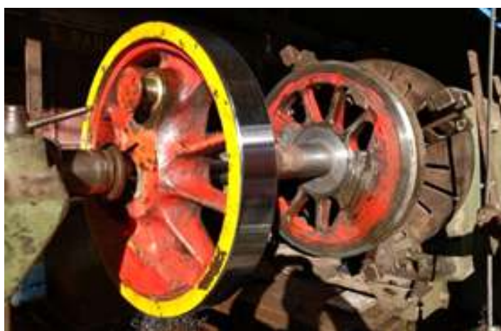
♦ Usinagem das rodas motrizes da locomotiva nº 156 refazendo o ângulo do flange
