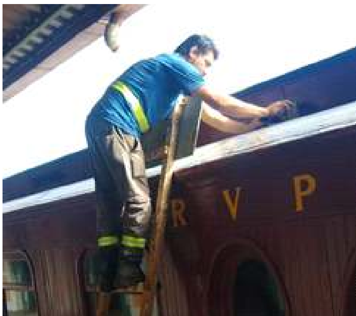
♦ Reparos na cobertura do carro administrativo AM 03
