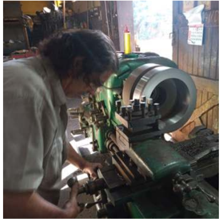
♦ O associado Izaldo usinando novos anéis para a 338 – Foto Helio Gazetta
