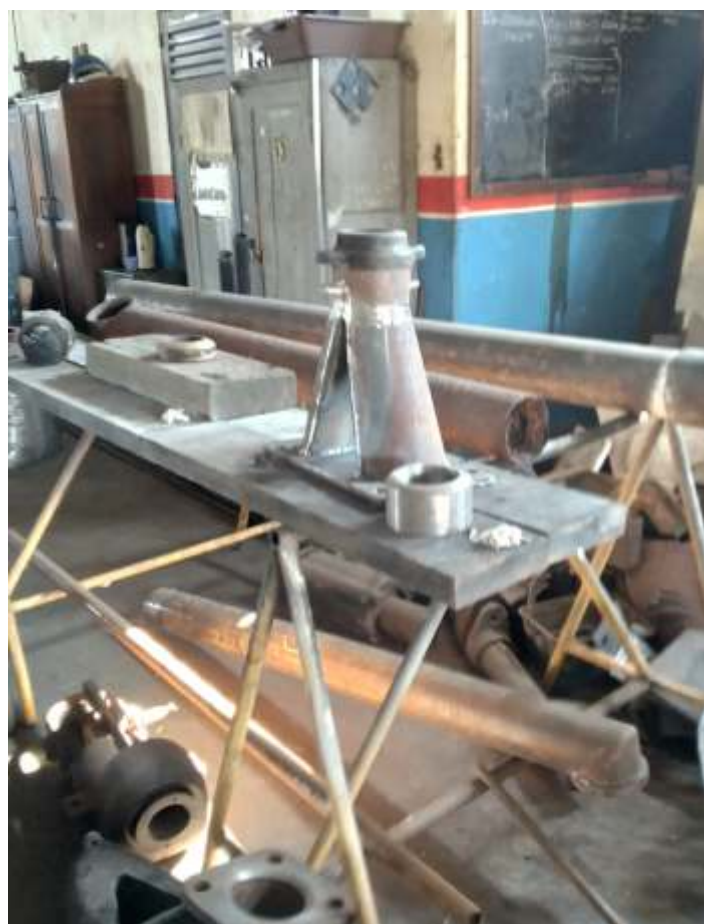
♦ Confeção de novo escapamento para a locomotiva nº5
