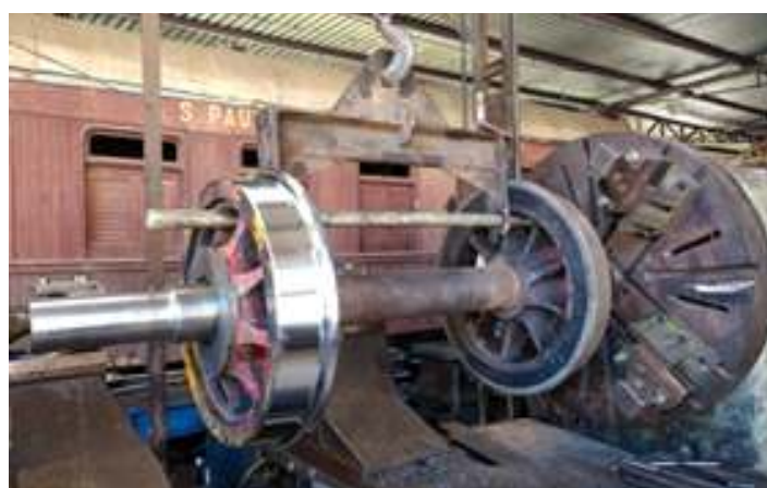
♦ As duas novas buxas de bronze e usinagem das brassagens agora na tolerância correta
