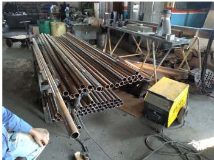
♦ Preparação de tubos para a caldeira da locomotiva nº5
