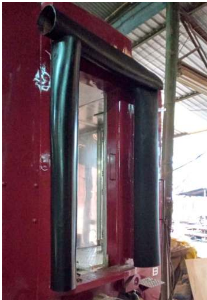
♦ As borrachas do fole de passagem já instaladas, doadas pela Sorocabana – Movimento de Preservação Ferroviária, de Sorocaba SP - Foto Helio Gazetta
