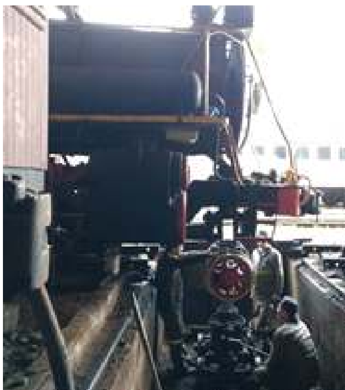
♦ Montagem das rodas motrizes e da roda guia dianteira
