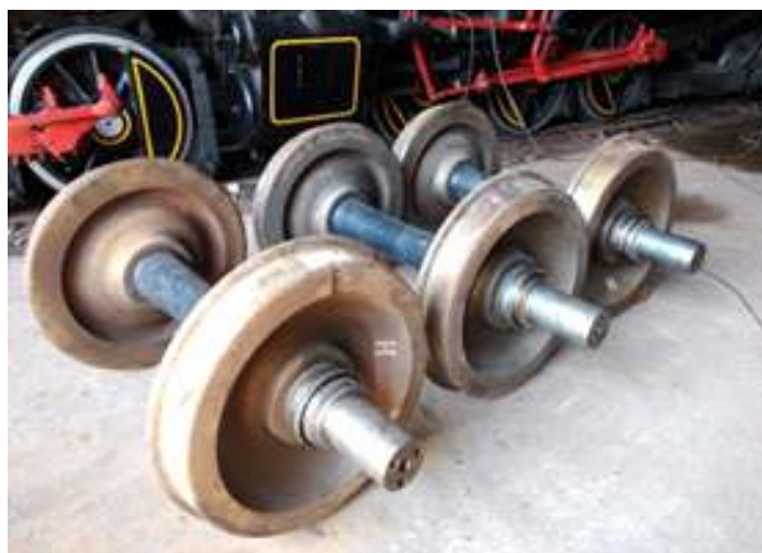
♦ Revisão completa de todo conjunto dos truques do carro passageiro PC 49
