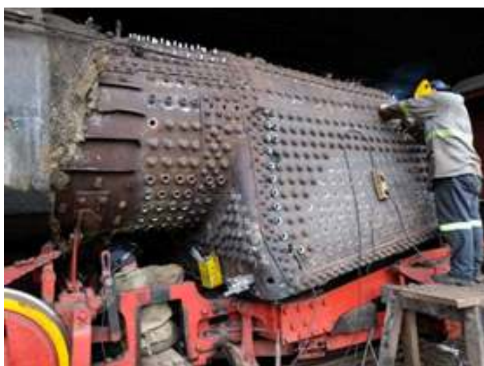
◆ Os trabalhos mais críticos de soldagem na parte externa da conduta
