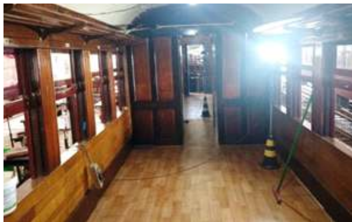
♦ Janelas já pintadas conforme o padrão original e madeiramento novos para o carro de MD-47.
