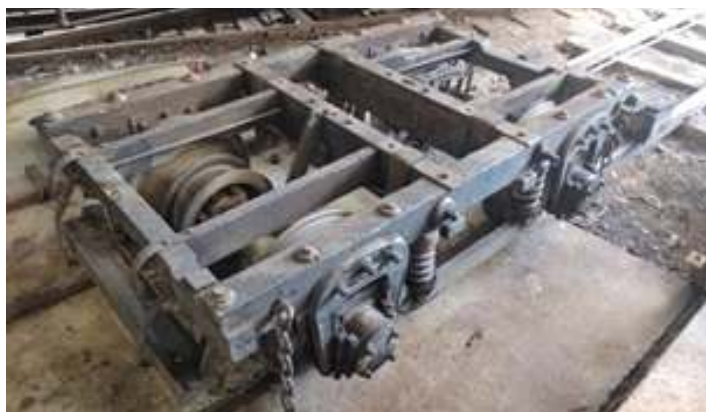
♦ Remoção dos truques do carro de passageiros MD-47 para revisão e inspeção de componentes.
