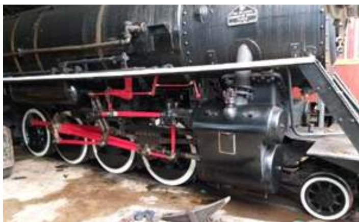
♦ Limpeza das partes móveis e dos cilindros da nossa Mikado nº 761, feita por nosso associado/voluntário Ivan José.
