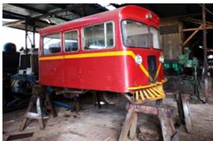
◆ Auto de Linha “Bolinha” suspenso em cavaletes para revisão de suas rodas e partes mecânicas.
