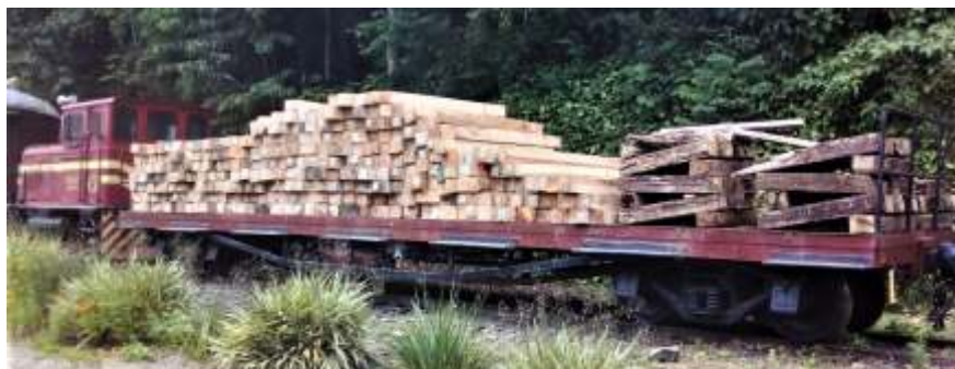
♦ Vagão plataforma VP138 carregado com os novos dormentes recebidos em novembro. Autoria: Otávio Georg Junior
