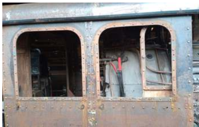
◆ Recomposição da chaparia da cabina. Feito em rebites como original – Fotos de Helio Gazetta Filho
