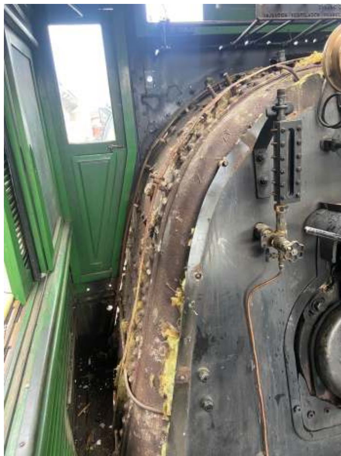
♦ Forro da caldeira da locomotiva 1424 parcialmente removido no interior da cabine para soldagem dos estais que apresentavam vazamentos.
