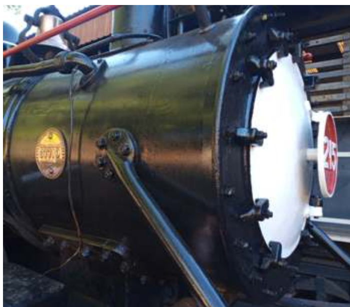
◆ Detalhe da caixa de fumaça da 215. Fotos de Helio Gazetta Filho
