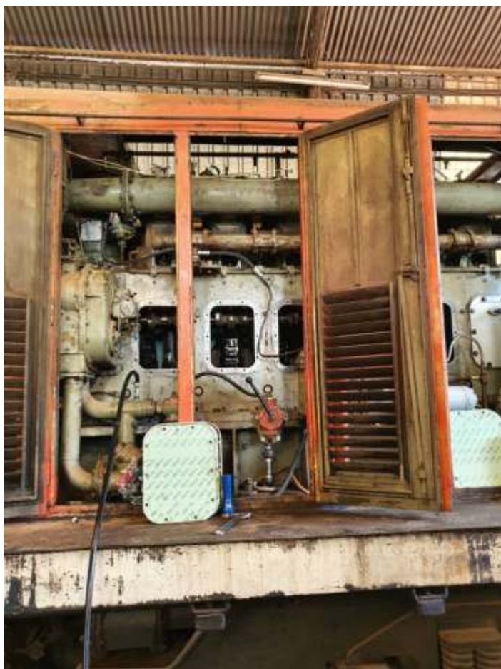
♦ Detalhe motor 3104 no momento fazendo a pré lubrificação Foto Rodrigo Fernando
