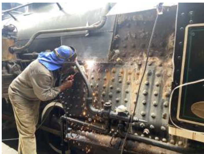
♦ Soldagem dos estais na caldeira da locomotiva 1424
