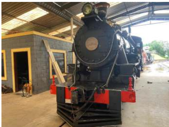
♦ A locomotiva 1424 recolhida nas oficinas de São Lourenço para soldagem dos estais
