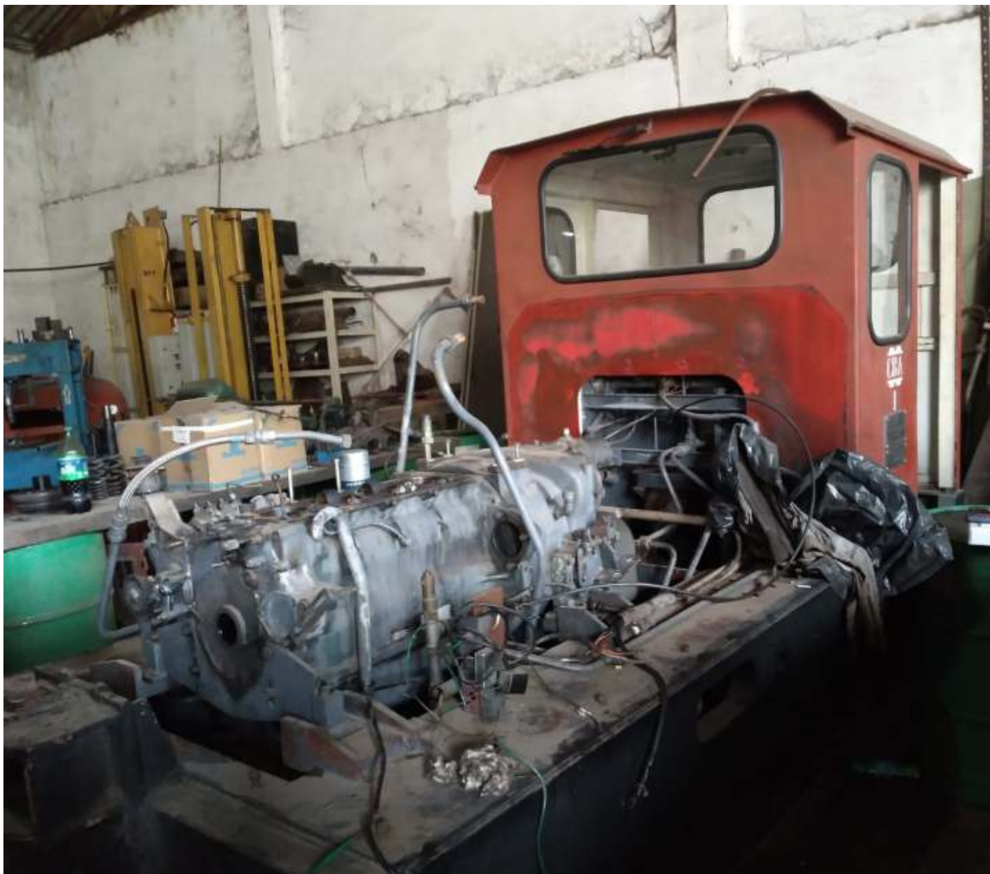
♦ A pequena locomotiva diesel hidráulica CBA 1 já sem o capô e com o motor diesel desmontado.
