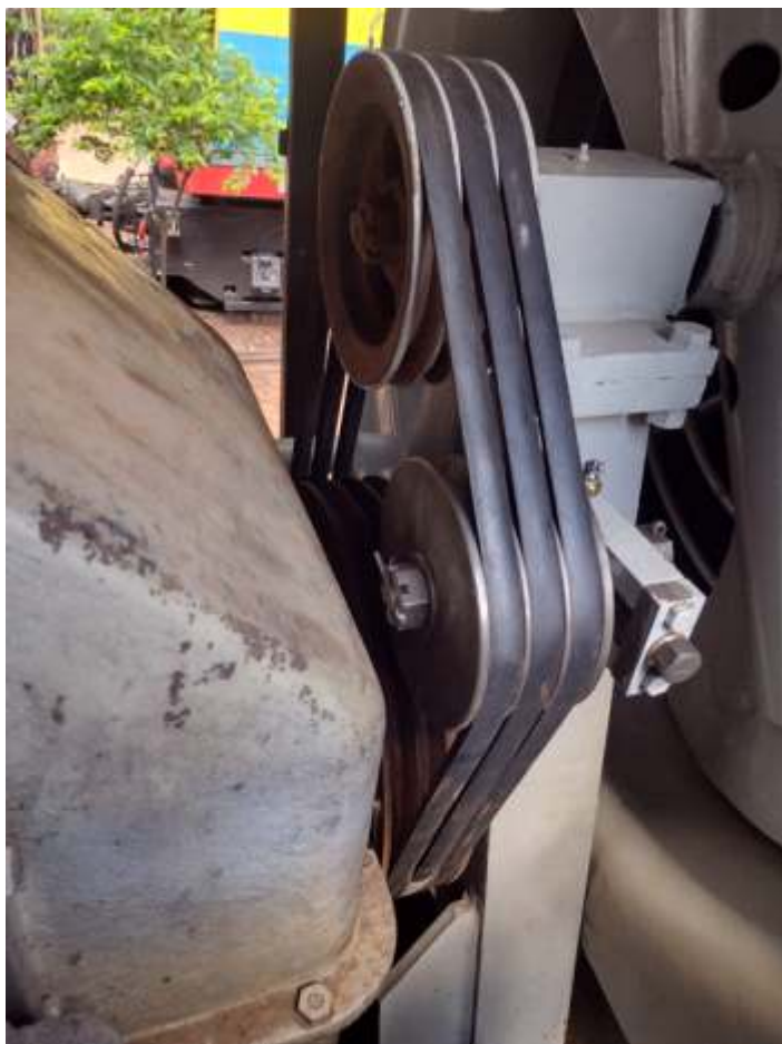
♦ Correias colocadas e novo esticador feito nas oficinas, um dos itens faltantes do motor – Foto Rodrigo Fernando
