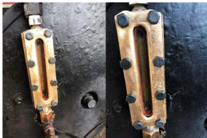
♦ Limpeza e polimento do visor de água da locomotiva Mogul nº. 11.
