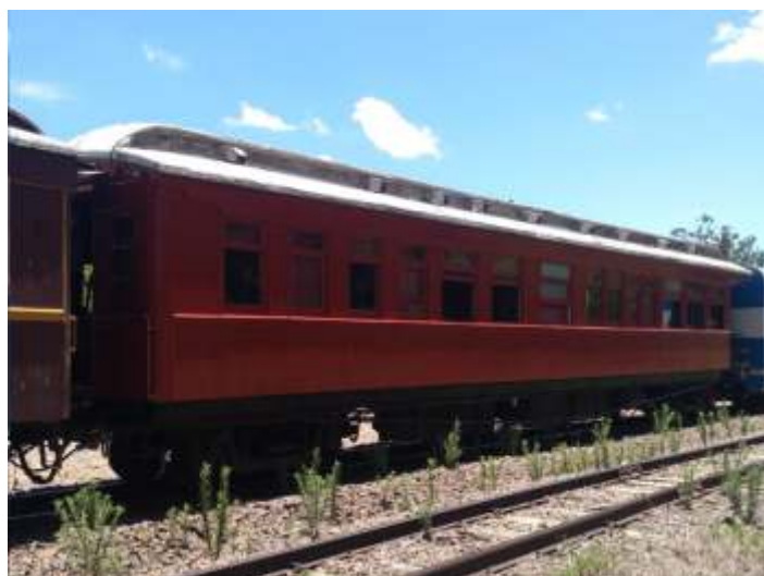
♦ Carro administrativo AD-09, já com a pintura finalizada e varanda reconstruída.
