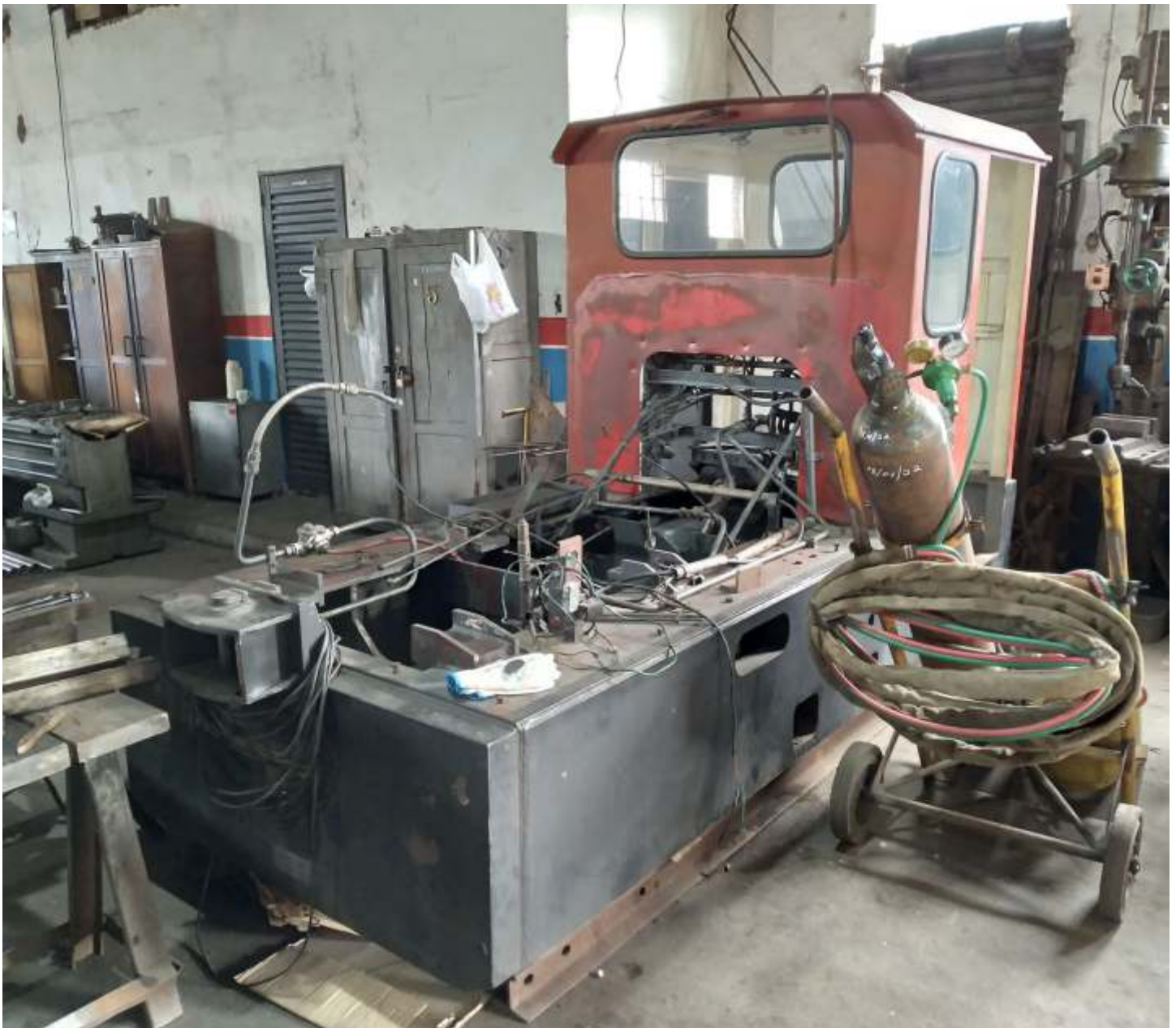
◆ A pequena locomotiva diesel-hidráulica CBA 1 já sem o bloco do motor diesel, que foi para a retífica.
