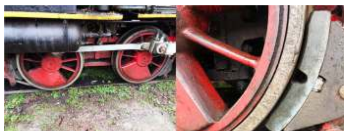
♦ Novas sapatas de freio da locomotiva Mogul nº 11, doadas pela Concessionária Rumo Logística.
