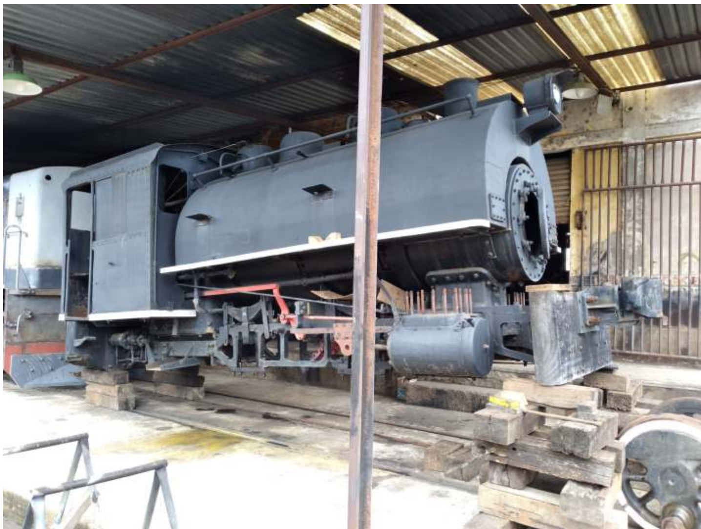
♦ A locomotiva nº2 sobre cavaletes nas oficinas de Cruzeiro: foram removidos os rodeiros para recuperação das caixas.
