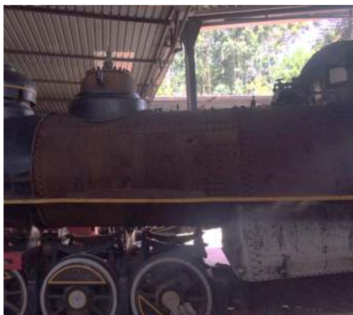
♦ Desmontagem da chaparia externa e revisão da caldeira da locomotiva Mikado nº. 627.
