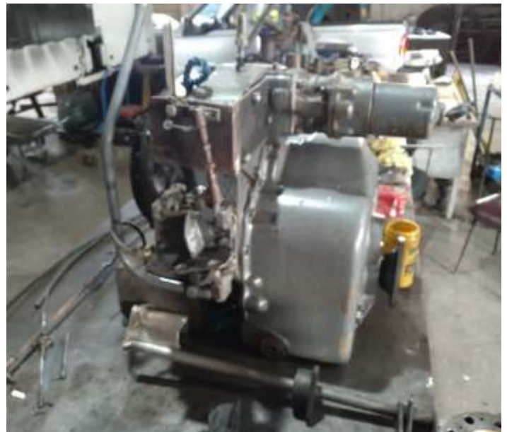
◆ A transmissão hidráulica já removida da locomotiva.
