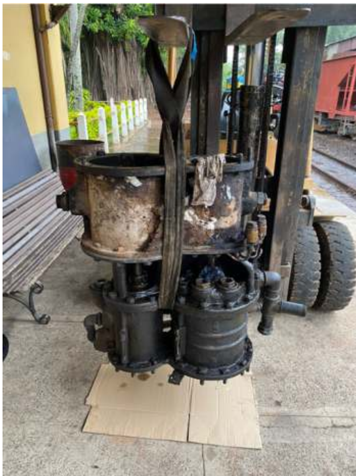
♦ Compressor de ar da locomotiva 505 retirado para manutenção.
