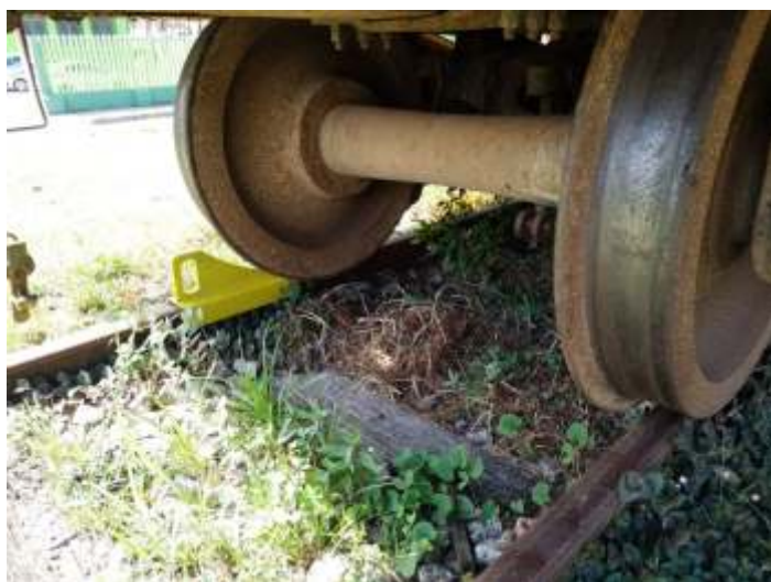
◆ Calços ferroviários aplicados ao nosso material rodante após treinamento de operações ferroviárias.
