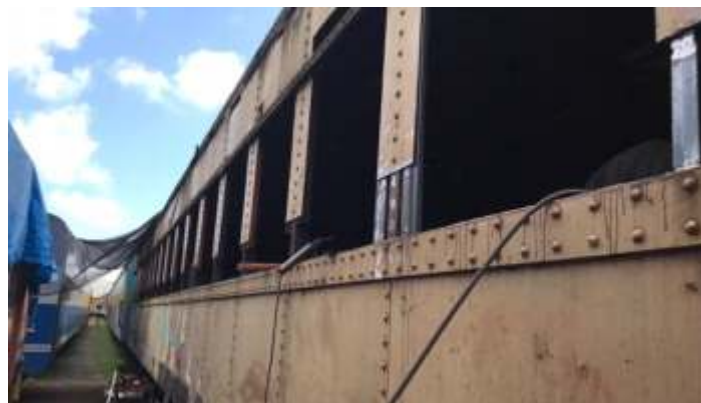
♦ Remoção das chapas metálicas comprometidas do carro de passageiros PC-59.
