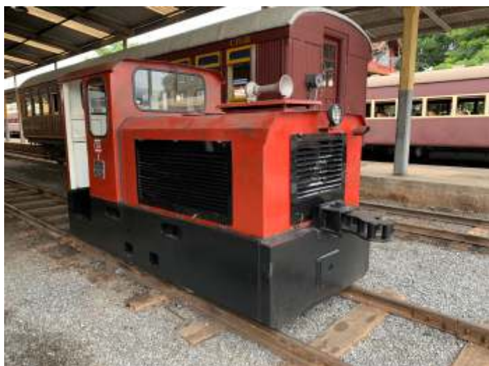
♦ A CBA 1 no depósito de material rodante de São Lourenço e o motor diesel Deutz reconstruído.
