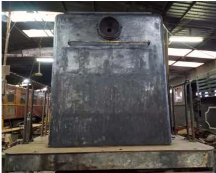
◆ Após decapagem, aplicação de ferrox. Agora pode notar as partes da chaparia que foram substituídas.
