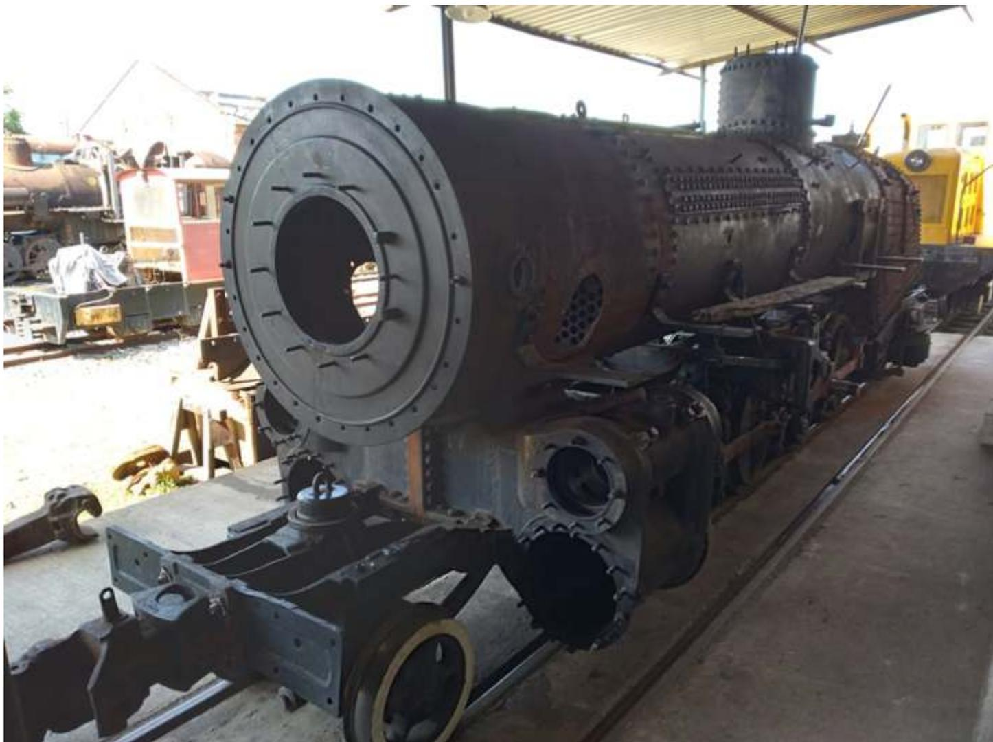
♦ Tampa da caixa de fumaça pré-instalada para marcação da posição de instalação dos novos prisioneiros.
