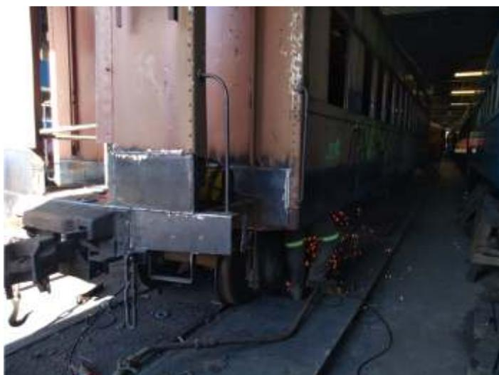
♦ Remoção do sistema de freio do carro de passageiros PC-60.
