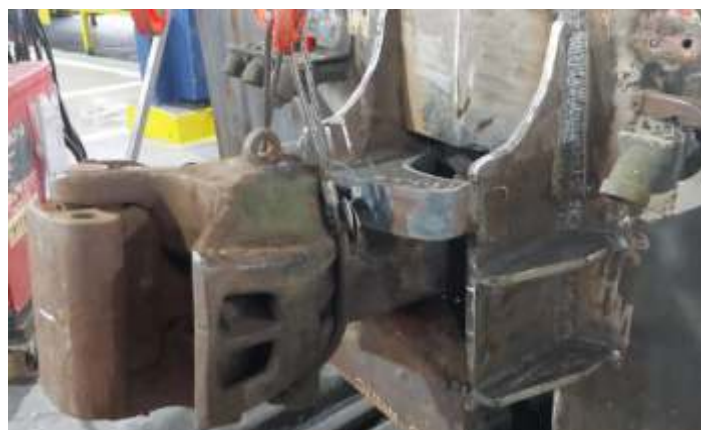
♦ Desmontagem e reconstrução do limpa-trilhos traseiro.
