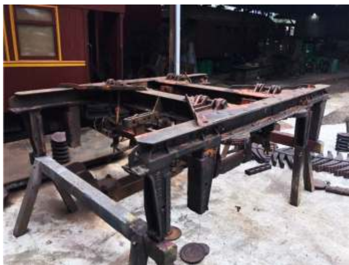
♦ Carro PC-60 já com a pintura externa removida.
