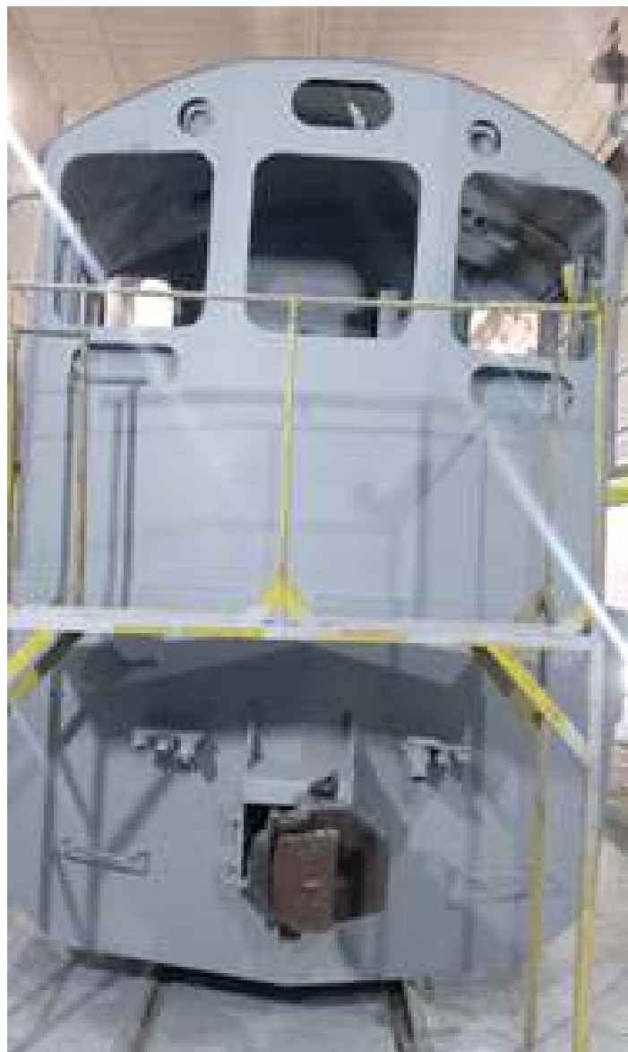
♦ Finalização da reconstrução da funilaria e pintura de fundo na cabeceira curta da locomotiva EMD GL8, nº 4026.
