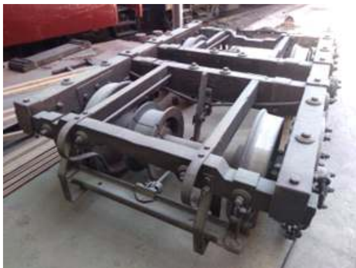
♦ Revisão do truque do carro de passageiros AM-01, para instalação do DDV.
