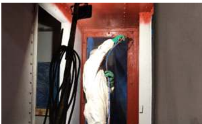
♦ Processo de pintura externa do carro PC-60.
