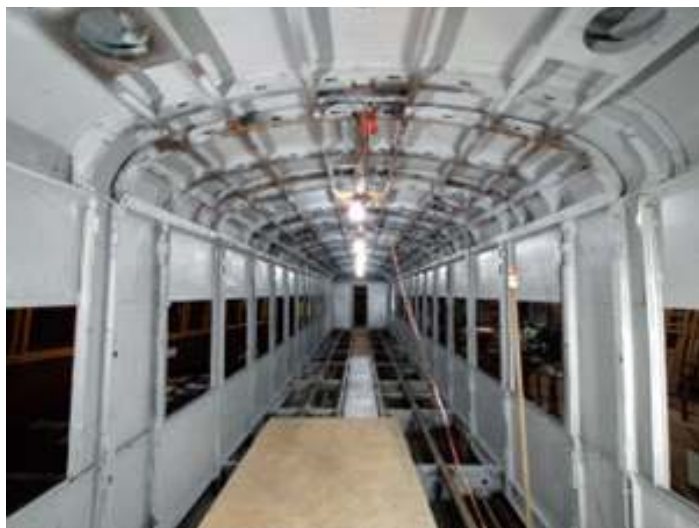
♦ Pintura com tinta fundo, do interior do carro de passageiros PC-60.
