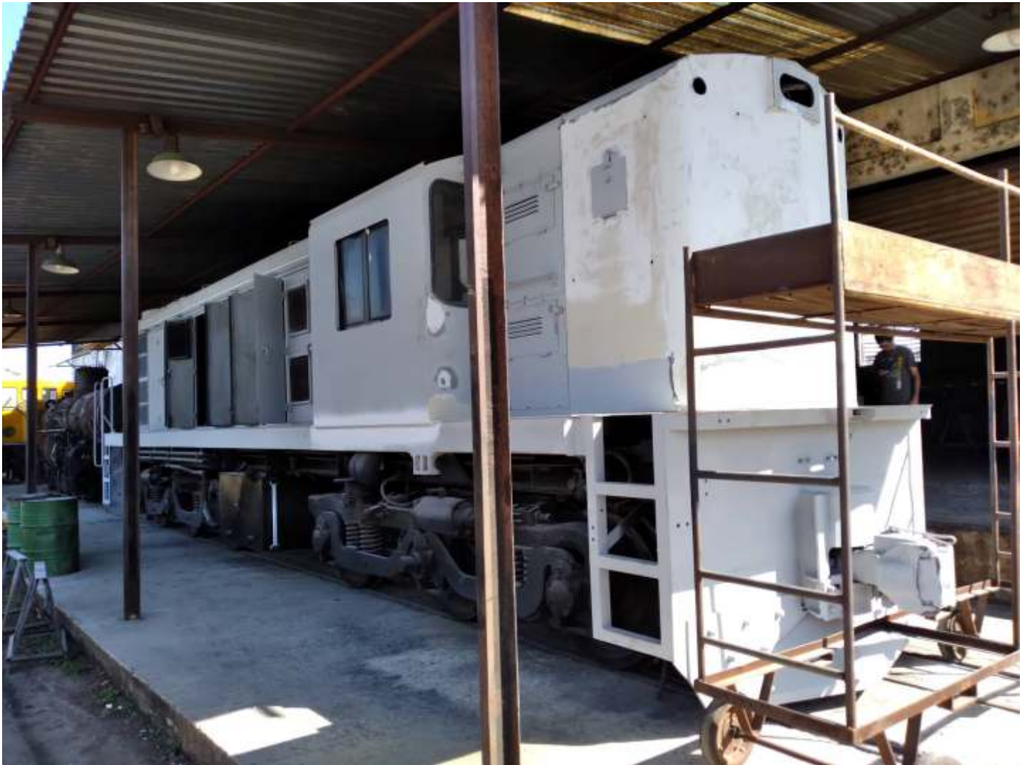
♦ Trabalhos finais de funilaria na RSD8; aplicação de massa nas áreas onde haviam pequenas imperfeições.
