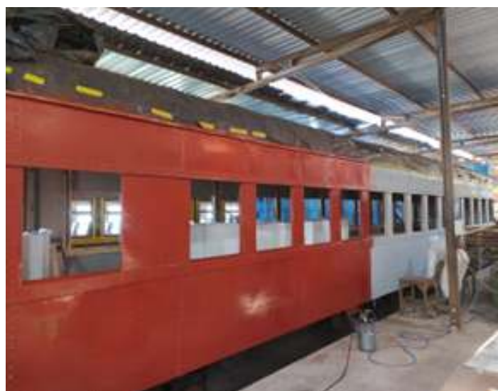
♦ Processo de pintura externa do carro PC-60.
