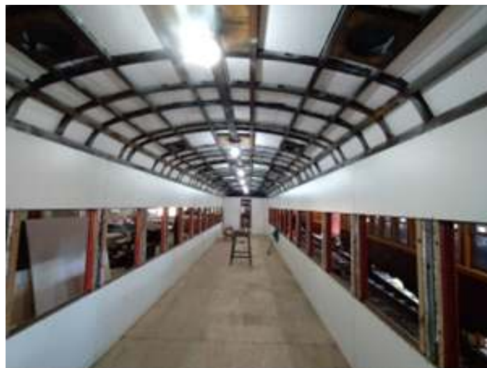
♦ Início da reconstrução do revestimento interior do carro.
