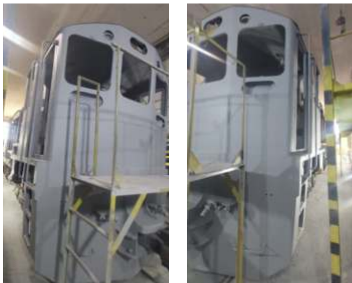
♦ Finalização da reconstrução da funilaria e pintura de fundo na cabeceira curta da locomotiva EMD GL8, nº 4026.
