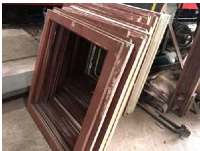
♦ Fabricação dos caixilhos das janelas do carro de passageiros PC-60.
