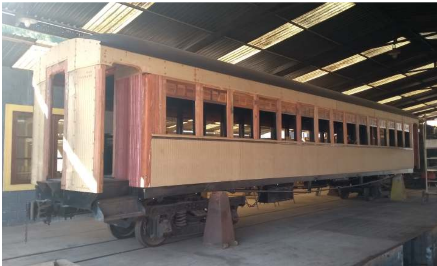
♦ Aspecto externo do carro SD-22, com revestimento já instalado, restando instalar apenas alguns acabamentos.
