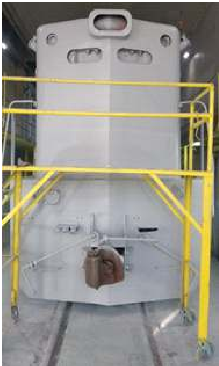
♦ Finalização da reconstrução da funilaria e pintura de fundo na cabeceira longa da locomotiva EMD GL8, nº 4026.
