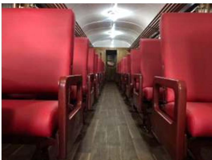
♦ Apoios para braços finalizados e já instalados nas poltronas do carro de passageiros PD-43.
