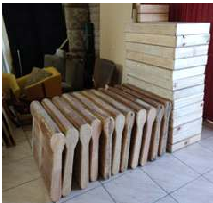
♦ Armação em madeira do assento e encosto do carro de passageiros PC-60, já sendo levados para o estofador.
