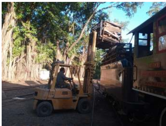
♦ Carregamento de lenha com empilhadeira, com cesto construído pelo Edson Laurindo, para facilitar o carregamento.
