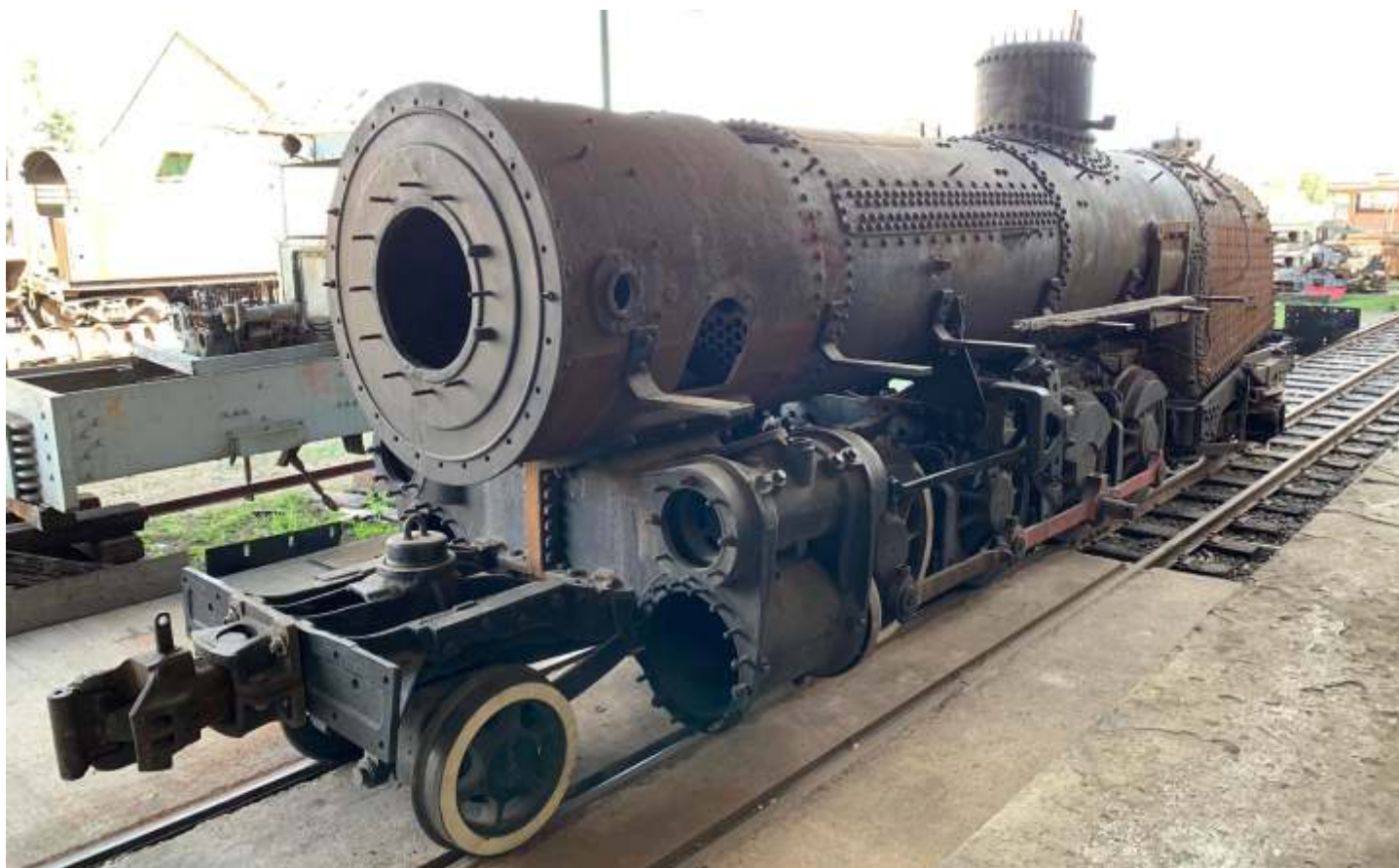
♦ Seguem os trabalhos na locomotiva nº 522 ex. RMV; novas serpentinas foram confeccionadas nas oficinas.
