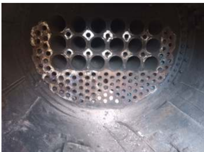
◆ Espelho da caldeira da locomotiva 338, do lado da caixa de fumaça já sem os tubos de 2 polegadas. – Foto de HGF
