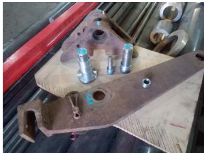
◆ Ajuste das timonias de freio, com pinos e buchas novos. Foto Hélio Gazetta Filho.
