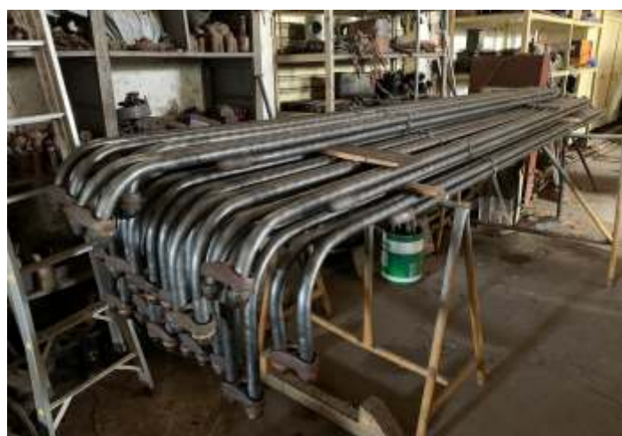
♦ As novas serpentinas prontas para serem instaladas.
