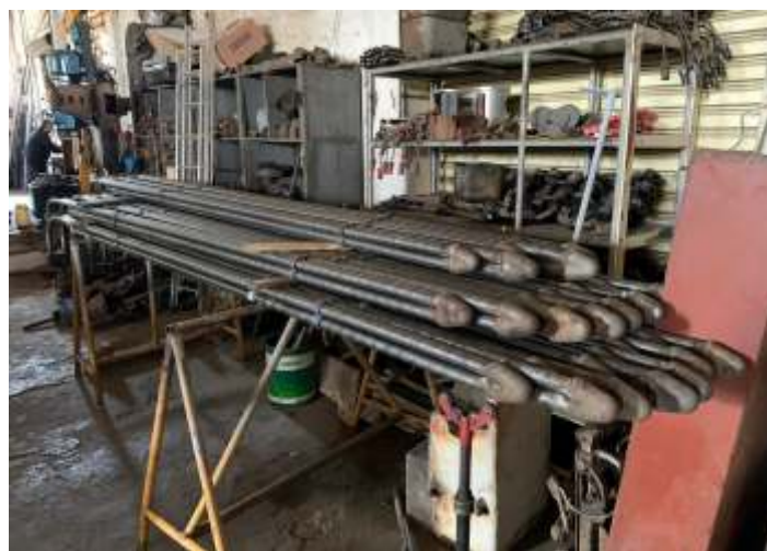
♦ Seguem os trabalhos na locomotiva nº 522 ex. RMV; novas serpentinas foram confeccionadas nas oficinas.
