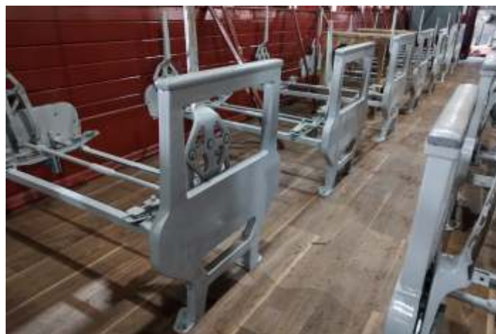
♦ Estrutura metálica das poltronas já instaladas no interior do carro de passageiros PM-33.
