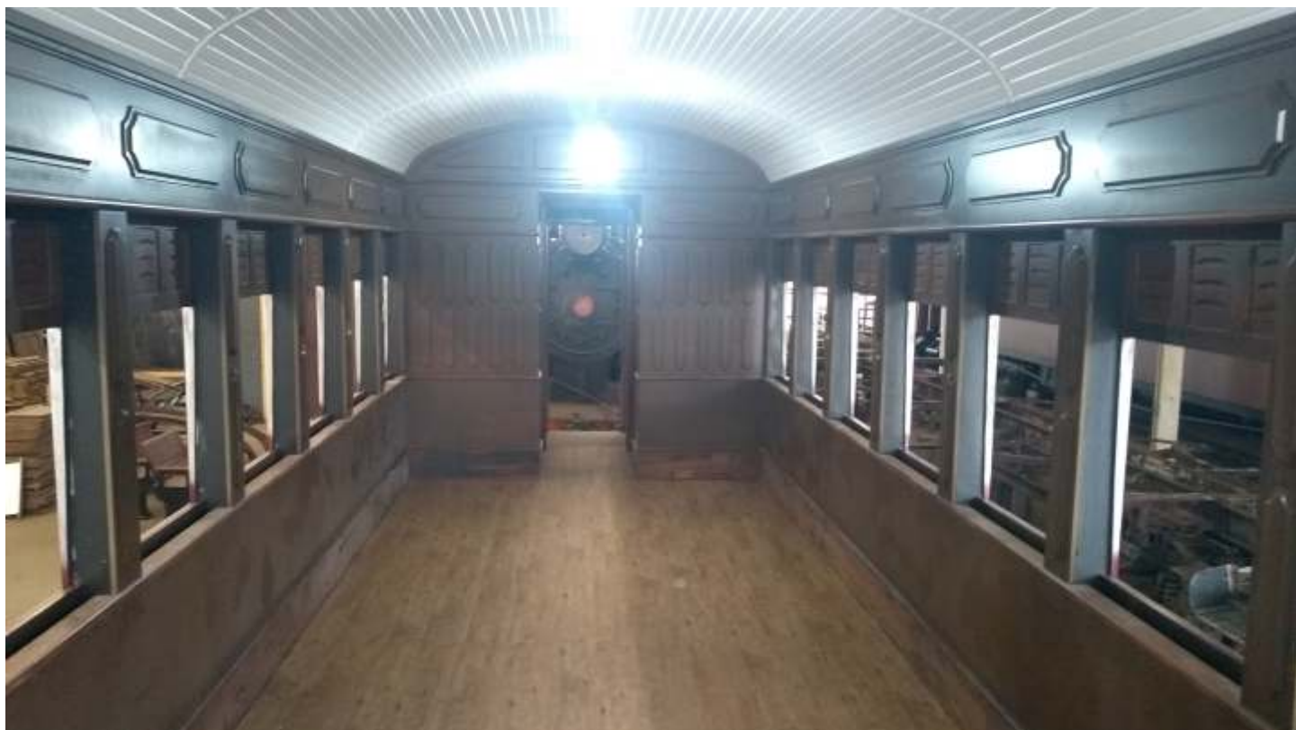
♦ Aspecto do interior do carro, já com o revestimento concluído e aplicação do piso em andamento
