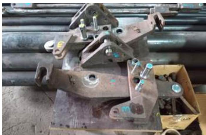
◆ Timonerias de freio da 3104, ajustadas e recuperadas. Foto HGF.
