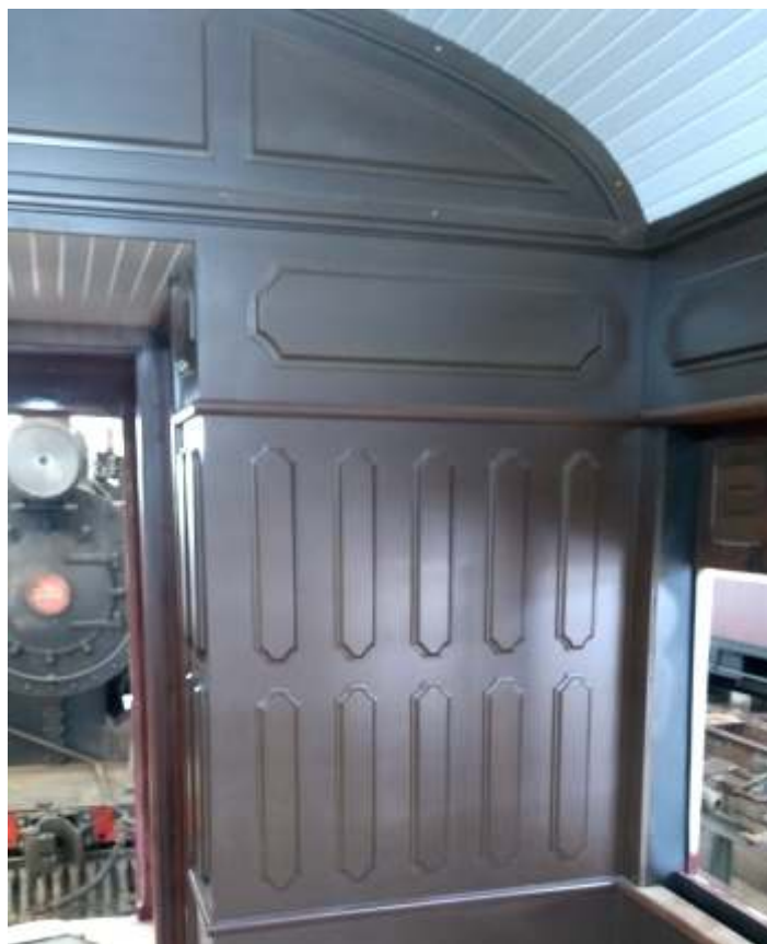
◆ Detalhamento no revestimento interno do carro, todo confeccionado na nossa marcenaria.
