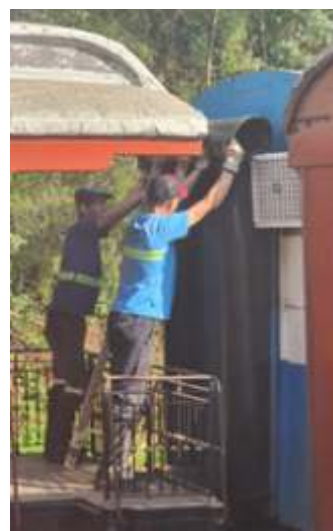
♦ Troca de borracha das sanfonas de proteção dos carros de aço.
