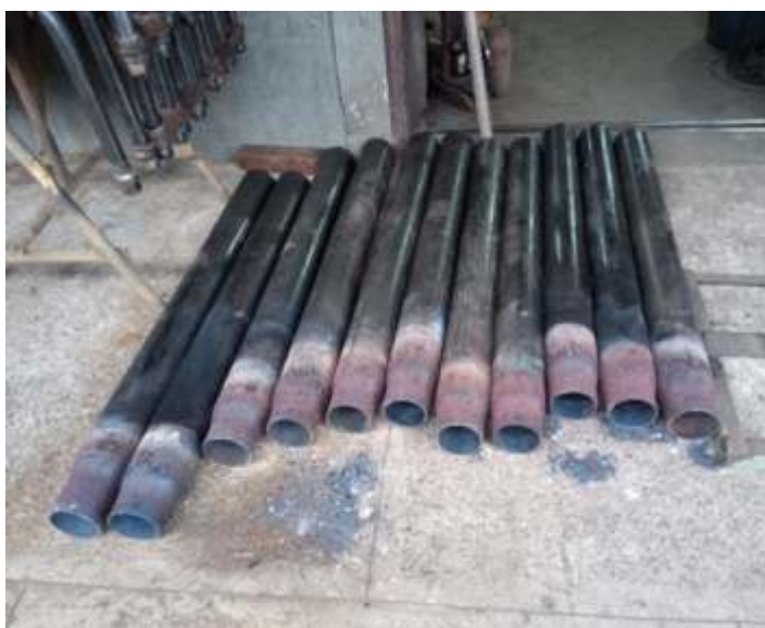
◆ Tubos de 5" já com ponta reduzida, para super aquecedor – Foto H.G.F.
