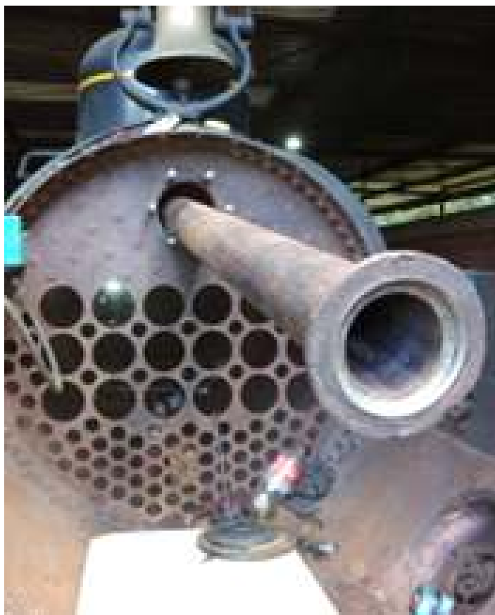
♦ Troca das serpentinas do superaquecedor de vapor da locomotiva articulada Mallet nº 204.
