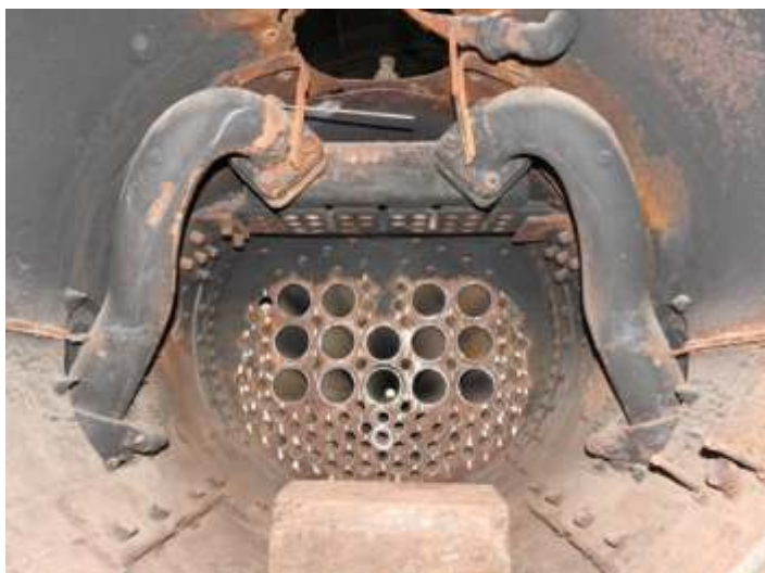
◆ Espelho frontal da 401 com os tubos novos de 5" e 2" Foto VAZ.
