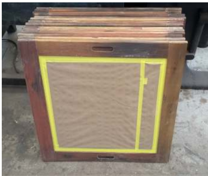
◆ Novas janelas para o carro, sendo preparadas para receber a pintura.
