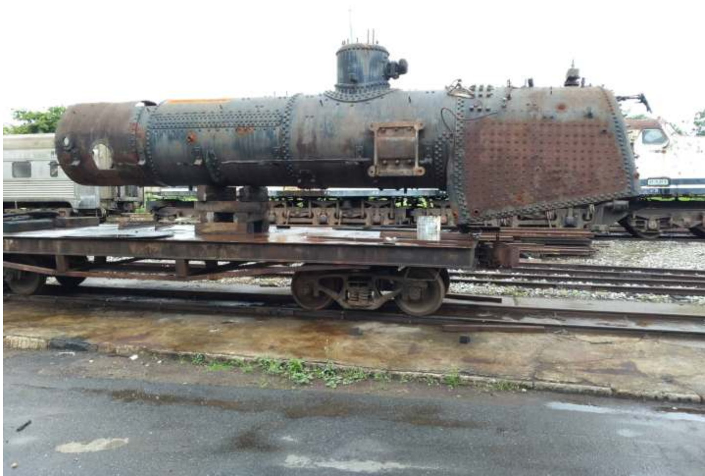
♦ Seguem os trabalhos na locomotiva nº 522 ex. RMV; a caldeira foi removida para realização de trabalhos.
