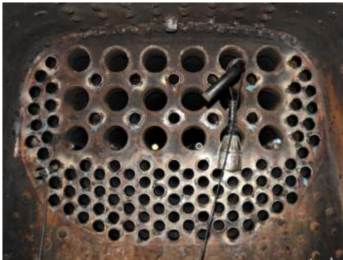
◆ Espelho traseiro da 401 com nova tubulação no lugar- Foto VAZ.
