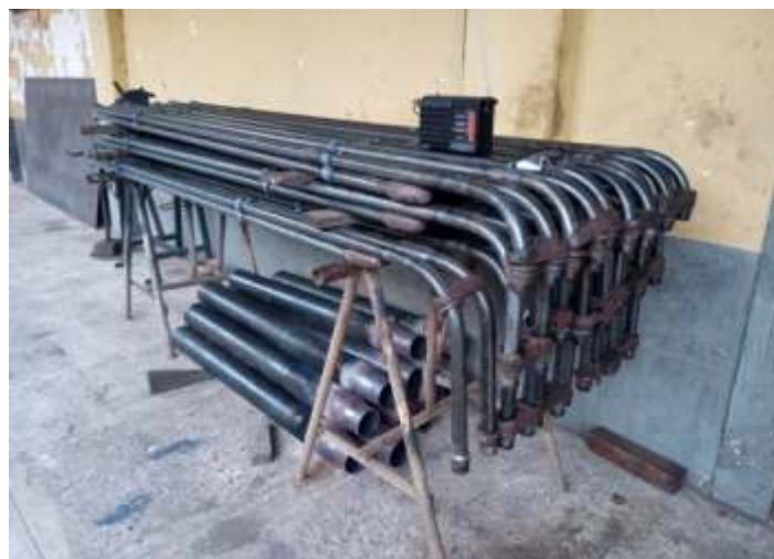
◆ Conjunto de serpentinas prontas para a 338 – Foto HGF.
