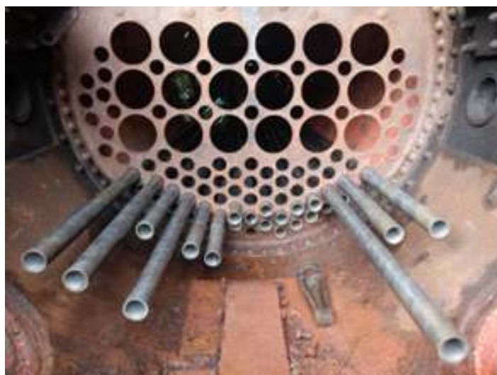
♦ Troca das serpentinas do superaquecedor de vapor da locomotiva articulada Mallet nº 204.
