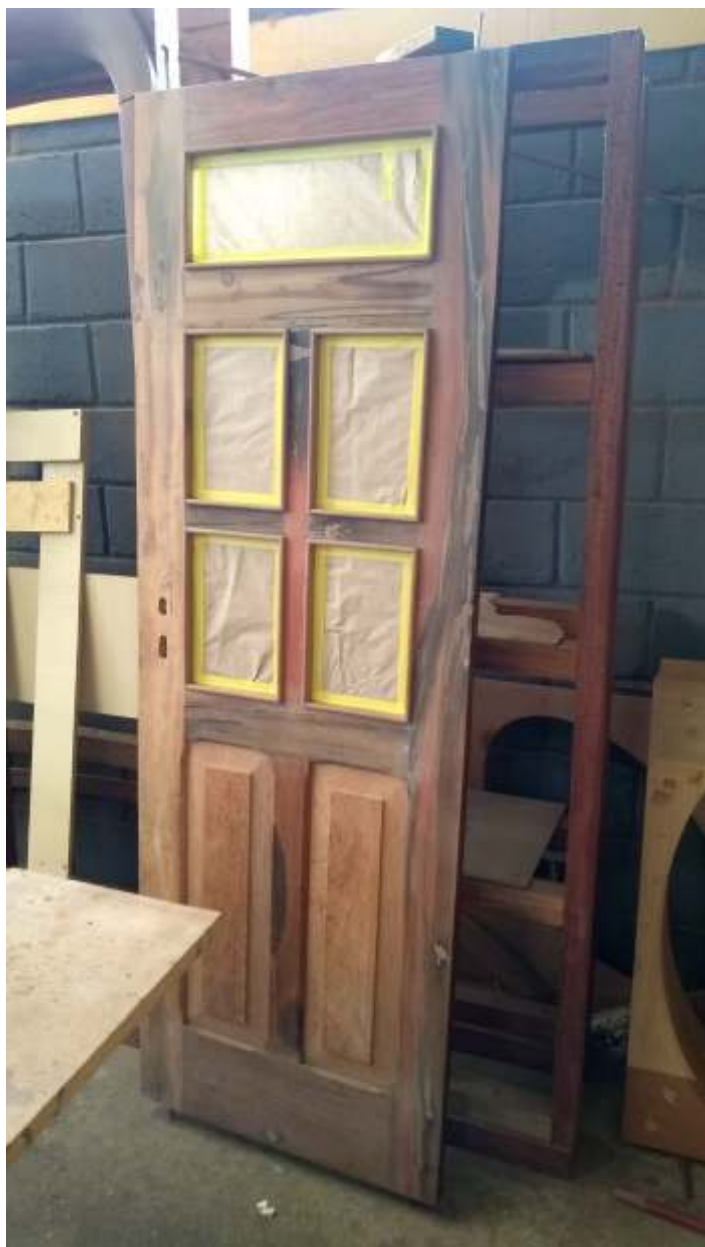
◆ Novas portas para o carro, sendo preparadas para receber a pintura.
