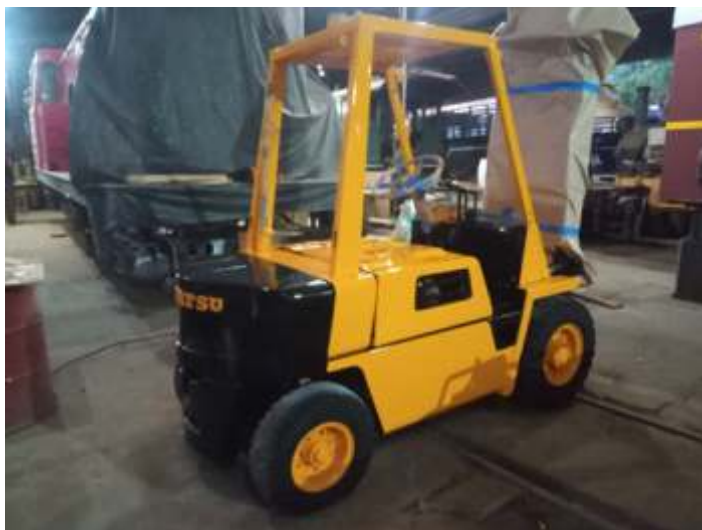
◆ Empilhadeira Komatsu após pintura, ainda falta adesivar – Foto HGF.
