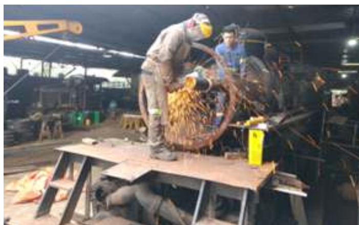
♦ Instalação dos novos tubos da caldeira da locomotiva articulada Mallet nº. 204.
