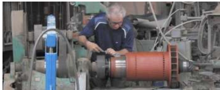
◆ Rotor do motor de tração sendo trabalhado no torno, por Leonel Martins. Foto de V. A. Zago.
