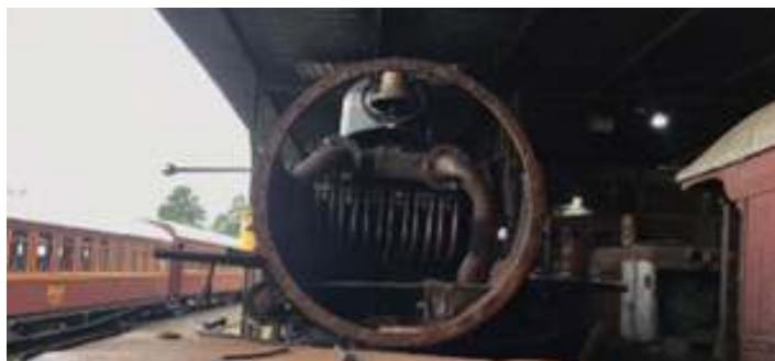
♦ Aspecto da locomotiva durante obras de reforma e reestruturação.
