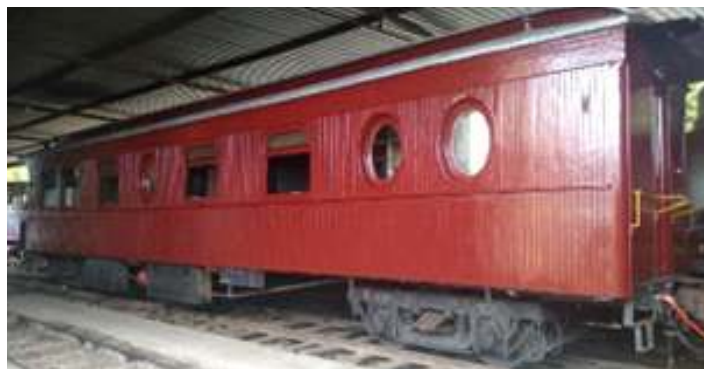
♦ Início do processo de pintura e primeira demão no carro administrativo AM-01
