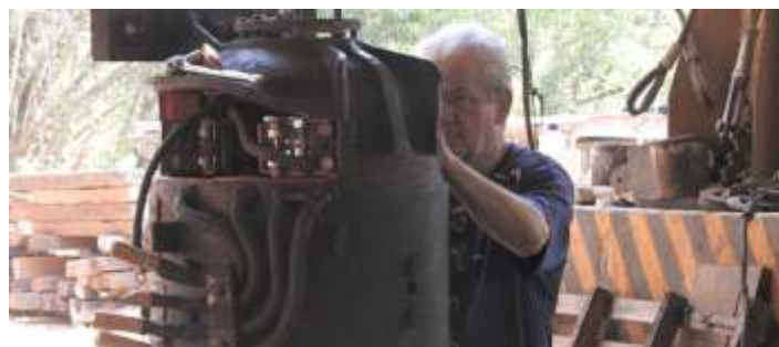
◆ Leonel Martins trabalhando no motor de tração da GE 3104. Foto V.A.Z.
