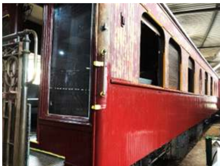
♦ Início do processo de pintura e primeira demão no carro administrativo AM-01
