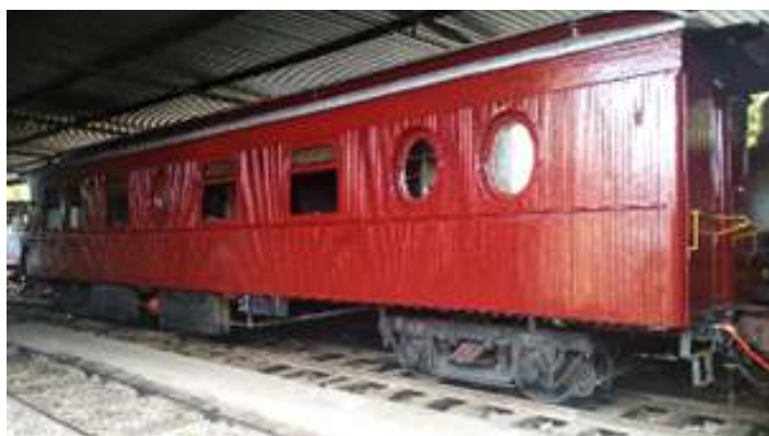
♦ Aspecto do Carro Administrativo AM-01 com parte da pintura já finalizada.
