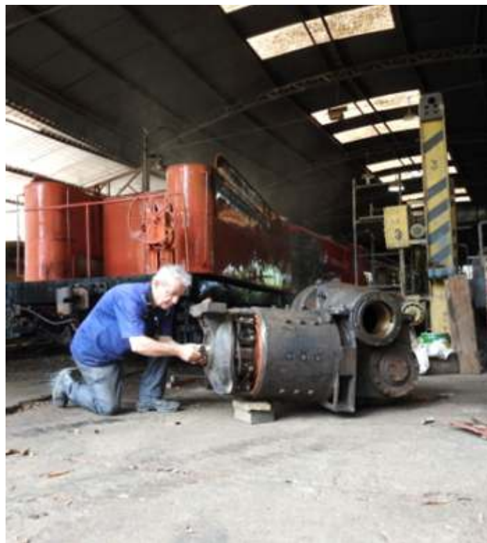
◆ Finalizando o enorme e pesado motor de tração da GE 3104.
