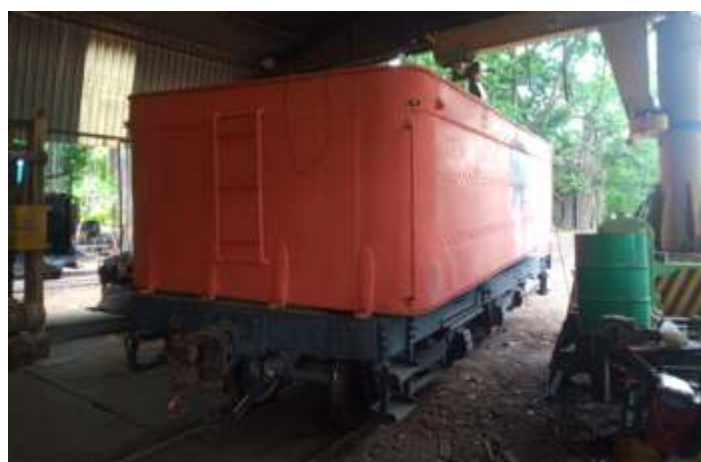
◆ Tender em reparos para a repintura – Foto HGF.
