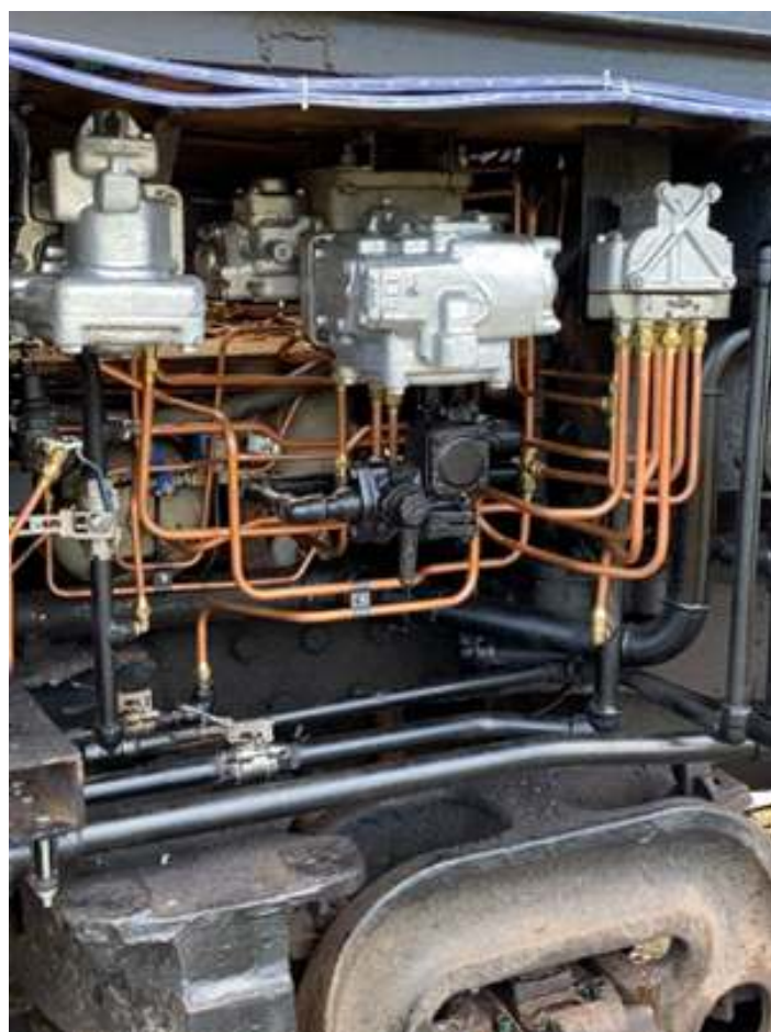
♦ Novo sistema de freios já instalados na locomotiva articulada Mallet nº 204.
