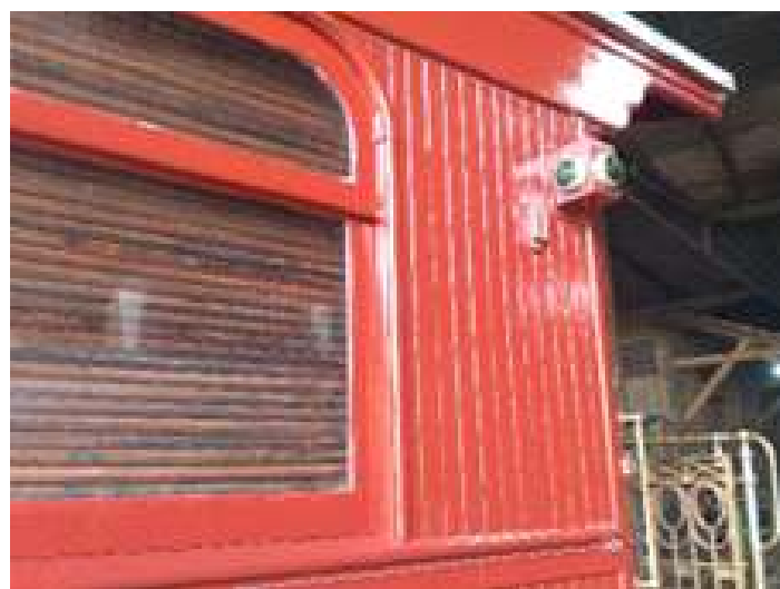
♦ Instalação dos novos faróis de cauda no Carro Administrativo AM-01.
