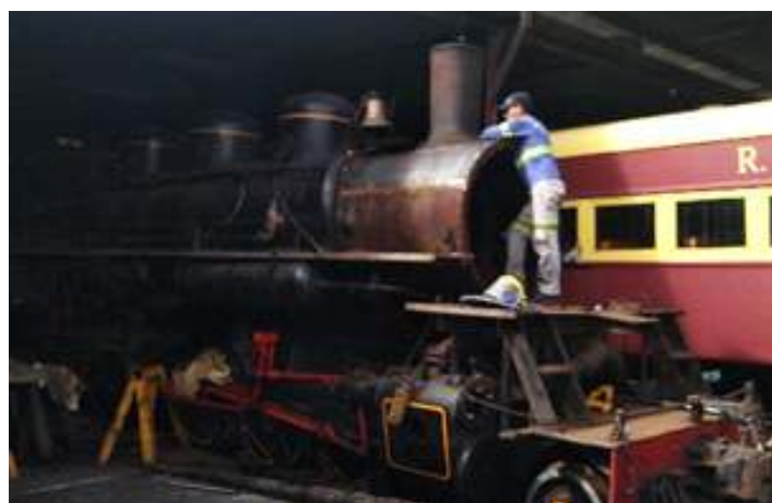
♦ Reconstrução da caixa de fumaça da locomotiva articulada Mallet nº. 204.
