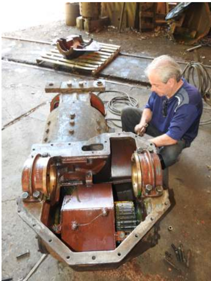
◆ Leonel Martins finalizando reparos no motor de tração da GE 3104.
