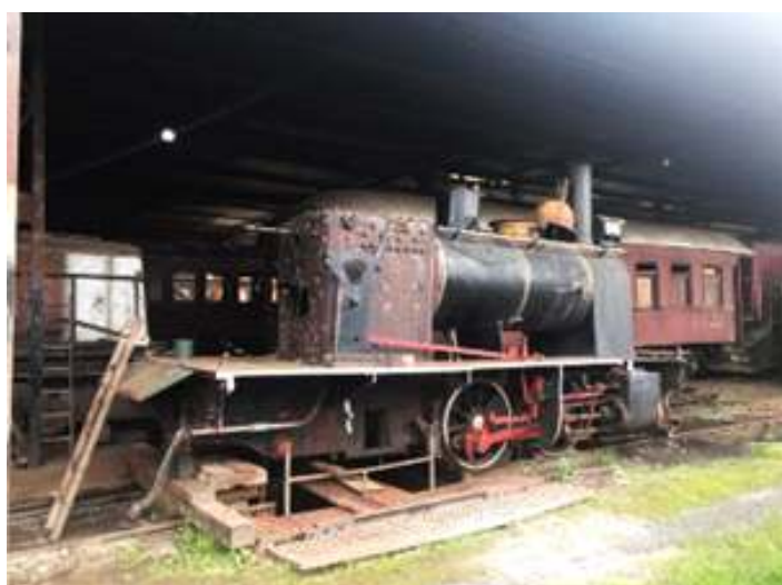
♦ Aspecto da locomotiva manobreira nº. 102 após a remoção da cabine.
