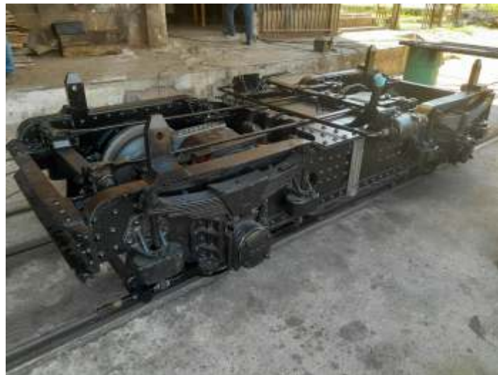
♦ Truque já remontado após revisão e já com nova pintura.
