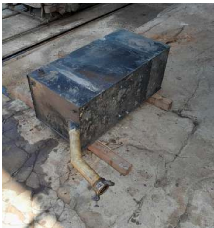
♦ O tanque de combustível removido para passar por limpeza e revisão.
