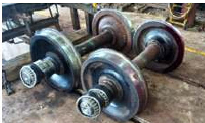
♦ Inspeção de rodeiros com líquido penetrante e lubrificação dos rolamentos.
