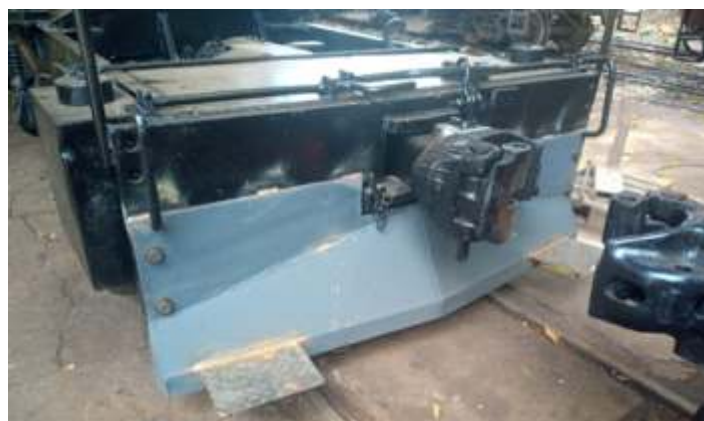
♦ Limpa trilhos já instalado. – Foto de H.G.F.
