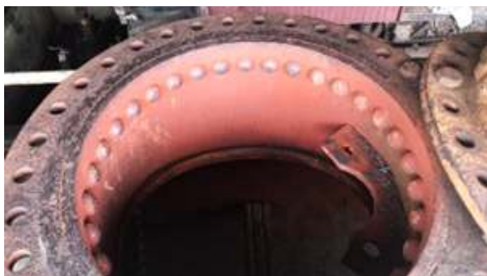
◆ Desmontagem do domo de vapor da locomotiva nº. 102.
