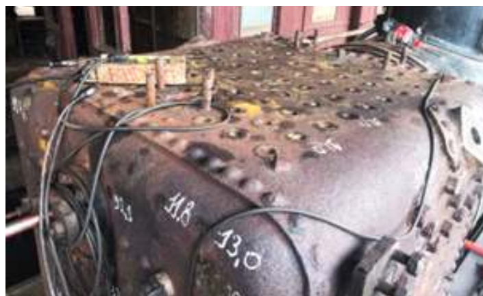
◆ Remoção dos estais da locomotiva manobreira nº. 102. Detalhe para a cabine já removida.
