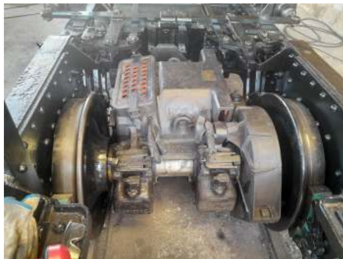
♦ Truque já remontado após revisão e já com nova pintura.
