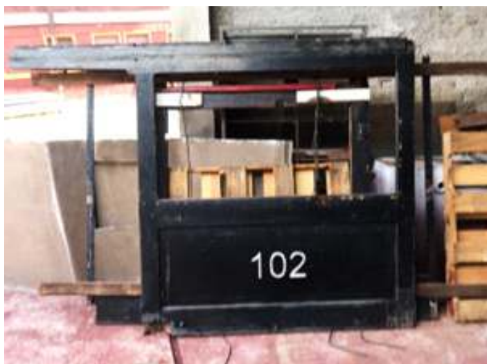
♦ Cabine da locomotiva nº. 102 já desmontada para ser utilizada como matriz para a nova estrutura em madeira.
