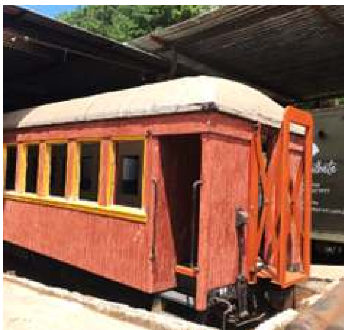
♦ Sanfonas de passagem do carro de passageiros PD-42 já instaladas.
