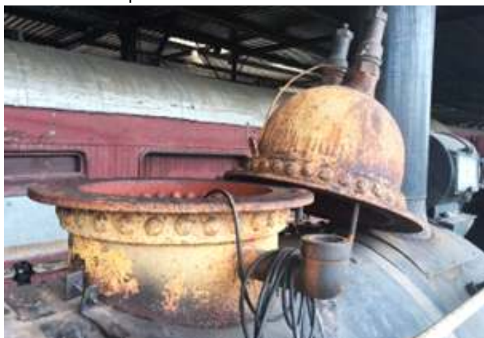
◆ Remoção dos estais da locomotiva manobreira nº. 102. Detalhe para a cabine já removida.
