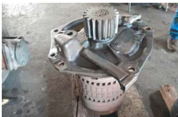
♦ Motor de tração desmontado para revisão.
