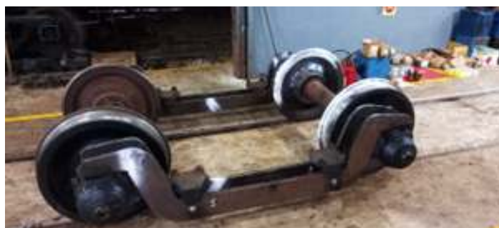
♦ Etapa de desmontagem do truque e início da inspeção com líquido penetrante.
