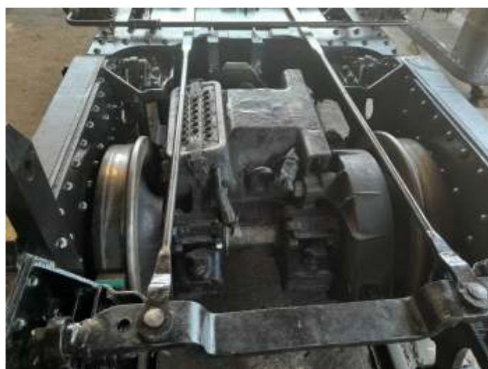
♦ Motores de tração já colocados no truque após revisão.
