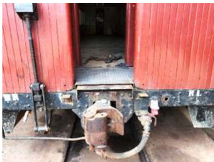
♦ Plataforma no vestibulo do carro PD-42 já reconstruída.
