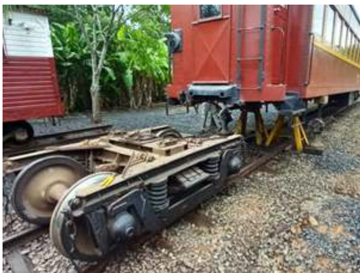
♦ Etapa de desmontagem do truque e início da inspeção com líquido penetrante.
