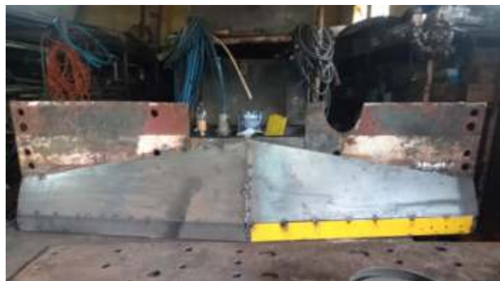
♦ Reforma do limpa trilho da 3104. Foto H.G.F.
