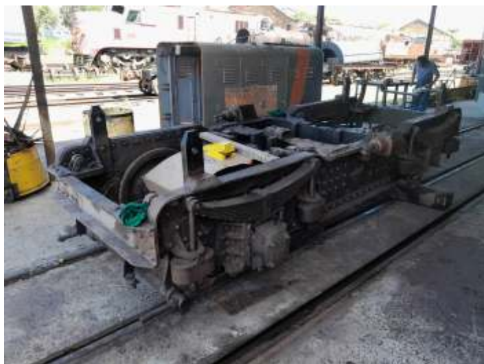
♦ Truque já remontado após revisão e já com nova pintura.
