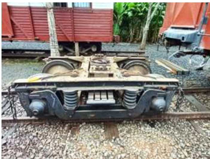
♦ Inspeção de rodeiros com líquido penetrante e lubrificação dos rolamentos.
