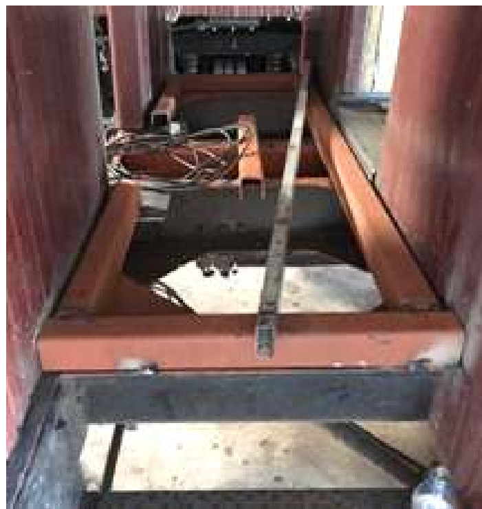
♦ Reconstrução da plataforma nos vestibulos do carro de passageiros PD-42.
