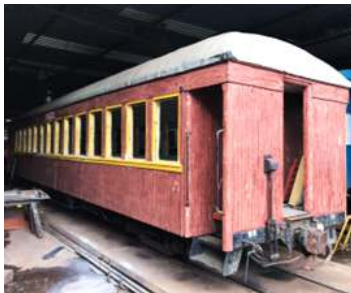
♦ Carro PD-42 já lixado, para receber nova pintura.
