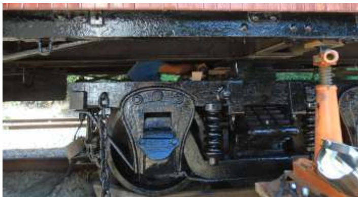
♦ Ajuste de truque do carro SD56. A autoria de Luiz Carlos Henkels.
