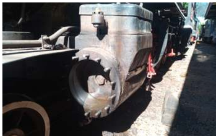
◆ Cilindro da 215 montado com novos anéis. Foto H.G.F..
