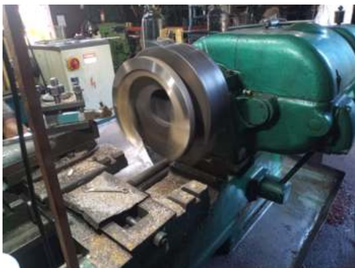
◆ Peça usinada, sendo uma das almofadas em bronze. Foto H.G.F.
