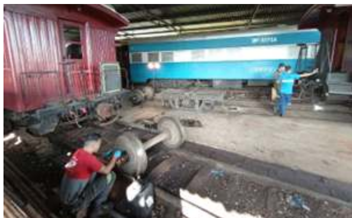
◆ Desmontagem e revisão dos truques de carros de passageiros.
