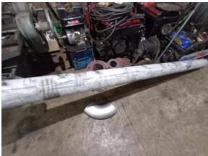
♦ Novo tubo condutor de vapor para a locomotiva Ten-Wheel #311.
