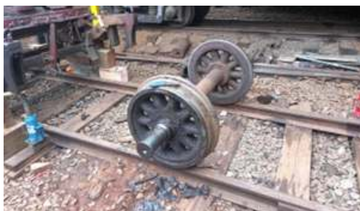
♦ Desmontagem e remoção dos rodeiros do truque do tender da locomotiva Ten-Wheel #311.
