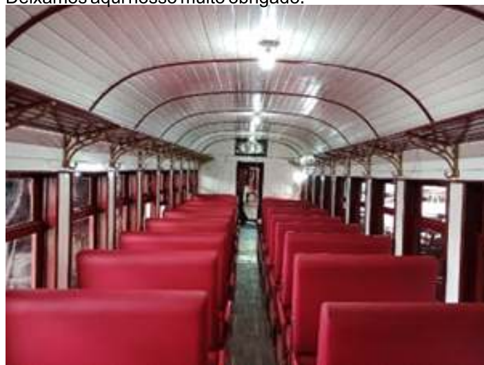
♦ Interior do carro de passageiros PD-42 já com as poltronas instaladas.
