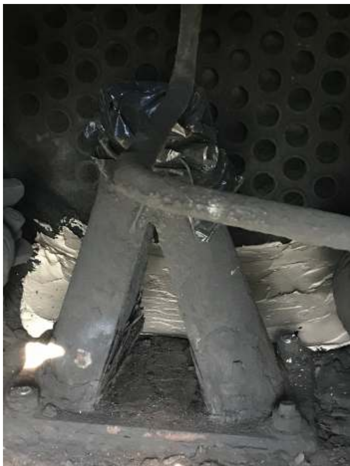
♦ Aplicação da massa refratária no interior da caixa de fumaça da locomotiva nº5.
