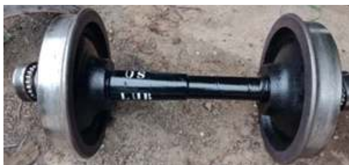
◆ Revisão de rodeiros e lubrificação de rolamentos.
