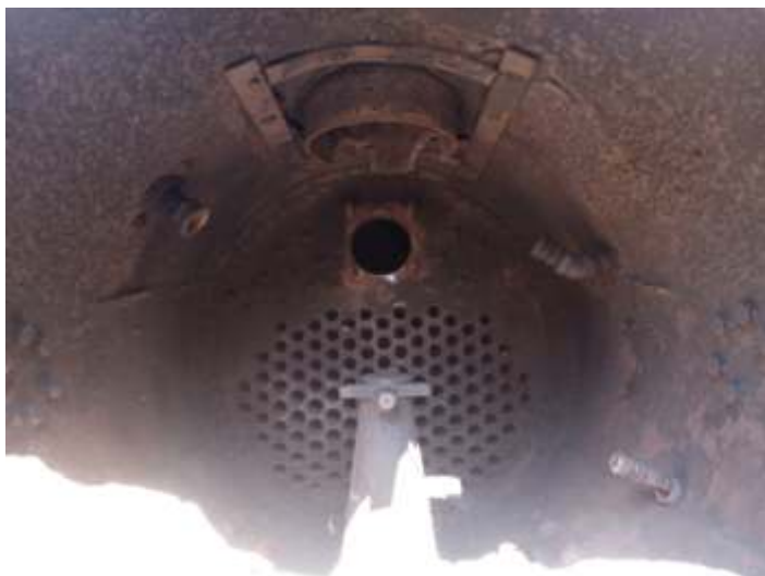
◆ Interior da caixa de fumaça da 215, sem o tubo condutor de vapor. Foto H.G.F.
