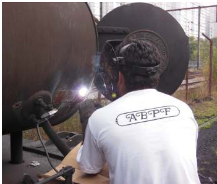
♦ Soldagem de orifício que se abriu na lateral da caixa de fumaça da locomotiva nº5.
