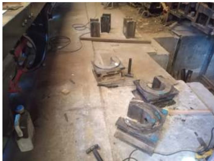
◆ Caixas da 210 sendo separadas para reparação. Foto H.G.F.
