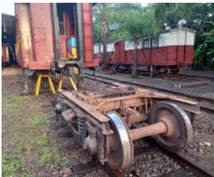
♦ Remoção dos truques do carro de passageiros PC-50.
