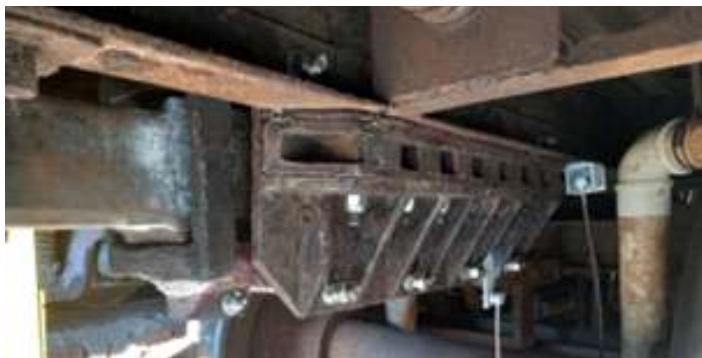
♦ ACT revisado, remontado com parafusos novos.
