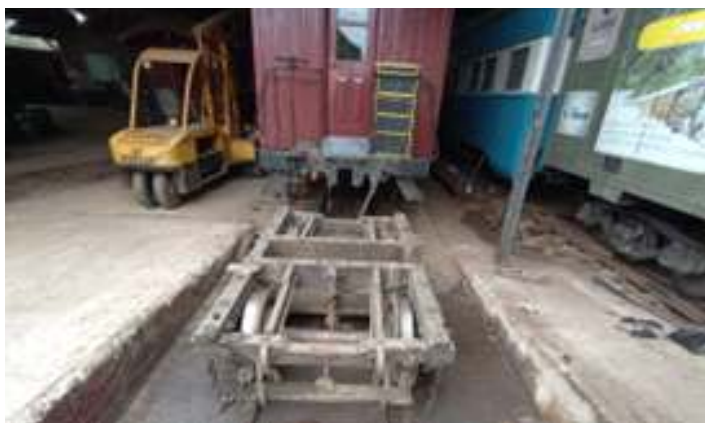
◆ Desmontagem e revisão dos truques de carros de passageiros.
