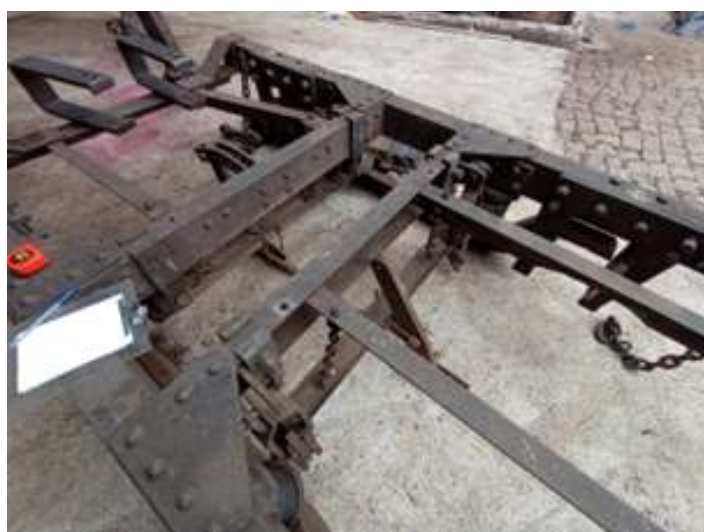
◆ Desmontagem e revisão dos truques de carros de passageiros.
