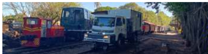
◆ Caminhão rodoferroviário da Brastan passando por Carlos Gomes. Foto Brastan.
