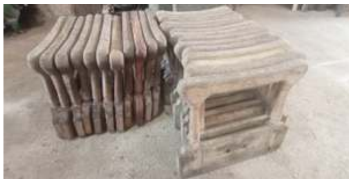
♦ Apoios de braço do carro de passageiros PD-36 já lixados e prontos para pintura.
