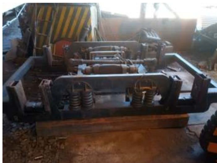
◆ Truque sendo reparado ajustagem da caixa. Foto HGF.
