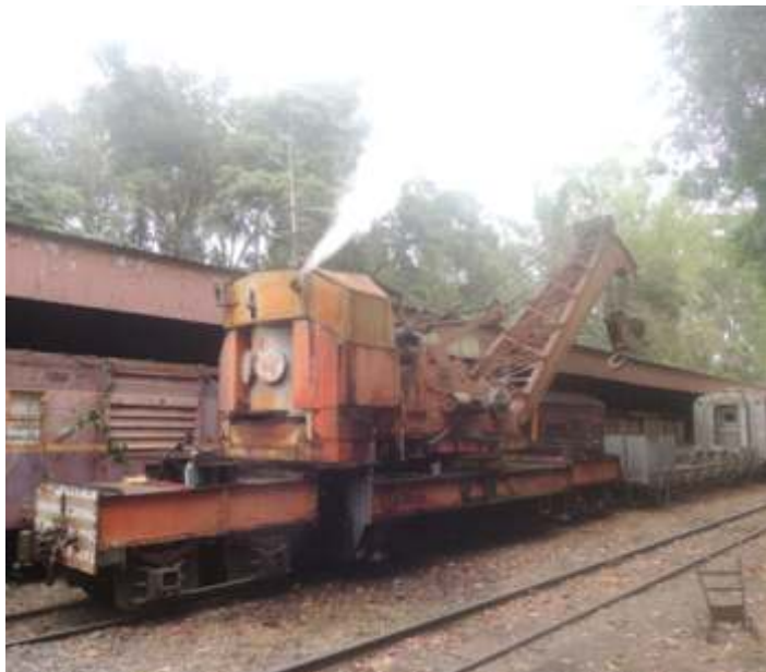
◆ Guindaste a vapor Hansomes da Sorocabana aceso em funcionamento. Foto Zago.
