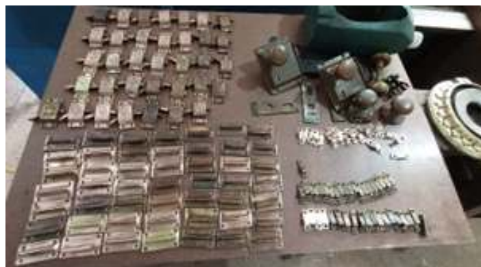
♦ Peças em bronze do carro de passageiros PD-42 já polidas e preparadas para a instalação.
