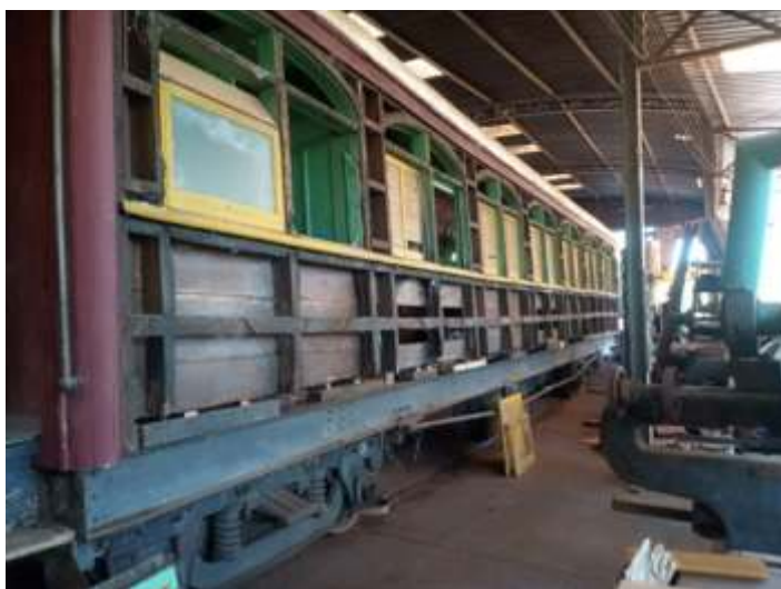
◆ Lateral do carro CA-26 após retirada da longarina podre. Foto H.G.F..
