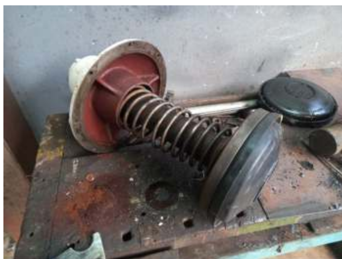
♦ Manutenção do cilindro de freio no vagão VG-42.
