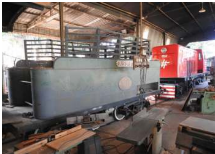
♦ Tender da 401 recolocado sobre o estrado e recolhida as oficinas. Foto de HGF.
