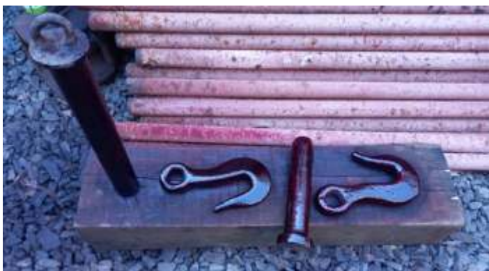
♦ Desmontagem e revisão dos componentes de tração do carro de passageiros PC-58.
