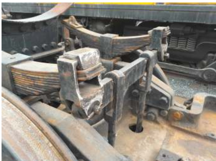
♦ Trabalhos na suspensão da locomotiva 522.
