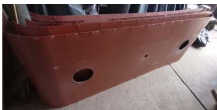
♦ Chaparia interna do teto do carro Administrativo Barão de Mauá, sendo recuperada.
