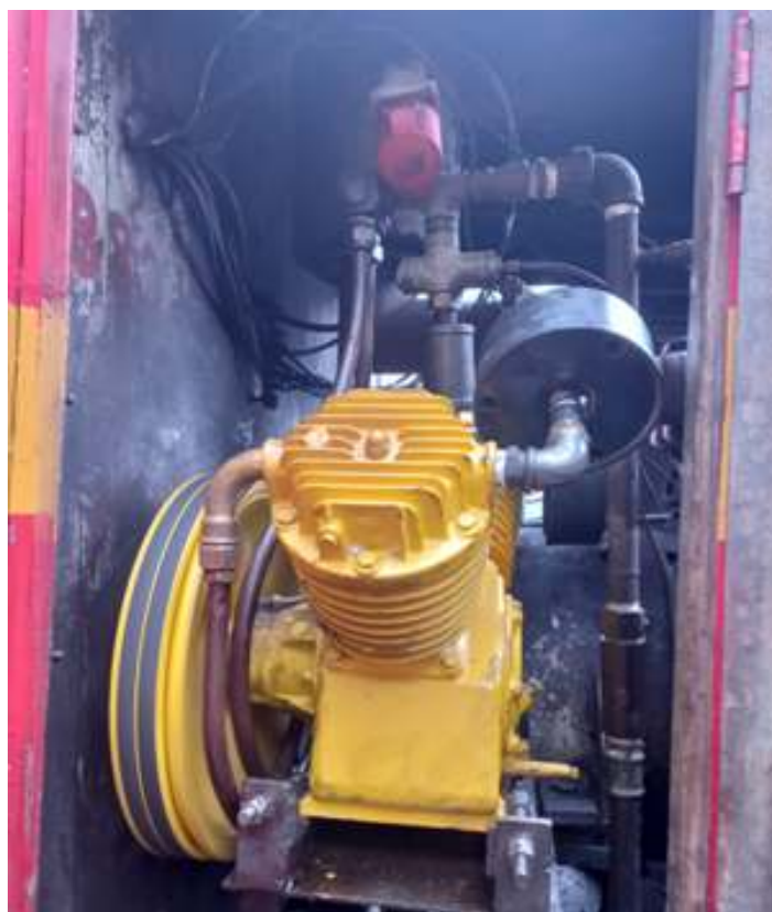
♦ Troca do compressor de ar da locomotiva GE 35t #6.
