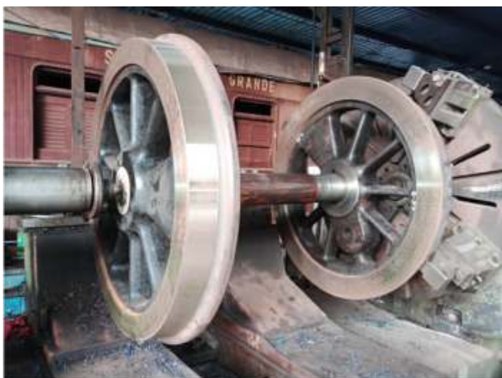
◆ Usinagem dos rodeiros de tração da locomotiva #102.
