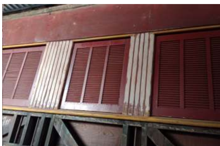
♦ Aspecto da parede lateral do carro administrativo Barão de Mauá, após ser lixado e ter as ripas de acabamento removidas.
