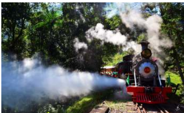
◆ Como não poderia deixar de ser, a locomotiva 232 também deu seu show particular no evento. A purgação da caldeira é um dos eventos mais fotografados pelos visitantes. Autoria de Heinz Beyer.
