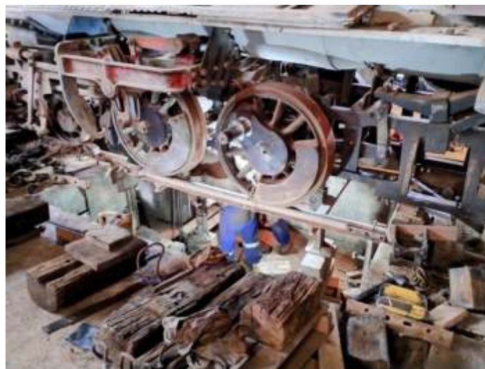
♦ Os rodeiros 1 e 2 da locomotiva 210 já recolocado na locomotiva. Foto Helio Gazetta.
