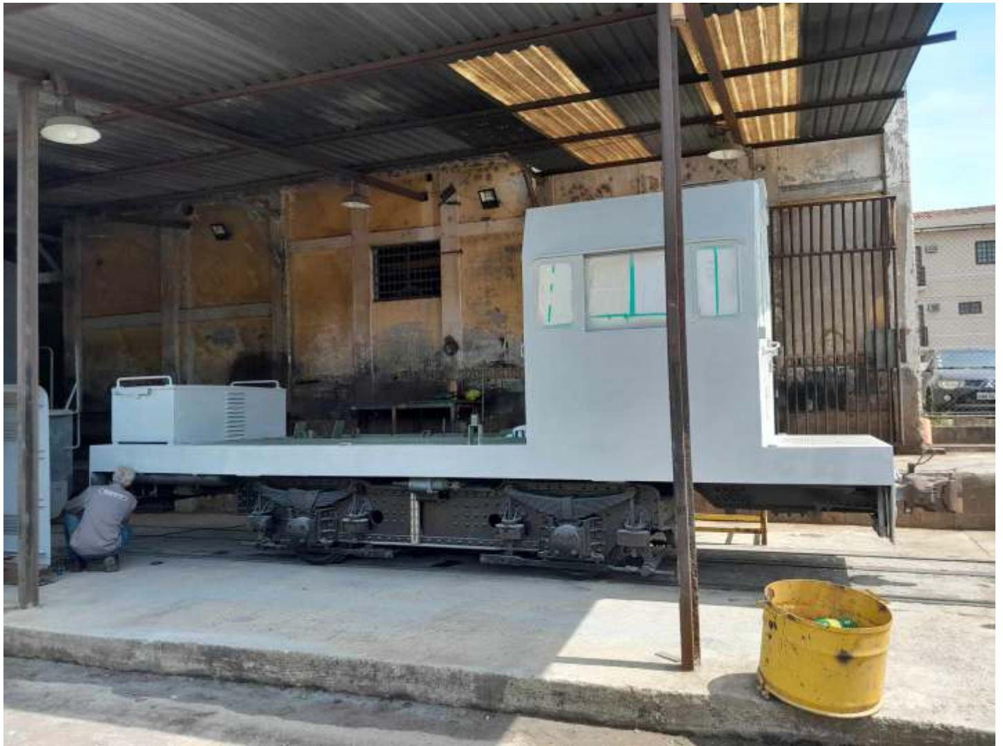
♦ Preparação final da Marcelina nas oficinas de Cruzeiro para receber a nova pintura.
