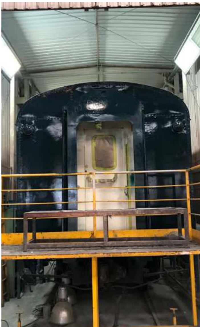
◆ Carro recebendo a nova pintura no padrão da CPEF na estufa das oficinas de Roosevelt da CPTM.
