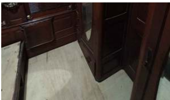
♦ Assoalho do carro administrativo Barão de Mauá já preparado para aplicação de Decorflex.
