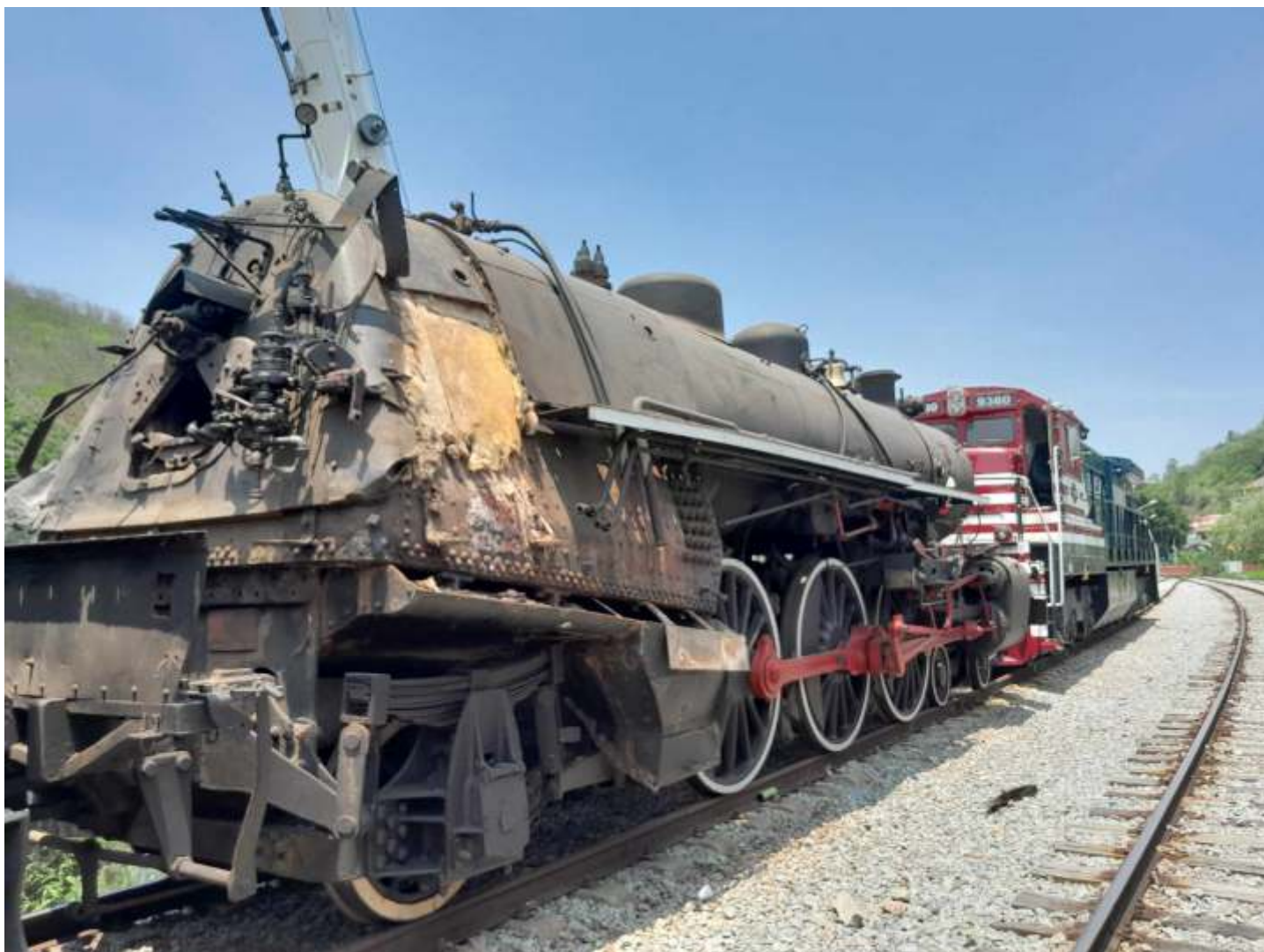
◆ Vista da 353 já com a cabine removida, propiciando uma visão completa da parte posterior da caldeira.
