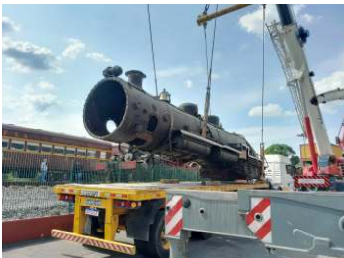
◆ Colocação da caldeira sobre a carreta.
