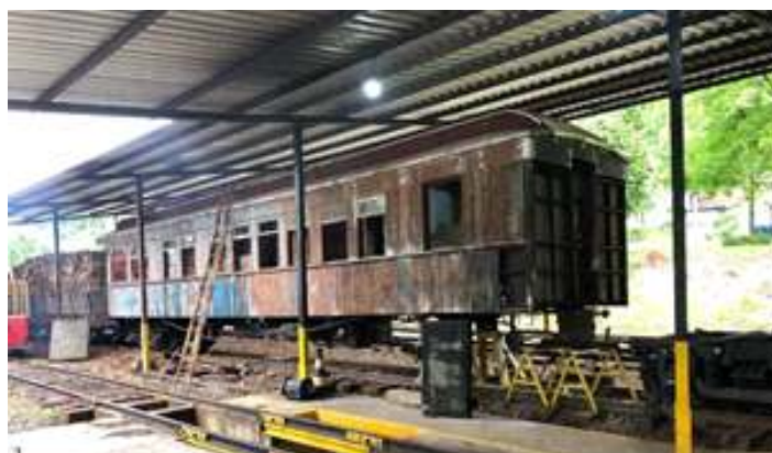
♦ Carro Administrativo AM-04 com exterior já lixado.
