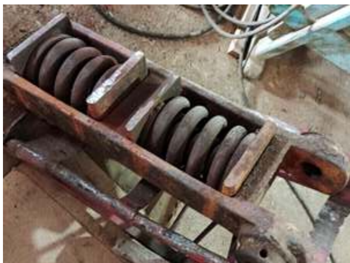
♦ Revisão do Aparelho de Choque de Tração (ACT) do carro administrativo Barão de Mauá.
