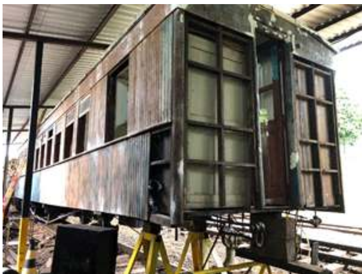
◆ Desmontagem da cabeceira da cozinha do carro AM-04, para remoção e reconstrução do madeiramento comprometido.
