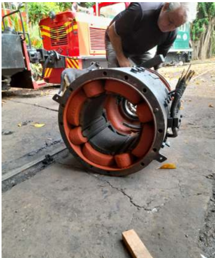
◆ Motor de tração em reparação. Foto Maurício Bimbim.
