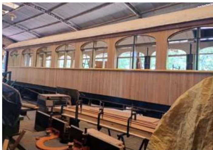
◆ Lateral com a forração concluída. Foto HGF.
