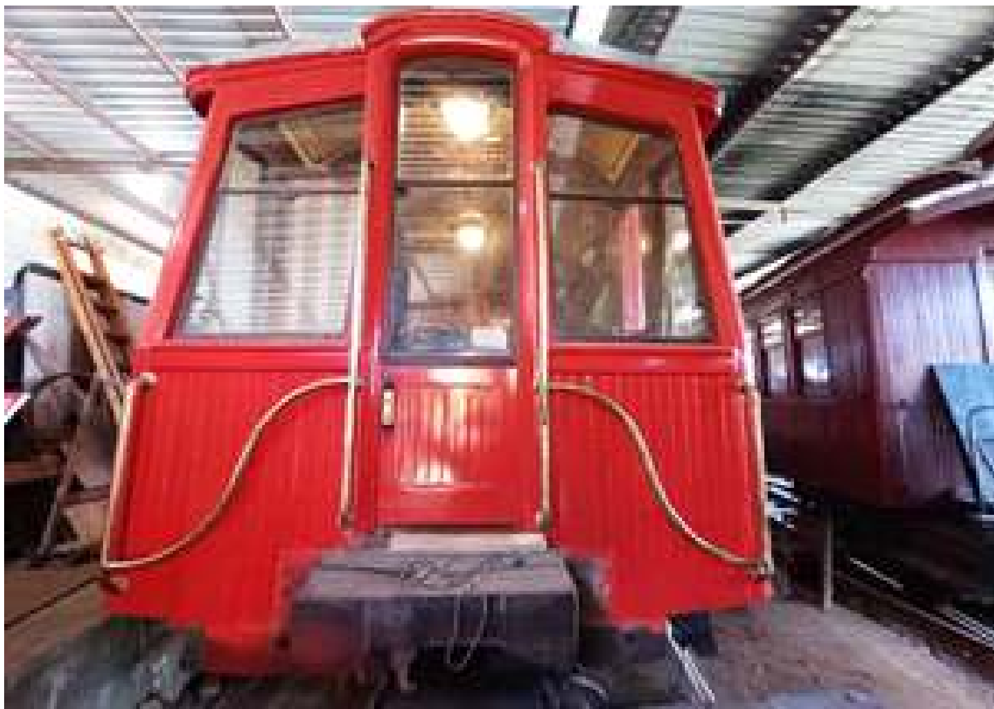
♦ Carro administrativo Barão de Mauá já com os pega-mãos instalados.
