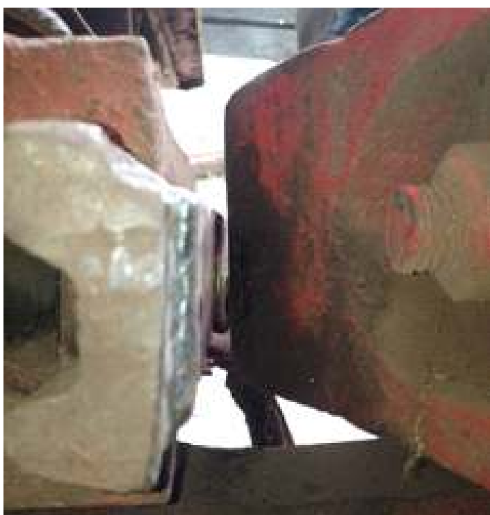
♦ Preenchimento da cunha de distanciamento locomotiva-tender.
