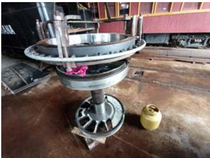
♦ Instalação do aro novo na locomotiva Mikado #761, utilizando-se de Maçarico para aquecimento do material.
