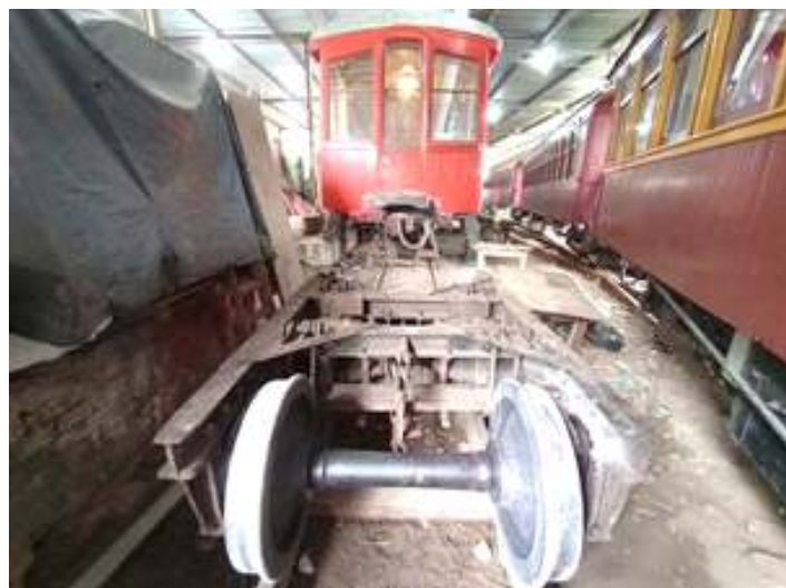
♦ Revisão e instalação dos truques do carro administrativo Barão de Mauá.
