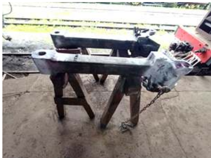
♦ Revisão dos engates fazendo uso de líquido penetrante.
