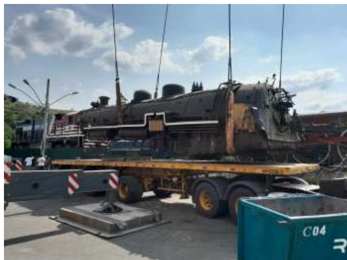
◆ Colocação da caldeira sobre a carreta.
