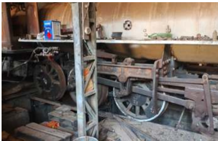
♦ Rodas da 210 já colocadas novamente, Foto HGF.
