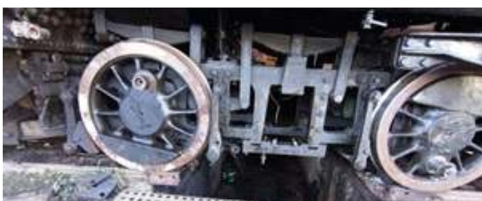
♦ A primeira imagem apresenta os dois rodeiros com aros novos já instalados. Já a segunda imagem apresenta o terceiro rodeiro motriz com o rodeiro retirado, e o quarto ainda por fazer.
