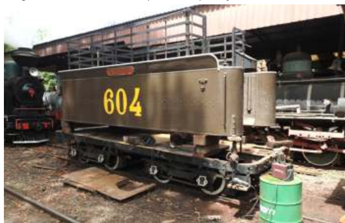
◆ Tender da 604 em reparação de caldeiraria. Foto de V.A.Z..
