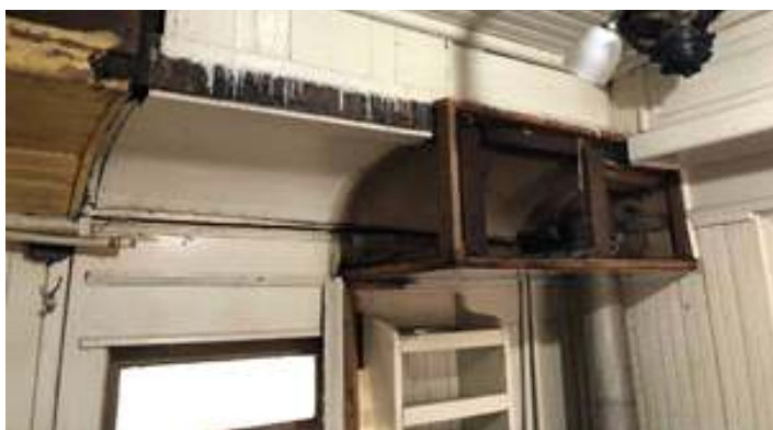
◆ Desmontagem da cabeceira da cozinha do carro AM-04, para remoção e reconstrução do madeiramento comprometido.
