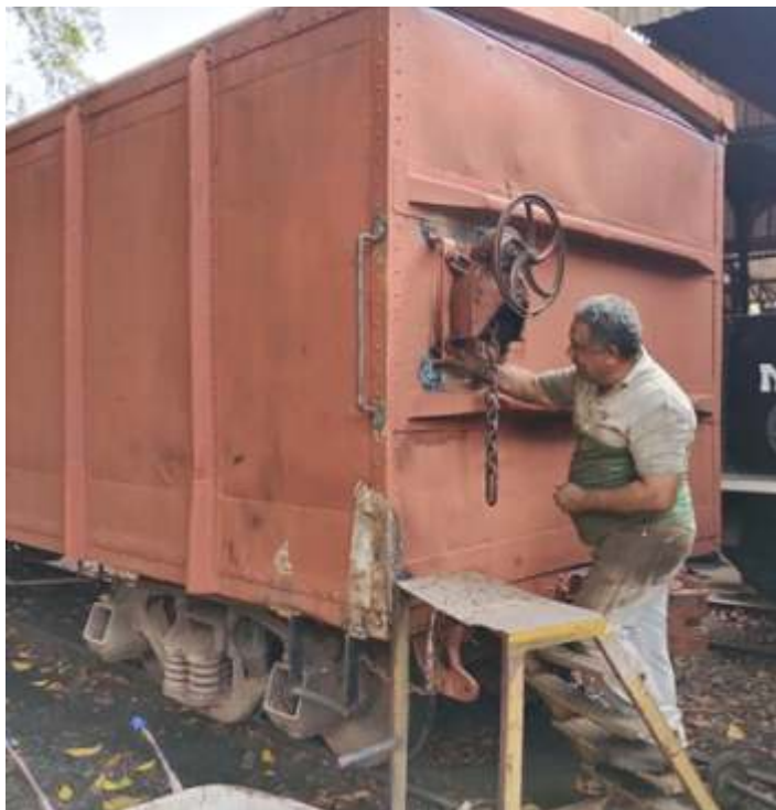
♦ Associado e colaborador Antonio Edson, remontando o sistema de freios e engates de mais um velho vagão da EFS. Foto HGF.
