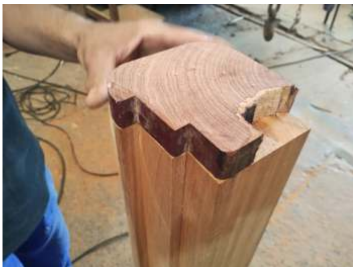
◆ Detalhe da construção de um batente, utilizando a amostra do antigo. Foto HGF.
