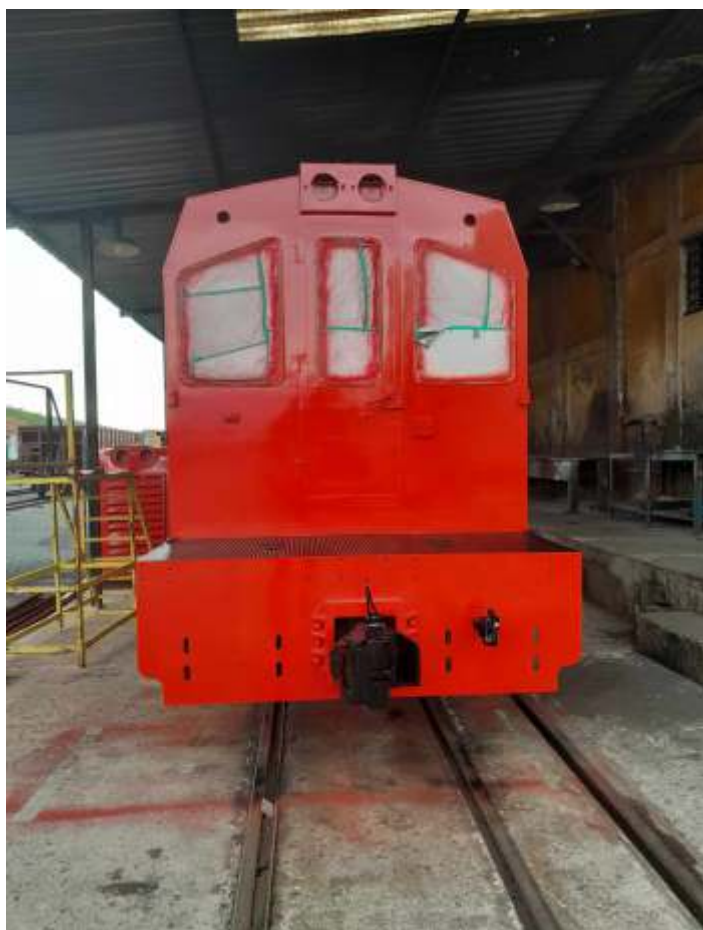
♦ Aplicação das cores básicas já concluída.
