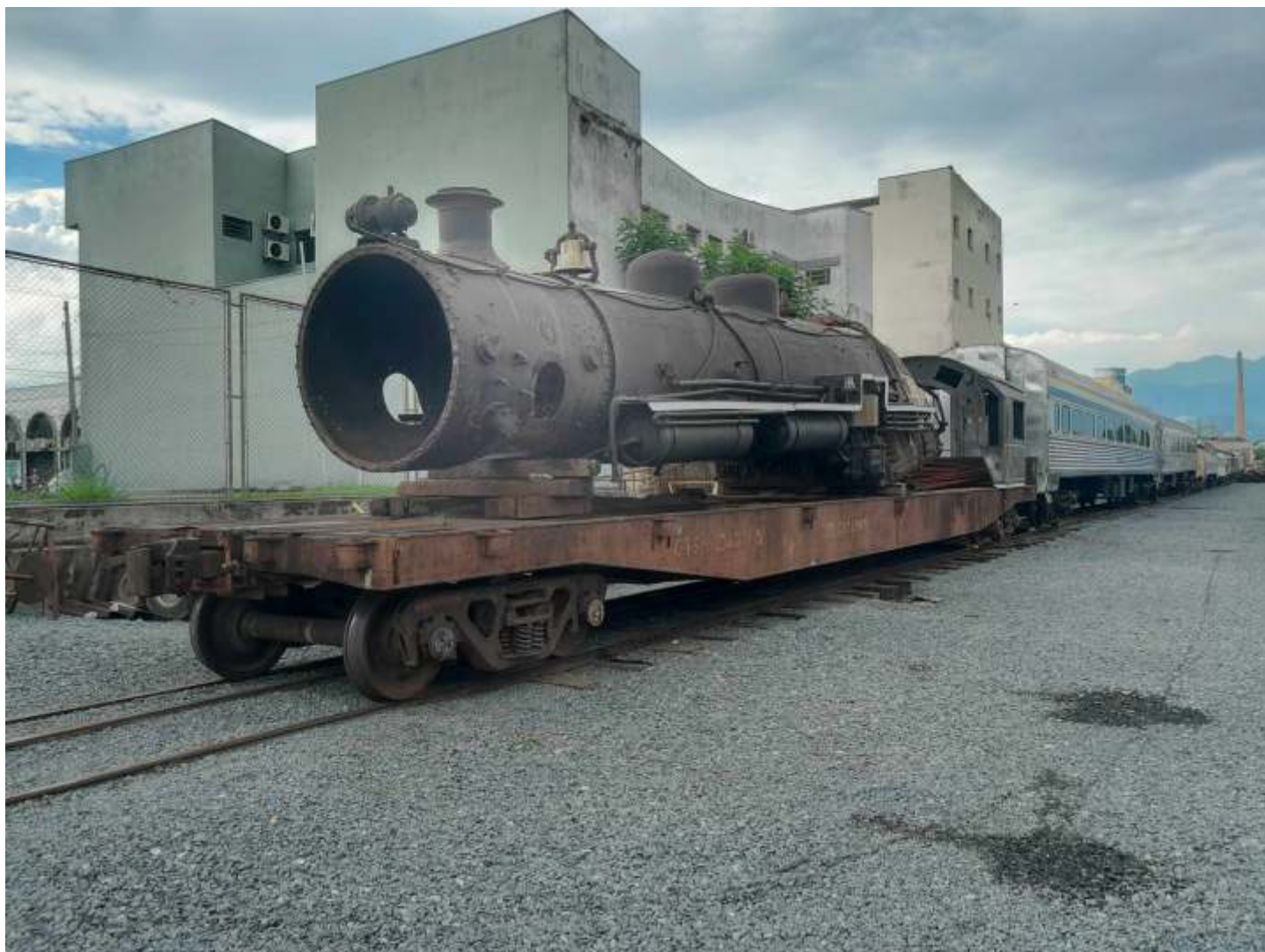
◆ Vista da caldeira da 353 sobre um vagão plataforma nas oficinas de Cruzeiro: os trabalhos já foram iniciados.
