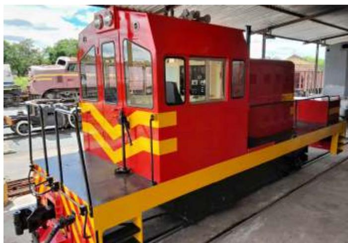
♦ Processo de demarcação e empapelamento da locomotiva para a pintura das faixas no padrão da RFFSA conforme a pintura original que ela recebeu quando fabricada.
