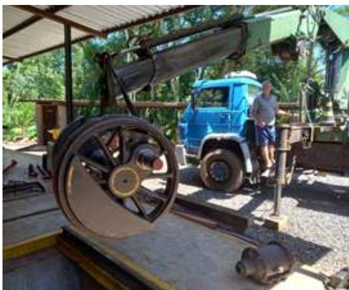
♦ *Retirada e inspeção das rodas da locomotiva Ten-Wheel #311.*
