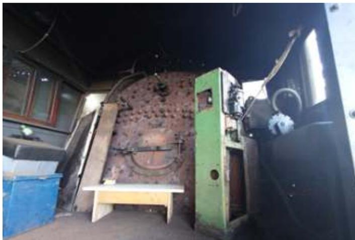
◆ Instalação do novo sistema de freio do tipo 26 SL, na locomotiva Mikado #761.
