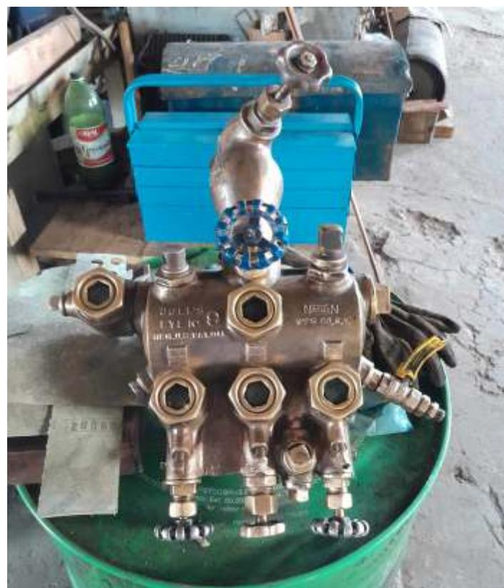
♦ Lubrificador hidrostático da locomotiva #5 já reparado.
