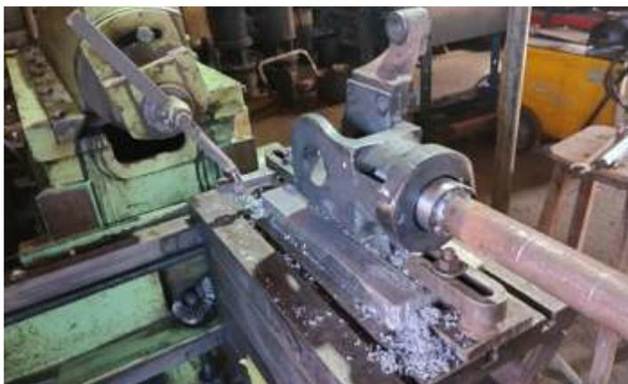
♦ Um dos paralelos da 338 sendo usinado na plaina limadora. Foto HG
