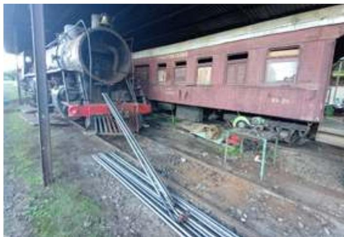
◆ Instalação dos tubos da serpentina do superaquecedor de vapor da locomotiva Mikado #761.
