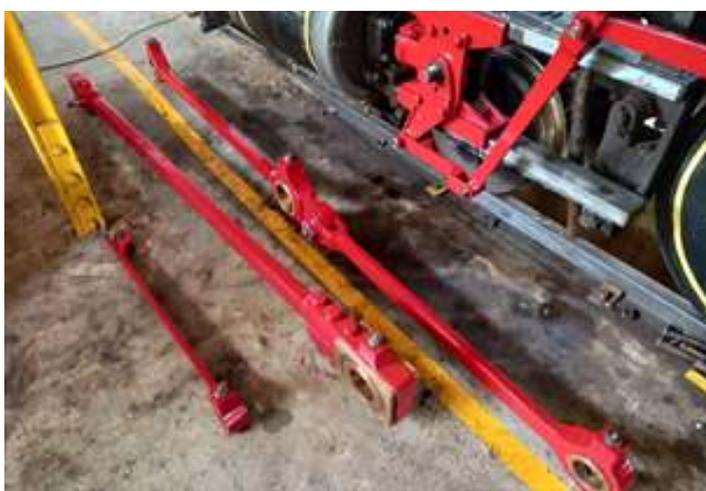
♦ *Desmontagem e inspeção dos mancais das braçagens da locomotiva Ten-Wheel #311.*
