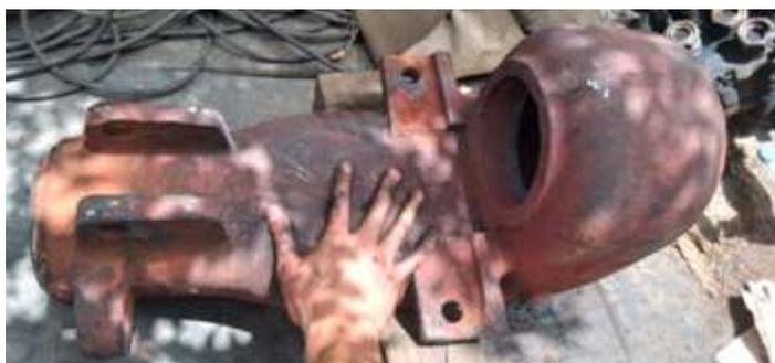
♦ O “caximbo”, peça fundida onde na parte superior está a sede da válvula do regulador de vapor já removida da locomotiva para realização dos ajustes necessários.
