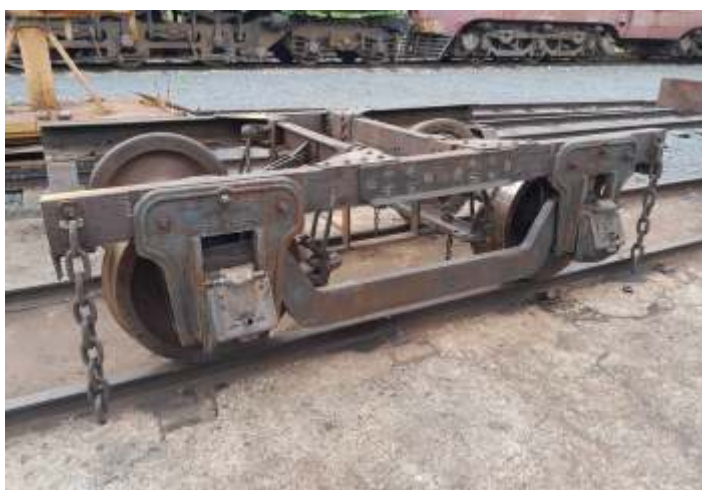
◆ Par de truques de carro de passageiros sendo inteiramente revisados nas oficinas de Cruzeiro/SP.
