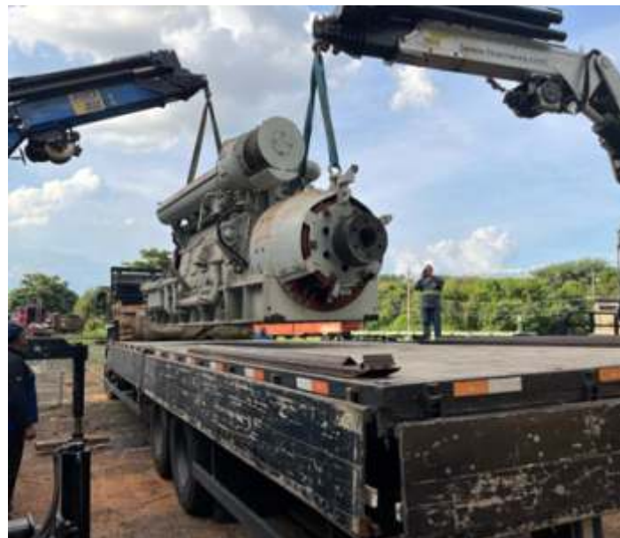
◆ Içamento do motor da GE 3104 para reforma. Foto Eric Gazetta.
