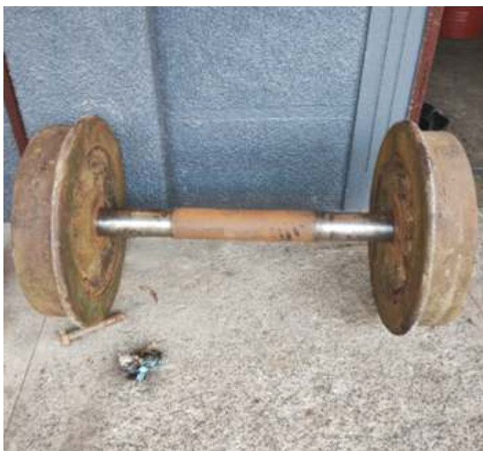
◆ Outro rodeiro sendo preparado para substituição na 338. Foto HGF.
