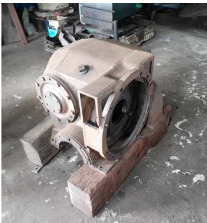
◆ Um dos motores de tração já parcialmente desmontado.
