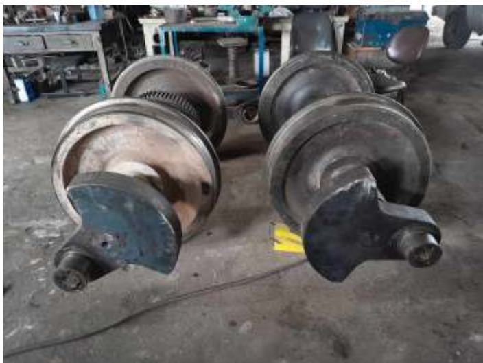
◆ Rodeiros já removidos dos truques aguardando para serem revisados: os mesmos serão torneados.
