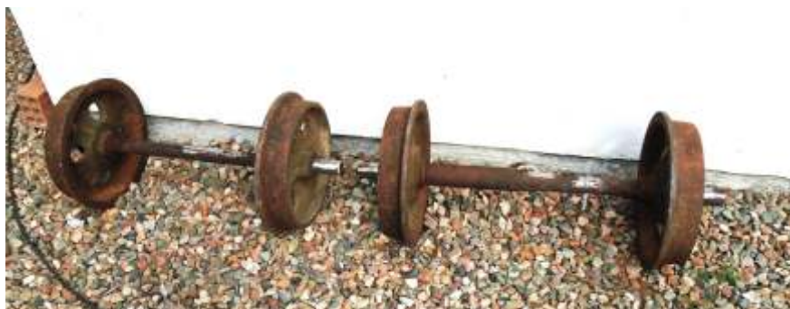
◆ Rodeiros já adaptados, para utilização no vagonete basculante para uso museológico. Autoria de Luiz Carlos Henkels.
