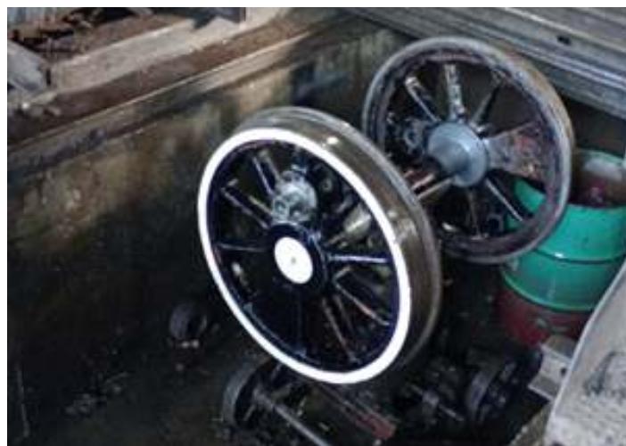
◆ Locomotiva La Meuse #102 parcialmente desmontada já com os rodeiros removidos.
