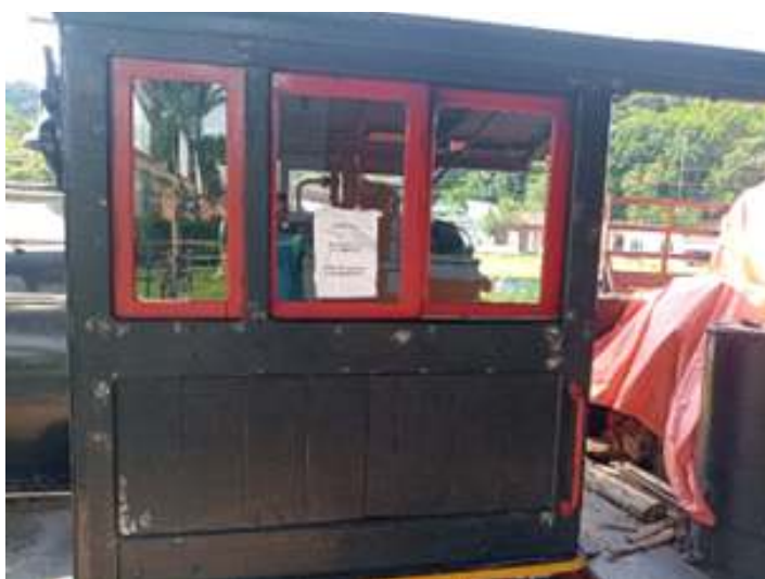
♦ Aplicação de massa plástica em pontos de madeira comprometida.
