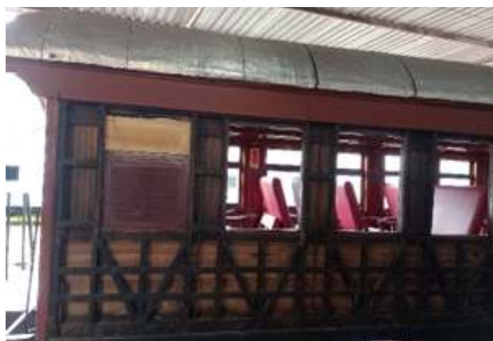
◆ Cobertura com piche e preparo do teto para receber a nova manta asfáltica.
