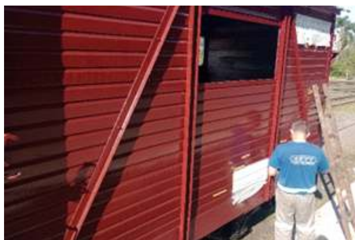
♦ Aplicação das máscaras de informações e escritas, conforme padrões originais.
