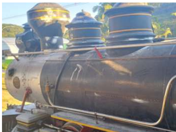
♦ Locomotiva Mogul #11 preparada para nova pintura.
