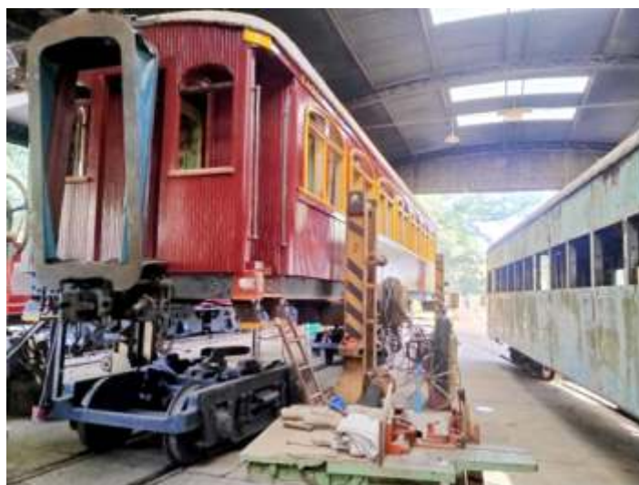
◆ Carro NOB já com os novos truques sendo reposicionado. Foto H.G.F
