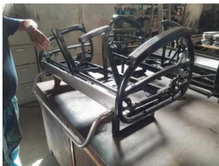
♦ Estruturas dos bancos após os trabalhos de recuperação.
