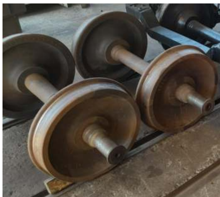
◆ Rodeiros já fora dos truques e limpos, prontos para passarem pela revisão.
