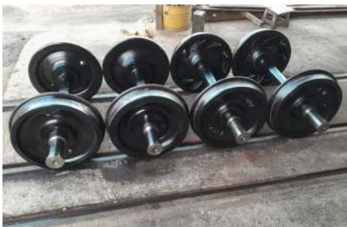
◆ Rodeiros já revisados e pintados prontos para serem instalados nos truques de carros de passageiros.
