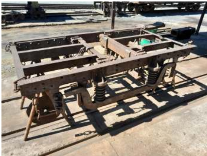
◆ Quadro do truque após demontagem e limpeza.
