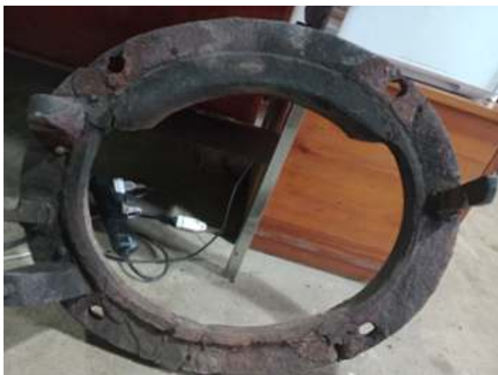
◆ Porta da fornalha da locomotiva Mikado #761 retirada da máquina.
