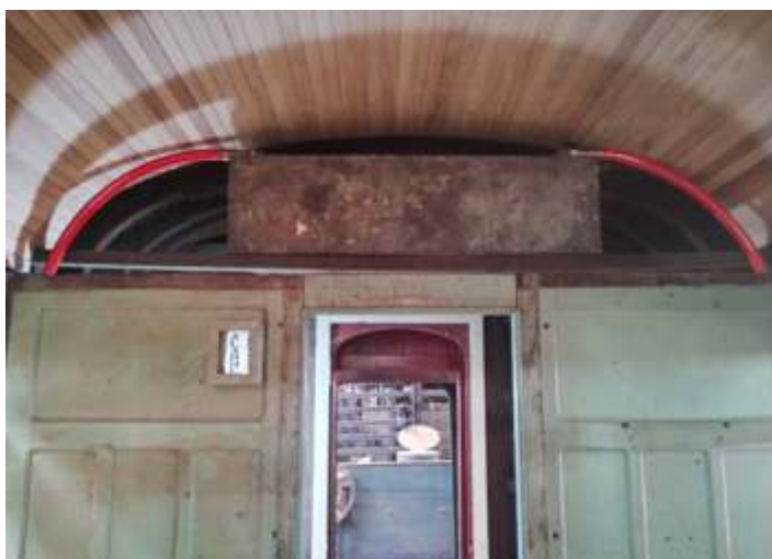
◆ Reinstalação da caixa de água original. Foto de Helio Gazetta.
