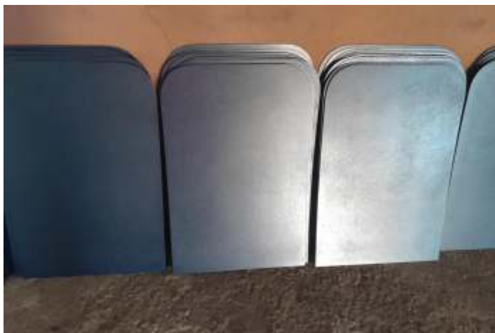
♦ Confecção de novas peças de acabamento para os bancos do carro Pullman PC-3020.
