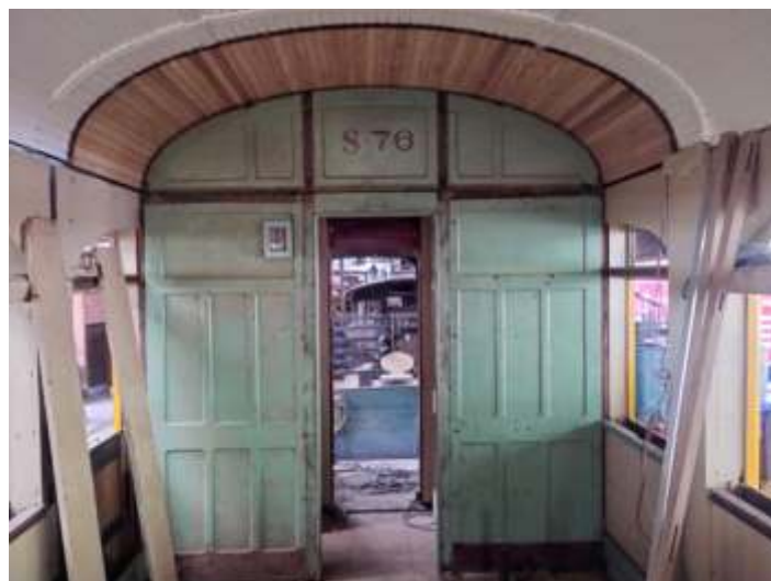
◆ As divisórias originais foram reaproveitadas. Foto Helio Gazetta.
