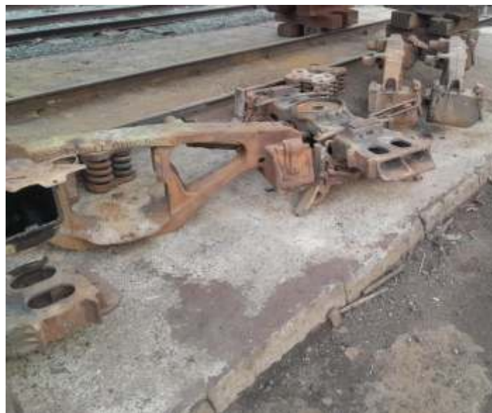
◆ Truque tipo "Ride Control" de vagão de carga desmontado para revisão completa.
