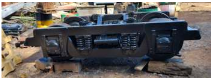
◆ Detalhe do truque em instalação no velho carro NOB. Foto de HGF.
