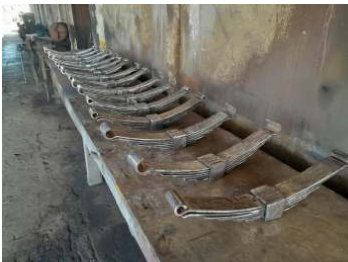
◆ Feixes de molas após desmontagem, limpeza e revisão.
