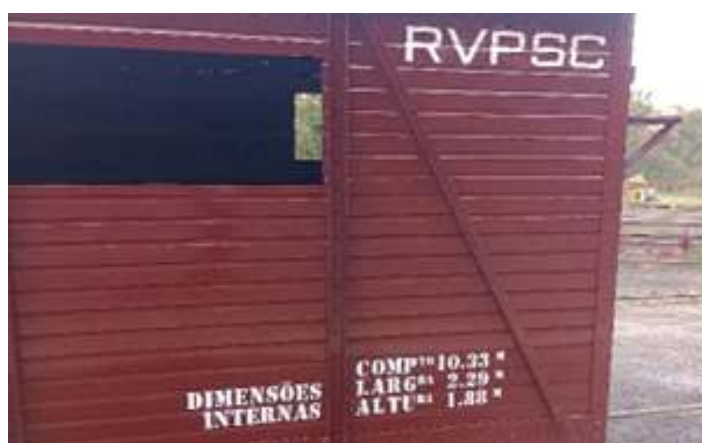
♦ Pintura do vagão VF-127 já finalizada, inclusive com a parte escrita.
