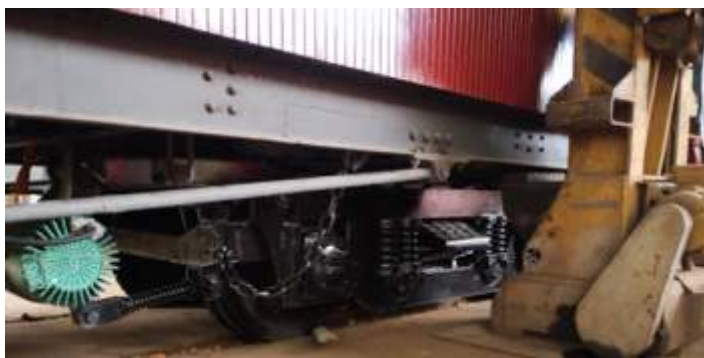
◆ Novo truque adaptado no carro NOB CA-26. Foto HGF.
