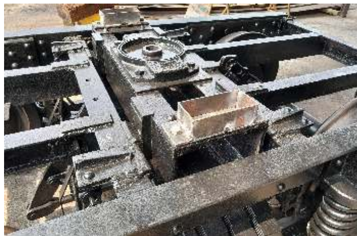
◆ Detalhe dos novos suportes para os ampara-balanços confeccionados nas oficinas.
