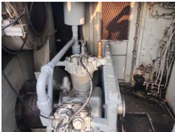
◆ Compressor Wabco 3CDC adaptado na GL-8. Foto HGF.
