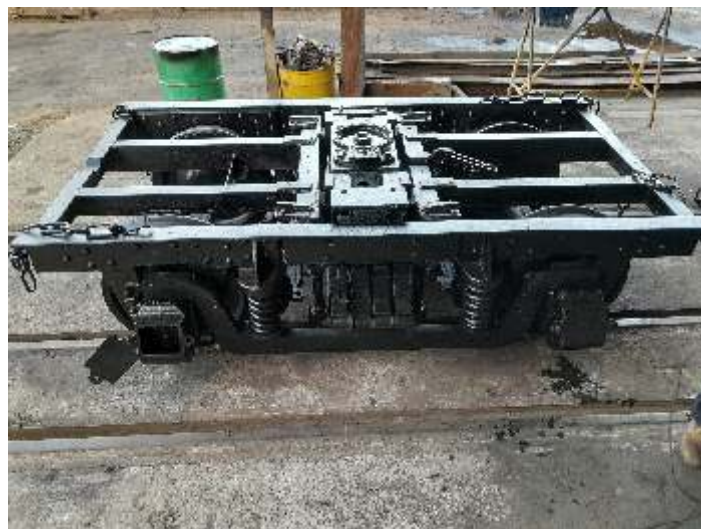
◆ Processo de montagem dos rodéis nos truques.
