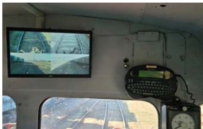
◆ Visualização das 4 câmeras instaladas através de monitor de 19” instalado na cabine.
