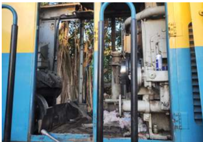
◆ Locomotiva 3 em troca de radiador e compressor de ar. Foto HGF.
