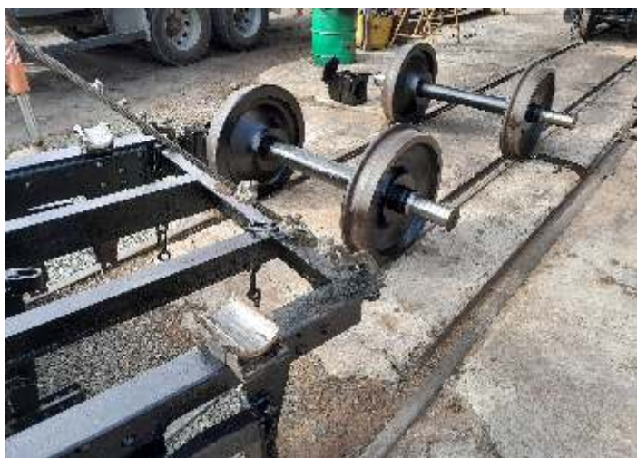
◆ Preparação para montagem dos rodéis no truque já revisado de carro de passageiros.
