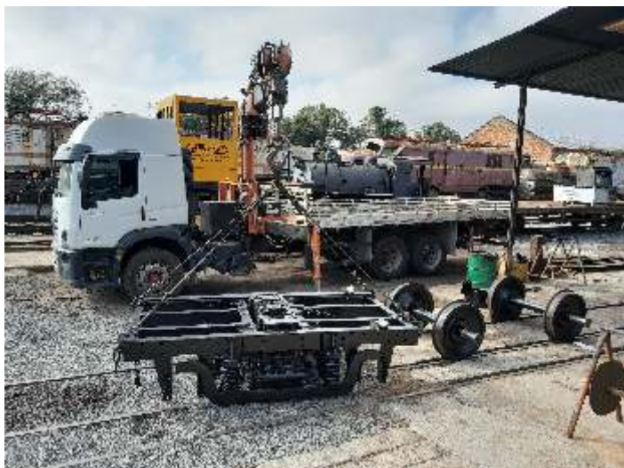
◆ Processo de montagem dos rodéis nos truques.
