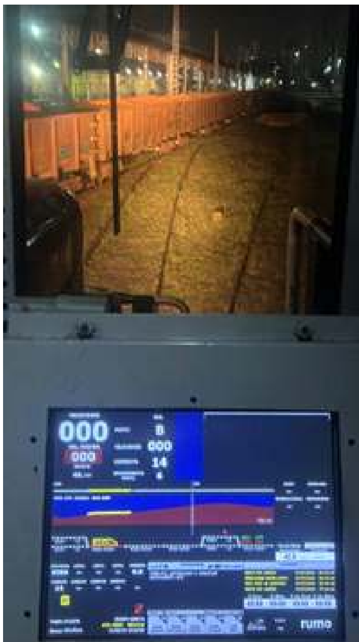
◆ Cabine com o “CBL – Computador de Bordo para Locomotivas” utilizado na malha da Rumo Logística.
