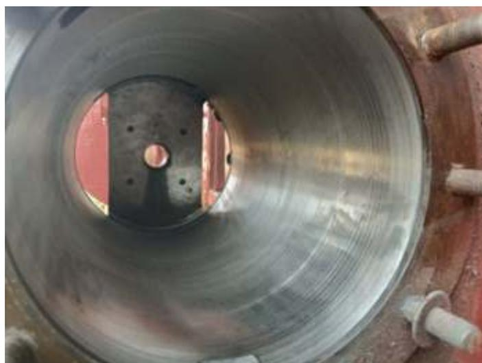
◆ *Aspecto de depois da usinagem do cilindro.*
