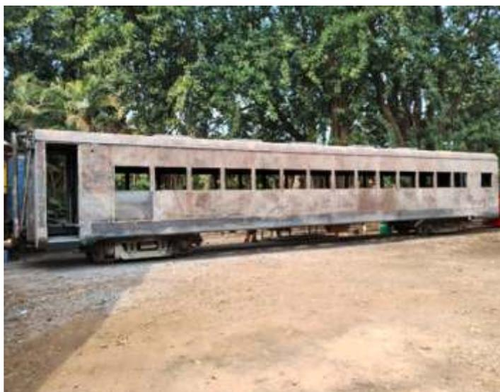
◆ Carro de aço carbono RFFSA após remoção da tinta velha. Foto HGF.
