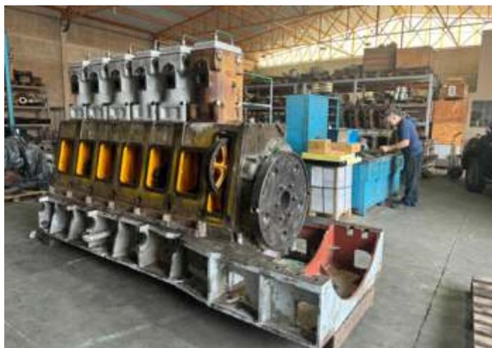
◆ Motor Cooper Bessemer da loc. 3104 em fase final de montagem na SVL em Bauru SP. Foto SVL.
