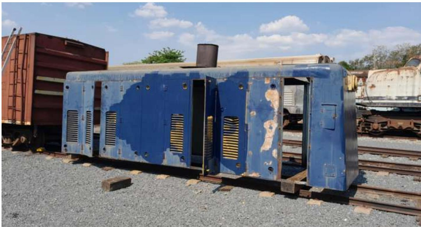
◆ O capô da 3111 após ser removido da locomotiva, já posicionado no pátio para passar por limpeza geral e reparos..
