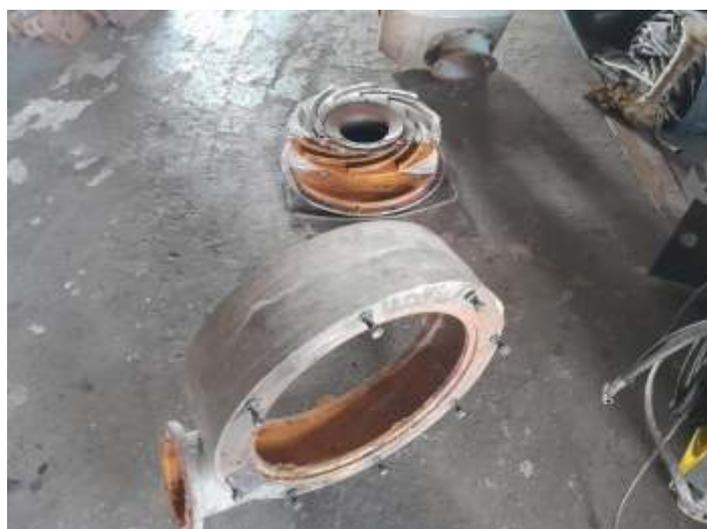
◆ Componentes da 3111 já sendo desmontados para limpeza e revisão completa.
