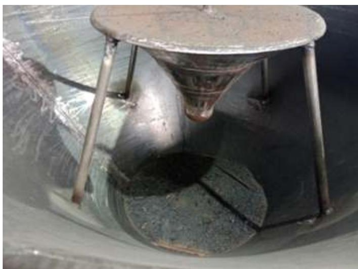
◆ *Instalação do detentor de fagulhas no interior do cone inferior do balão.*
