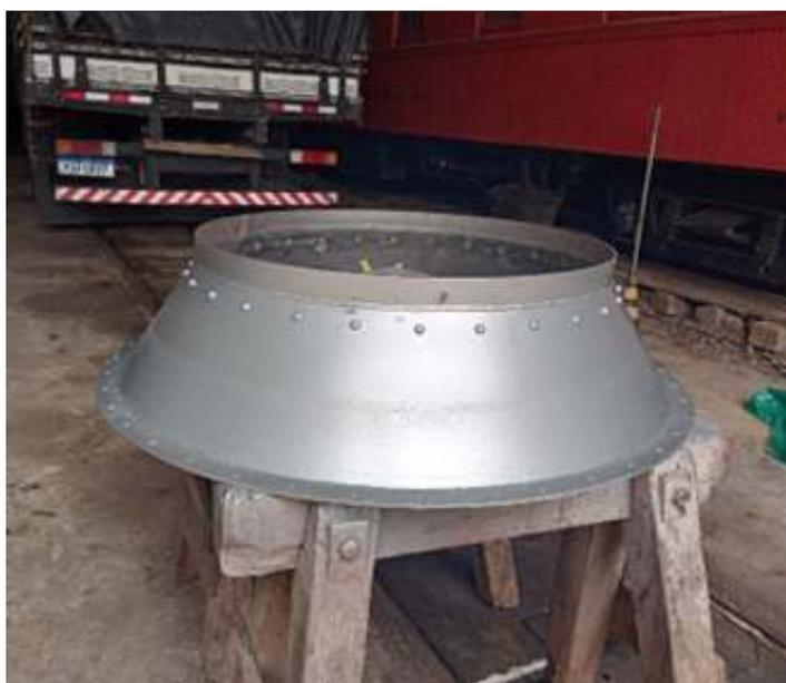
◆ *Peças prontas para pintura com tinta de alta temperatura.*
